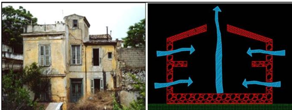
Σχήμα 1.6: Στρατηγικές εξαερισμού: μικρά ανοίγματα στη σοφίτα των κτιρίων (Χαρκιολάκης et al 2008)
