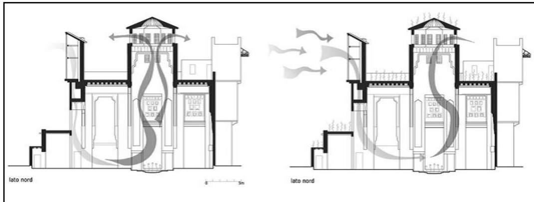
Σχήμα 1.14: Διάγραμμα εξαερισμού (Malqaf) (Ficarelli 2008)
