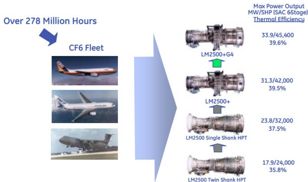
Σχήμα 2.5: Εξέλιξη εκδόσεων Α/Σ LM2500
