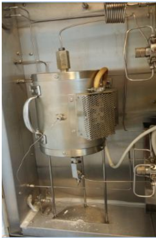
Εικόνα 18: Ο φούρνος μέσα στον οποίο είναι τοποθετημένος ο μικροαντιδραστήρας, Τα θερμοστοιχεία που μετρούν την θερμοκρασία του μικροαντιδραστήρα είναι τοποθετημένα κάθετα και παράλληλα με τον άξονα του φούρνου και αγγίζουν το κέντρο του μικροαντιδραστήρα.
