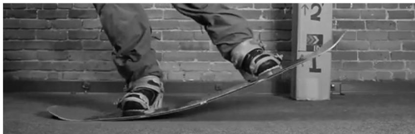
Εικόνα 1.8 Εμπειρική δοκιμή ελαστικότητας σε κάμψη
