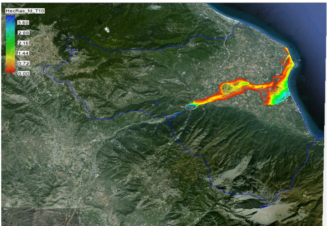
Εικόνα 36: Έκταση και βάθη πλημμύρας για την καταιγίδα σχεδιασμού των 10 ετών
