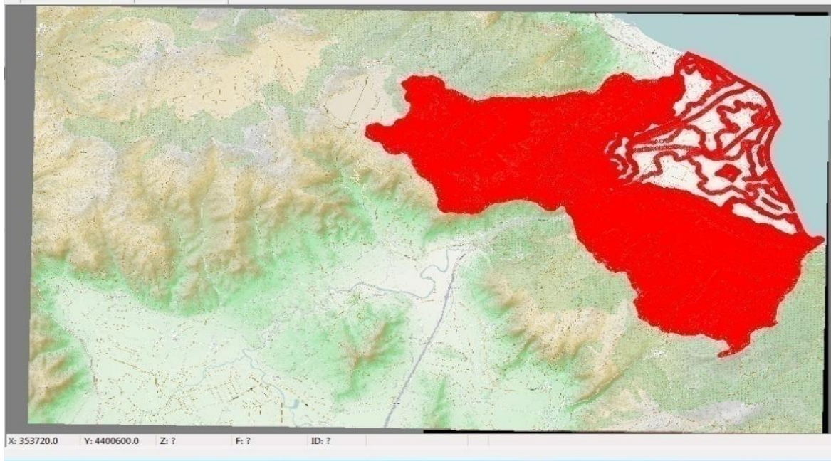
Εικόνα 16: Δημιουργία Ψηφιακού Μοντέλου Εδάφους, στο GMS, με εισαγωγή υψομετρικών σημείων, πάνω στον ενοποιημένο χάρτη της OpenStreetMaps
