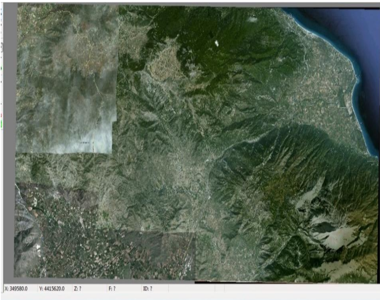
Εικόνα 8: Εισαγωγή γεωαναφοράς, στο GMS, της ενοποιημένης εικόνας αεροφωτογραφίας της Google Earth
