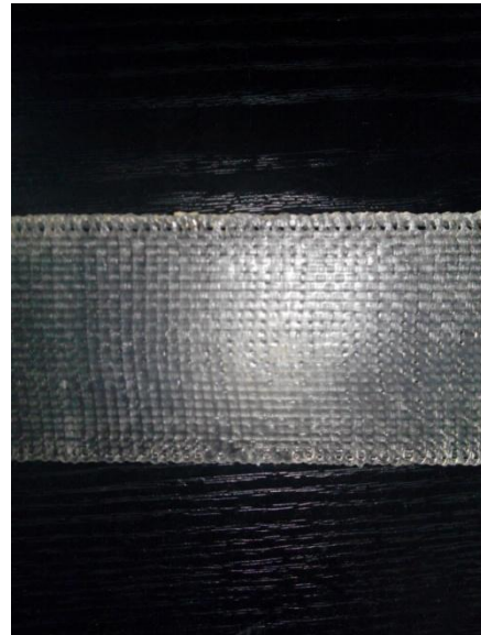
Σχήμα 109: Εμποτισμένη υαλοταινία με οδοντωτούς τροχούς
