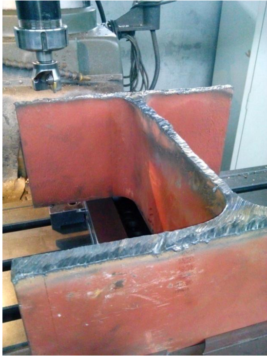
Σχήμα 43: Κατεργασίες δοκού HEA
