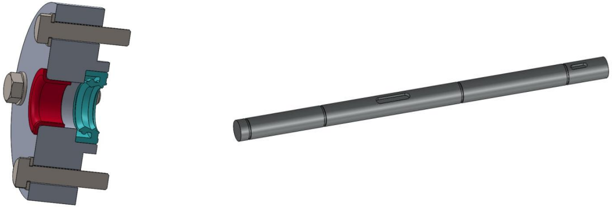
Σχήμα 62: Κουζινέτο και άξονας μονάδας περισυλλογής
