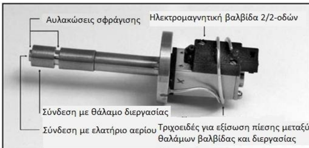
Σχήμα 4-28: Ηλεκτρομαγνητική βαλβίδα για έλεγχο θέσης εμβόλου με δακτυλικούς ακροδέκτες
