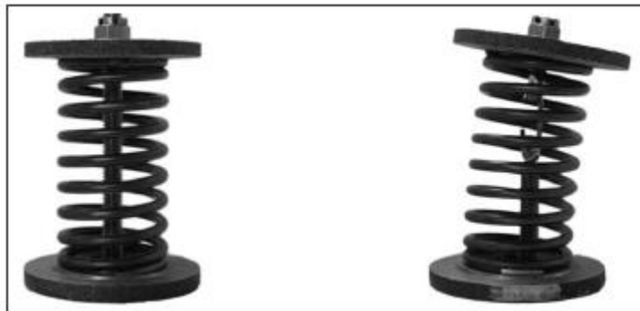
Σχήμα 4-30: Διορθωμένο μέσω στήριξης, το εσωτερικό ελατήριο του θερμού εμβόλου με (αριστερά) και χωρίς (δεξιά) αντιστάθμιση της ροπής της κλίσης
