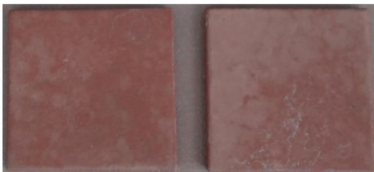
Εικόνα 6.69: Δοκίμια FXS2_A και FXS2_B μετά από 30 ημέρες δοκιμών εμβάπτισης σε διάλυμα NaCl 3,5% κ.β.
