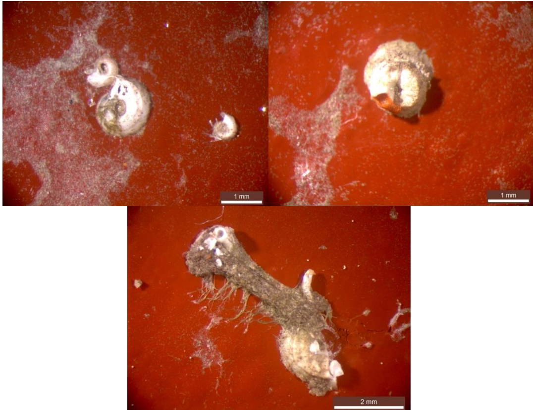
Εικόνα 6.87: Επιφάνεια του συστήματος επίστρωσης FXS1_B μετά από 120 ημέρες δοκιμών πεδίου
