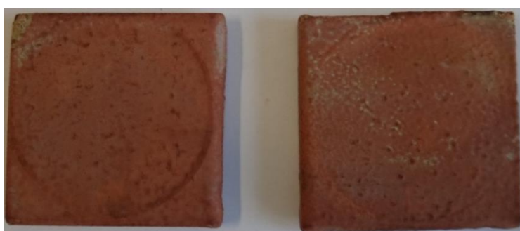
Εικόνα 6.71: Δοκίμια FXS2_A και FXS2_B μετά από 90 ημέρες δοκιμών εμβάπτισης σε διάλυμα NaCl 3,5% κ.β.
