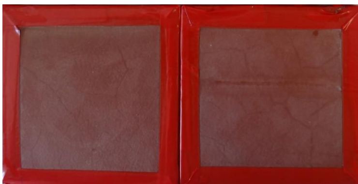
Εικόνα 6.16: Δοκίμια FXS2_A και FXS2_B μετά από 14 ημέρες δοκιμών γήρανσης στον θάλαμο αλατονέφωσης
