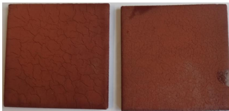
Εικόνα 6.45: Δοκίμια FXS2_A και FXS2_B μετά από 42 ημέρες δοκιμών γήρανσης στον κλιματικό θάλαμο
