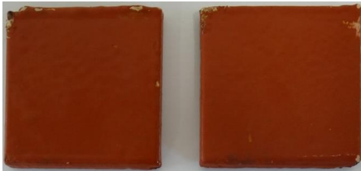
Εικόνα 6.59: Δοκίμια FXS1_A και FXS1_B μετά από 150 ημέρες δοκιμών εμβάπτισης σε διάλυμα NaCl 3,5% κ.β.
