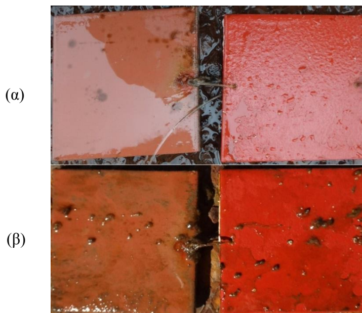
Εικόνα Π.1: Δοκίμια FXS1_B και FXS2_B μετά από (α) 60 και (β) 120 ημέρες δοκιμών πεδίου
