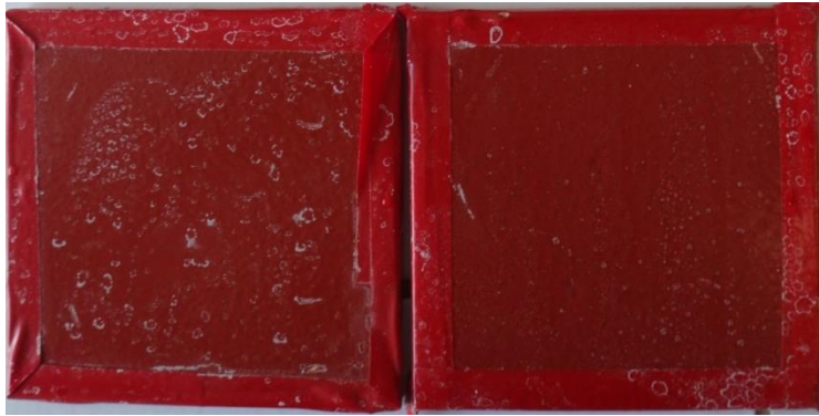
Εικόνα 6.4: Δοκίμια FXS1_A και FXS1_B μετά από 42 ημέρες δοκιμών γήρανσης στον θάλαμο αλατονέφωσης
