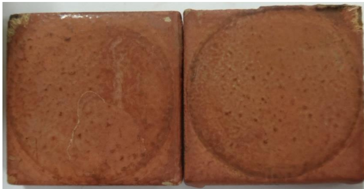
Εικόνα 6.74: Δοκίμια FXS2_A και FXS2_B μετά από 180 ημέρες δοκιμών εμβάπτισης σε διάλυμα NaCl 3,5% κ.β.
