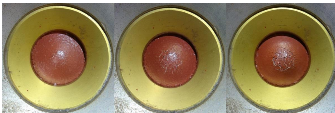
Εικόνα 6.101: Βαθμιαία ανάπτυξη ρωγμών στο σύστημα FXS2: (α) έναρξη ρωγμών, (β) διάδοση ρωγμών, (γ) έκθεση μεταλλικού υποστρώματος
