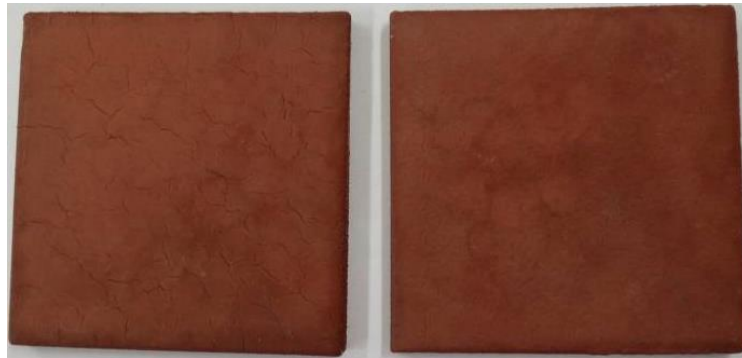
Εικόνα 6.44: Δοκίμια FXS2_A και FXS2_B μετά από 14 ημέρες δοκιμών γήρανσης στον κλιματικό θάλαμο
