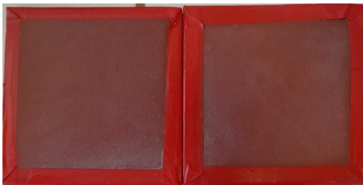
Εικόνα 6.15: Δοκίμια FXS2_A και FXS2_B μετά από 7 ημέρες δοκιμών γήρανσης στον θάλαμο αλατονέφωσης
