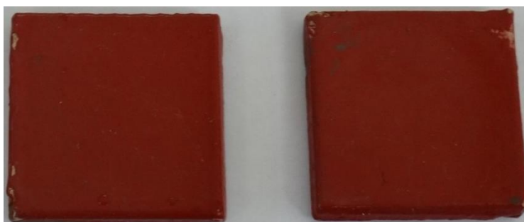
Εικόνα 6.56: Δοκίμια FXS1_A και FXS1_B μετά από 60 ημέρες δοκιμών εμφάνισης σε διάλυμα NaCl 3,5% κ.β.
