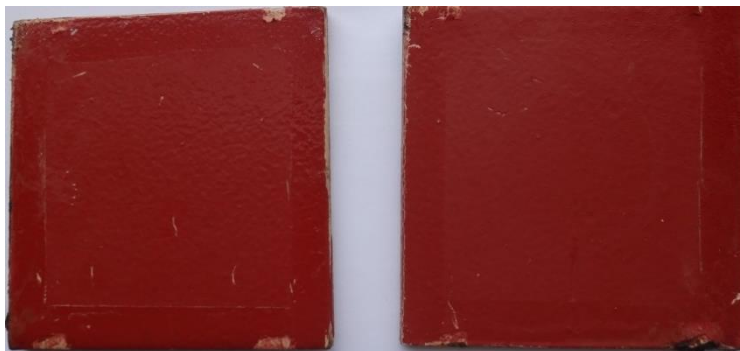
Εικόνα 6.6: Δοκίμια FXS1_A και FXS1_B μετά από 91 ημέρες δοκιμών γήρανσης στον θάλαμο αλατονέφωσης
