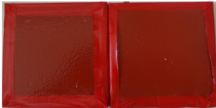
Εικόνα 6.2: Δοκίμια FXS1_A και FXS1_B μετά από 14 ημέρες δοκιμών γήρανσης στον θάλαμο αλατονέφωσης
