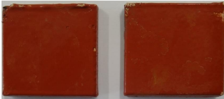
Εικόνα 6.58: Δοκίμια FXS1_A και FXS1_B μετά από 120 ημέρες δοκιμών εμβάπτισης σε διάλυμα NaCl 3,5% κ.β.
