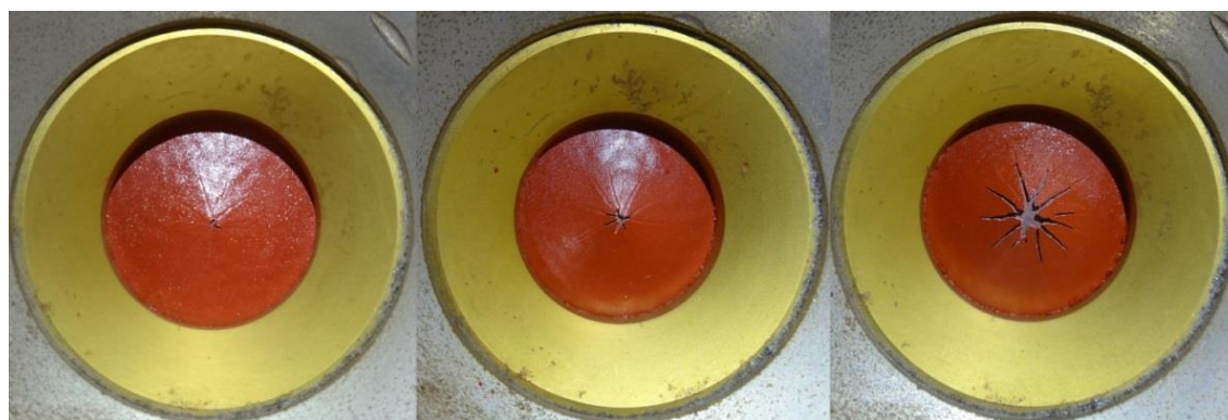
Εικόνα 6.98: Βαθμιαία ανάπτυξη ρωγμών στο σύστημα FXS1: (α) έναρξη ρωγμών, (β) διάδοση ρωγμών, (γ) έκθεση μεταλλικού υποστρώματος
