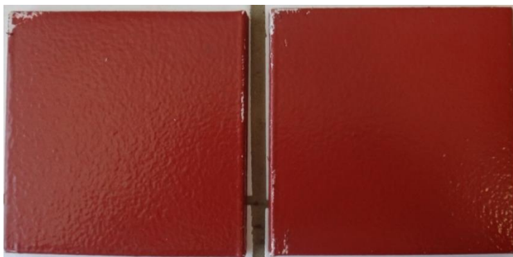
Εικόνα 6.33: Δοκίμια FXS1_A και FXS1_B μετά από 63 ημέρες δοκιμών γήρανσης στον κλιματικό θάλαμο
