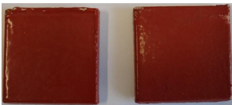
Εικόνα 6.57: Δοκίμια FXS1_A και FXS1_B μετά από 90 ημέρες δοκιμών εμφάνισης σε διάλυμα NaCl 3,5% κ.β.
