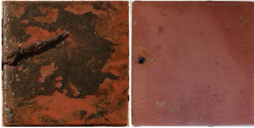
Εικόνα 6.94: Δοκίμιο FXS2_D μετά από 240 ημέρες δοκιμών πεδίου, τη στιγμή της αφαίρεσής του από το θαλασσινό νερό και μετά τον καθαρισμό του
