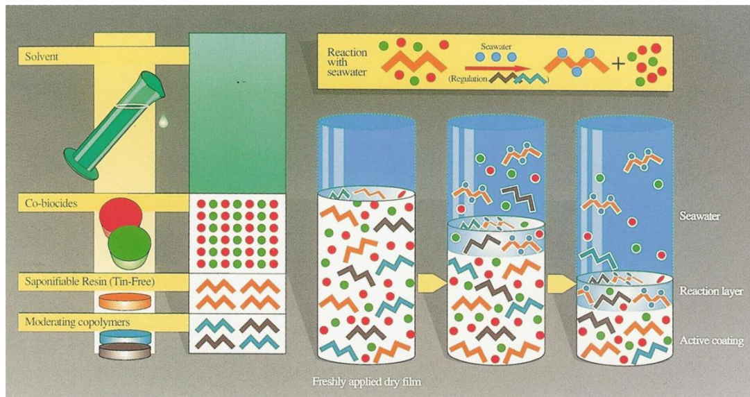
Εικόνα 1.5: Μηχανισμός λειτουργίας αντιρρυπαντικών επιστρώματων CDPs [6]
