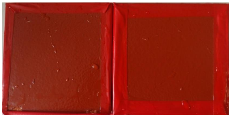
Εικόνα 6.3: Δοκίμια FXS1_A και FXS1_B μετά από 28 ημέρες δοκιμών γήρανσης στον θάλαμο αλατονέφωσης
