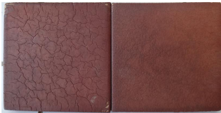
Εικόνα 6.47: Δοκίμια FXS2_A και FXS2_B μετά από 91 ημέρες δοκιμών γήρανσης στον κλιματικό θάλαμο
