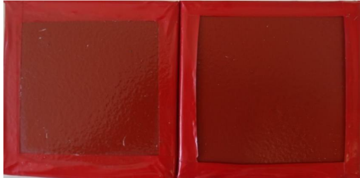
Εικόνα 6.1: Δοκίμια FXS1_A και FXS1_B μετά από 7 ημέρες δοκιμών γήρανσης στον θάλαμο αλατονέφωσης
