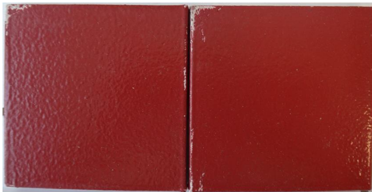
Εικόνα 6.34: Δοκίμια FXS1_A και FXS1_B μετά από 91 ημέρες δοκιμών γήρανσης στον κλιματικό θάλαμο
