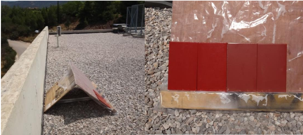
Εικόνα 6.107: Πειραματική διάταξη της δοκιμής συσσώρευσης των ρύπων
