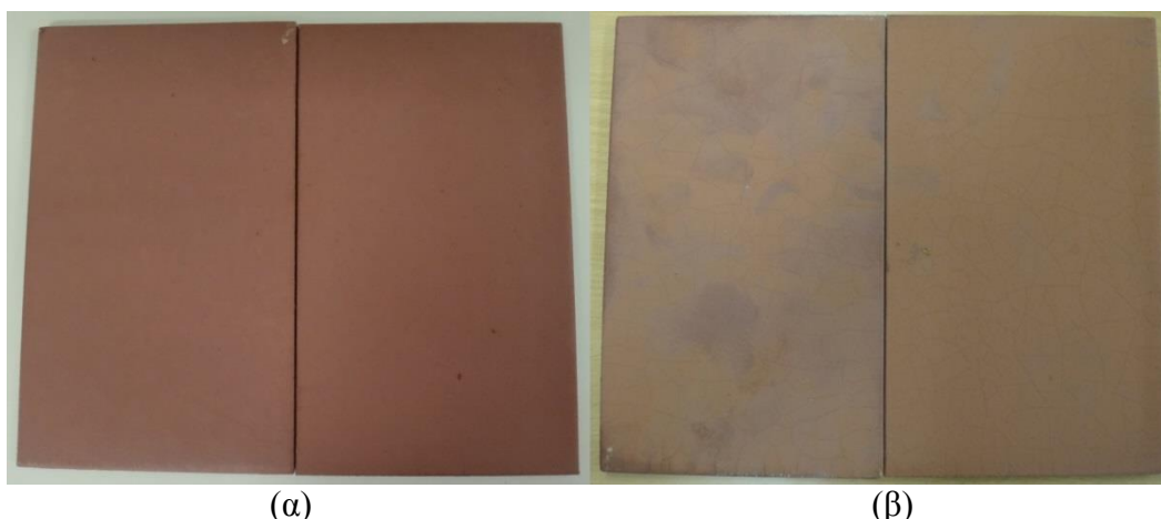
Εικόνα 6.109: Δοκίμια FXS2_A και FXS2_B μετά από (α) 30 ημέρες, (β) 61 ημέρες έκθεσης σε εξωτερικό περιβάλλον
