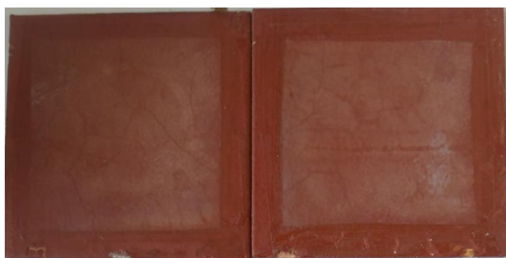
Εικόνα 6.17: Δοκίμια FXS2_A και FXS2_B μετά από 28 ημέρες δοκιμών γήρανσης στον θάλαμο αλατονέφωσης
