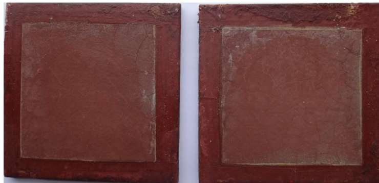
Εικόνα 6.20: Δοκίμια FXS2_A και FXS2_B μετά από 91 ημέρες δοκιμών γήρανσης στον θάλαμο αλατονέφωσης
