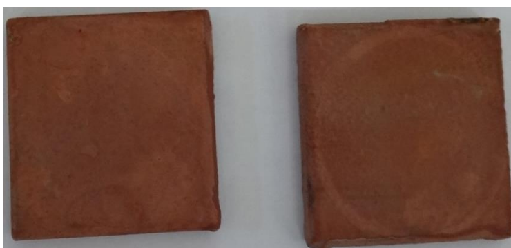
Εικόνα 6.70: Δοκίμια FXS2_A και FXS2_B μετά από 60 ημέρες δοκιμών εμβάπτισης σε διάλυμα NaCl 3,5% κ.β.
