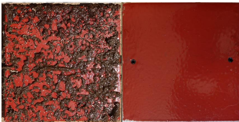
Εικόνα 6.85: Δοκίμιο FXS1_D μετά από 240 ημέρες δοκιμών πεδίου, τη στιγμή της αφαίρεσής του από το θαλασσινό νερό και μετά τον καθαρισμό του
