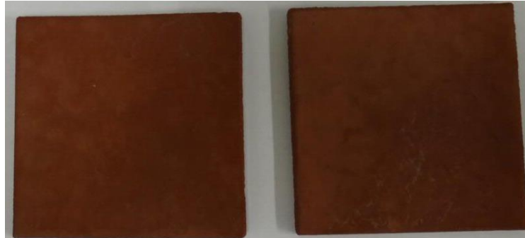
Εικόνα 6.43: Δοκίμια FXS2_A και FXS2_B μετά από 7 ημέρες δοκιμών γήρανσης στον κλιματικό θάλαμο
