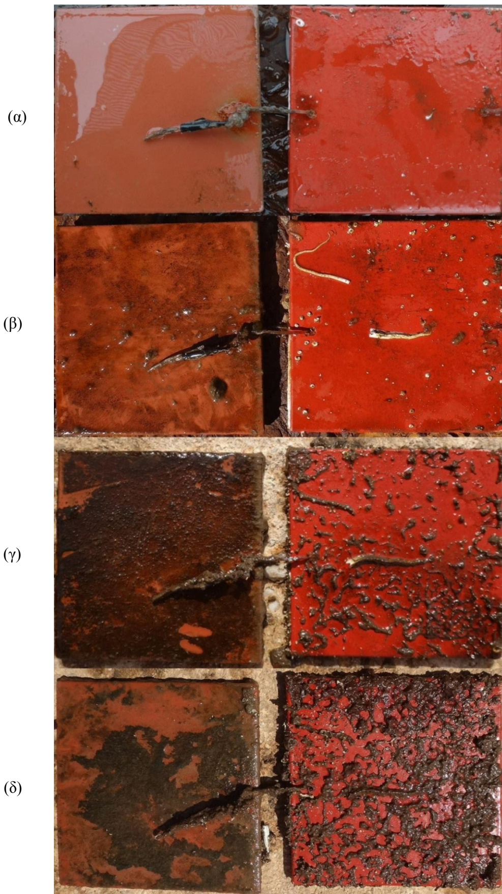
Εικόνα Π.3: Δοκίμια FXS1_D και FXS2_D μετά από (α) 60, (β) 120, (γ) 180 και (δ) 240 ημέρες δοκιμών πεδίου
