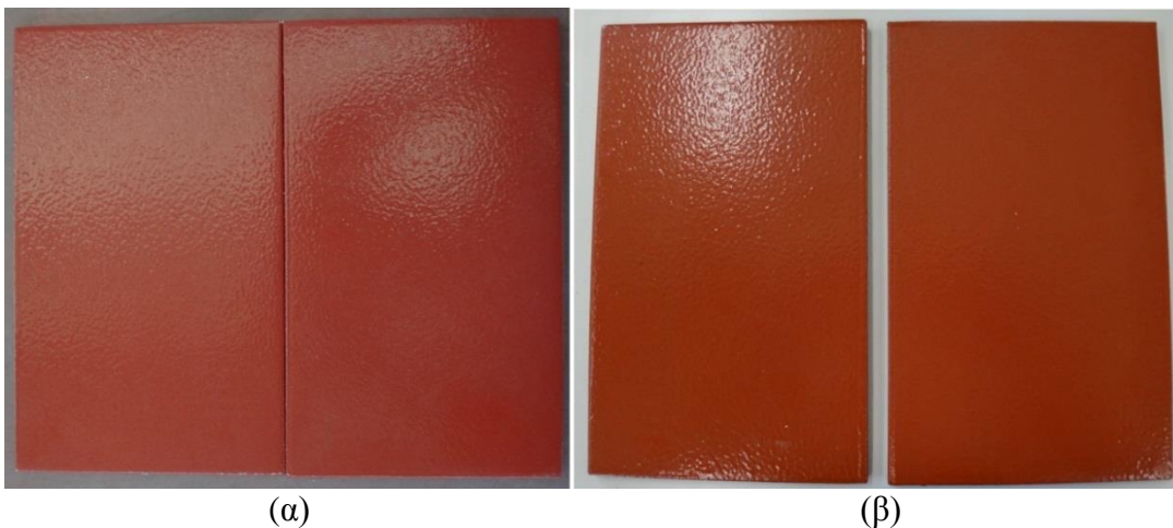
Εικόνα 6.108: Δοκίμια FXS1_A και FXS1_B μετά από (α) 30 ημέρες, (β) 61 ημέρες έκθεσης σε εξωτερικό περιβάλλον
