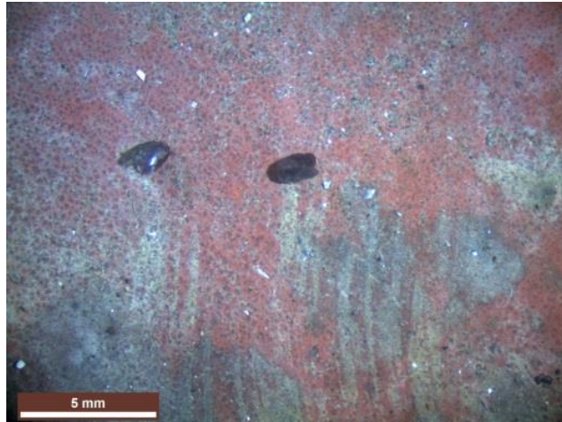
Εικόνα 6.96: Επιφάνεια του συστήματος επίστρωσης FXS2_C μετά από 180 ημέρες δοκιμών πεδίου
