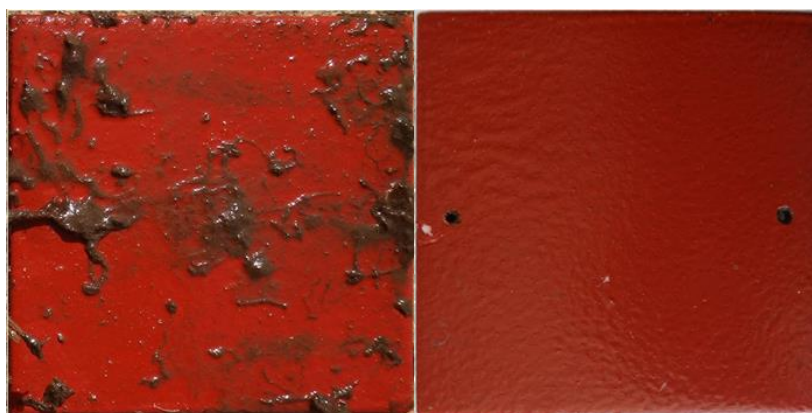
Εικόνα 6.84: Δοκίμιο FXS1_C μετά από 180 ημέρες δοκιμών πεδίου, τη στιγμή της αφαίρεσής του από το θαλασσινό νερό και μετά τον καθαρισμό του
