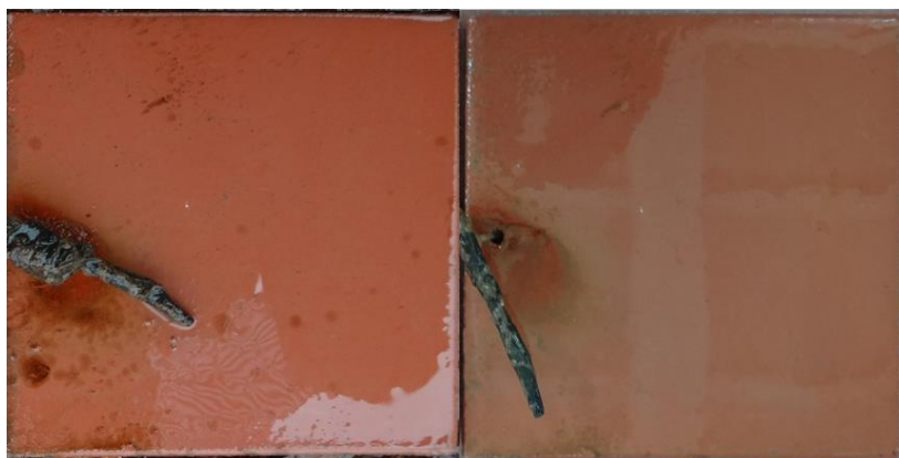
Εικόνα 6.91: Δοκίμιο FXS2_A μετά από 60 ημέρες δοκιμών πεδίου, τη στιγμή της αφαίρεσής του από το θαλασσινό νερό (αριστερά) και μετά τον καθαρισμό του (δεξιά)
