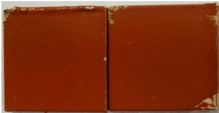
Εικόνα 6.60: Δοκίμια FXS1_A και FXS1_B μετά από 180 ημέρες δοκιμών εμβάπτισης σε διάλυμα NaCl 3,5% κ.β.
