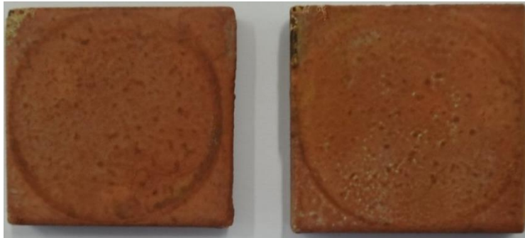
Εικόνα 6.72: Δοκίμια FXS2_A και FXS2_B μετά από 120 ημέρες δοκιμών εμβάπτισης σε διάλυμα NaCl 3,5% κ.β.
