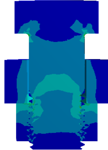
Σχήμα 4. 2: von Mises – κοχλιοσύνδεση σε τομή
