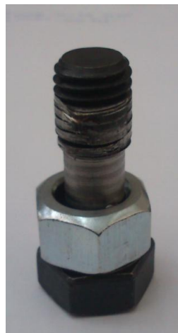
Σχήμα 9. 9: Καταστροφή σπειρώματος περικοχλίου (μετά το πείραμα)
