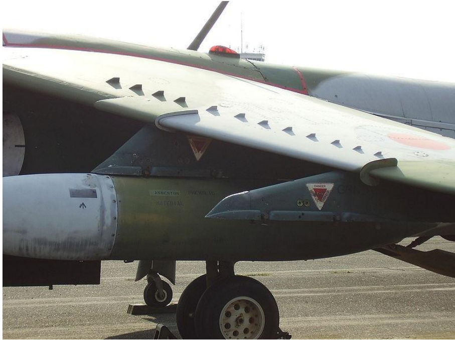
Εικόνα 1.4. VGs πάνω σε πτέρυγα μαχητικού αεροσκάφους.
