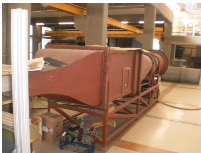
Εικόνα 3.1. Τμήμα της αεροδυναμικής σήραγγας που διεξήχθησαν τα πειράματα.
