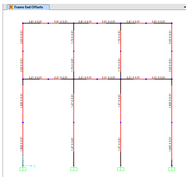
Εικόνα 2.13: Ισοδύναμο πλαίσιο τοιχοποιίας επιπέδου X-Z ( Y=0 ή Y=6,58 )
