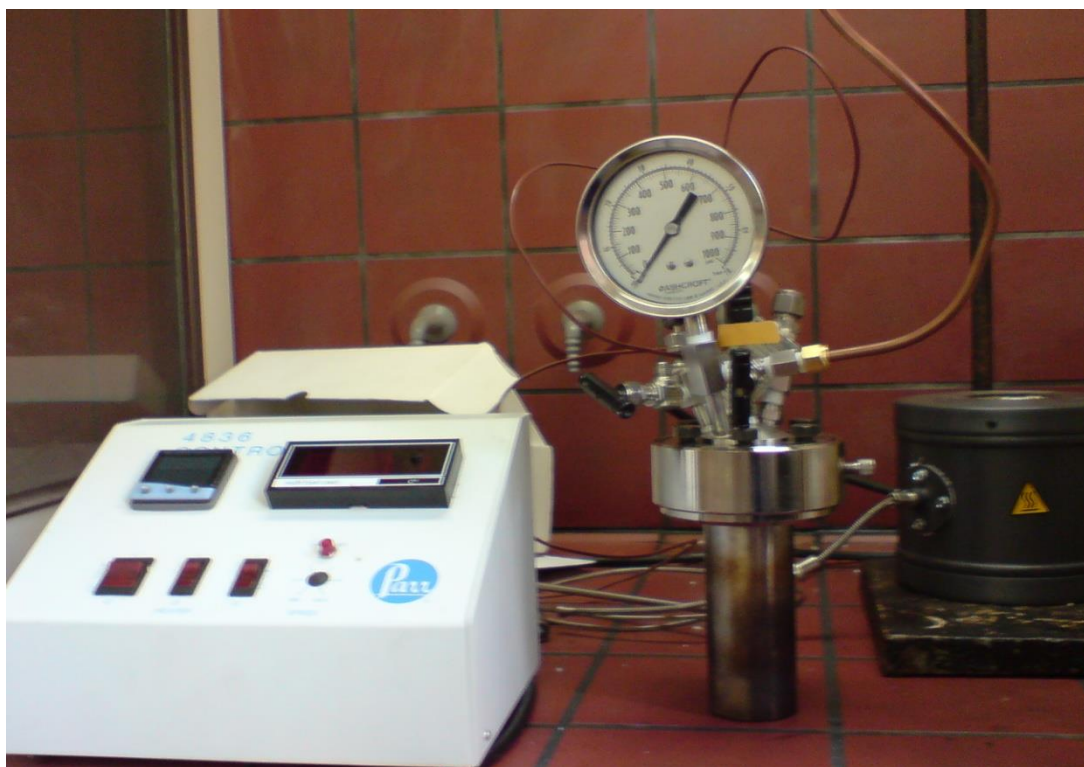
Σχήμα 6.8: Φωτογραφία όπου διακρίνεται ο αντιδραστήρας της Parr Instruments στον οποίο πραγματοποιήθηκαν οι πολυμερισμοί των αλάτων. Διακρίνεται επίσης ο ρυθμιστής και ο θερμαντικός μανδύας.
