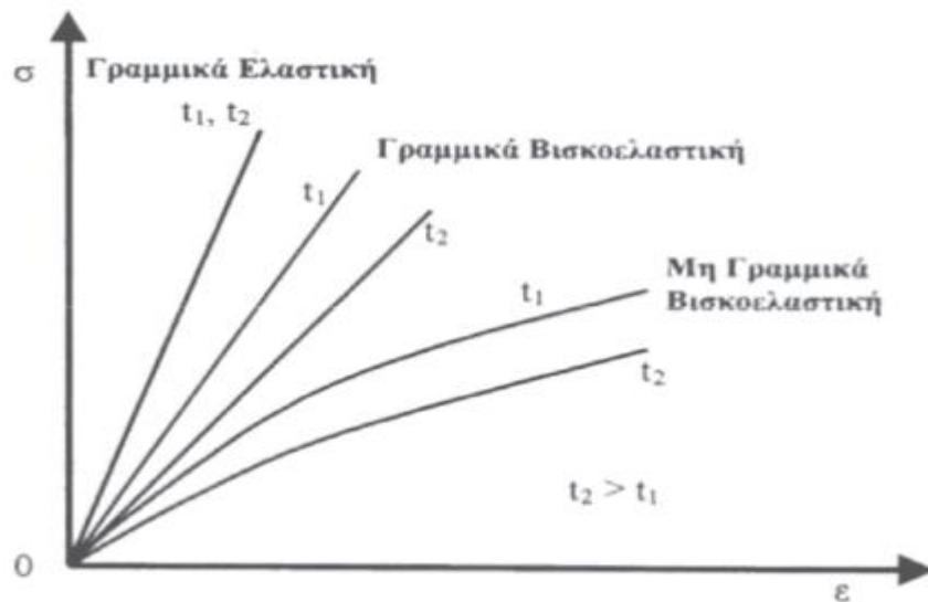
Σχήμα 40: Συμπεριφορές τάσης-παραμόρφωσης για διαφορετικούς χρόνους καταπόνησης βισκοελαστικού υλικού [89].
