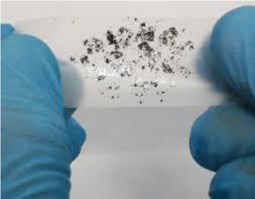
Σχήμα 10: Μέθοδος scotch tape που οδήγησε στην ανακάλυψη του γραφενίου και στο βραβείο Νομπελ Φυσικής του 2010.
