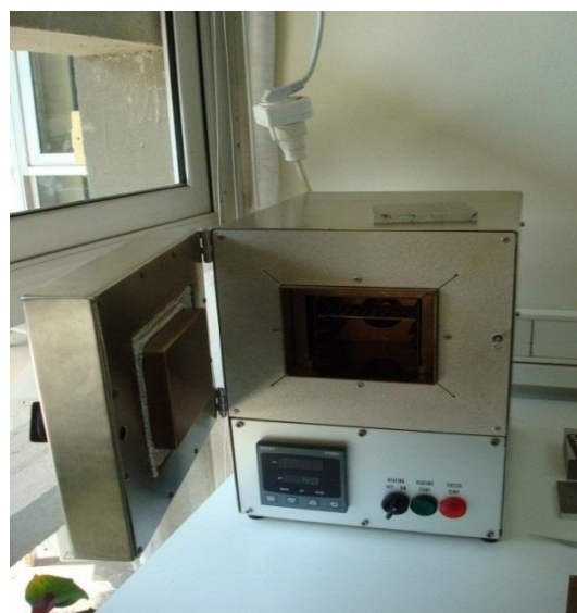
Εικόνα 36: Ειδικός φούρνος θερμικής επεξεργασίας των TLD.
