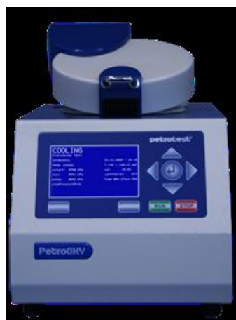
Εικόνα 3.32: Συσκευή PetroOXY– ASTM D 7525
