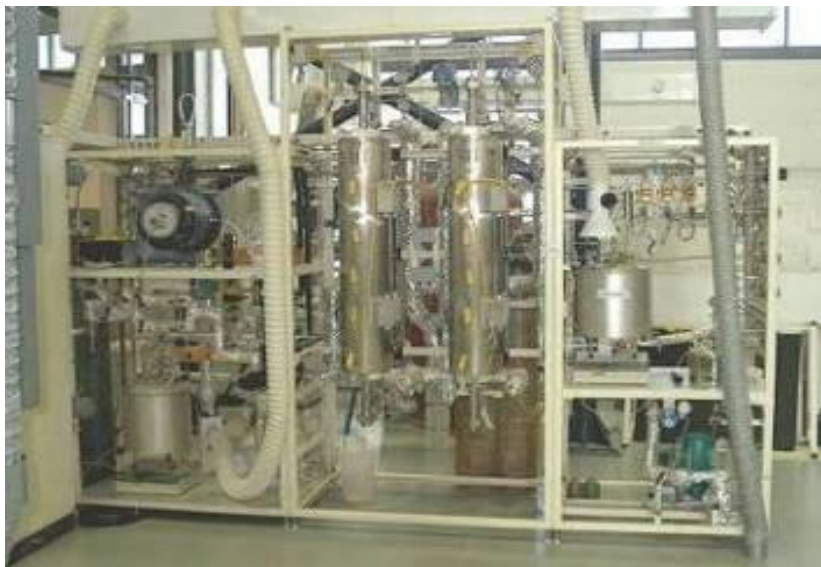
Εικόνα 2.8: Πιλοτική μονάδα υδρογονοεπεξεργασίας μεγάλης κλίμακας HDS
