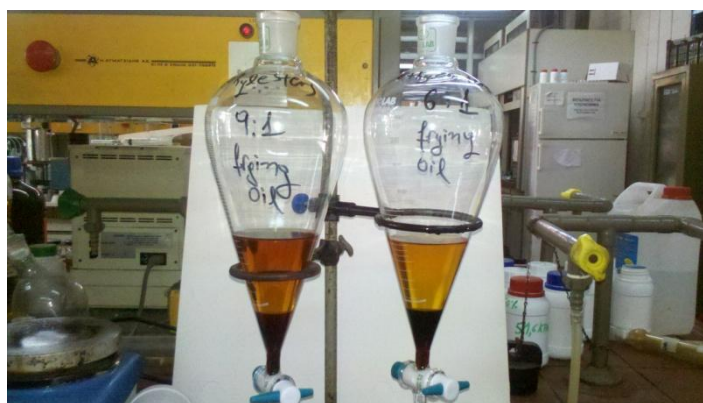
Εικόνα 3.34: Ο διαχωρισμός των φάσεων γλυκερίνης και εστέρα
