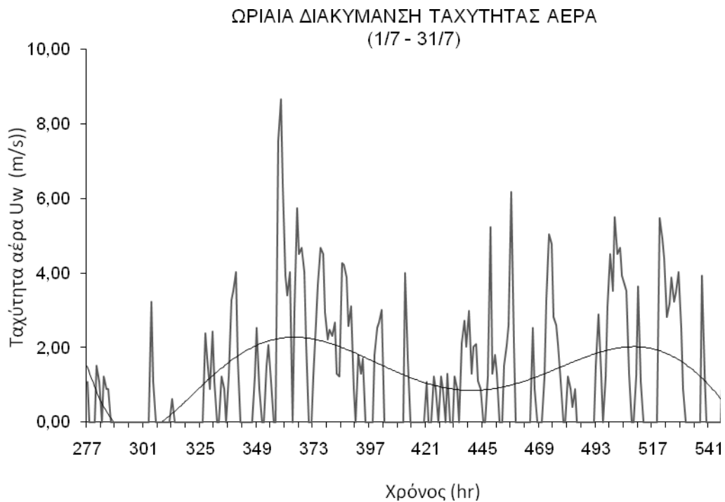
Διάγραμμα 2.5.22: Ωριαία διακύμανση της ταχύτητας του ανέμου u_w για τις συνεχείς ώρες λειτουργίας του ακτινοβολητή (νυκτερινές) κατά το μήνα Ιούλιο.
