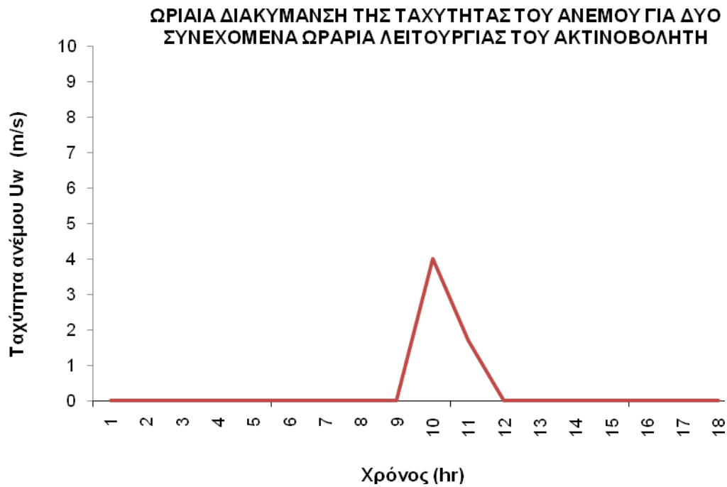
Διάγραμμα 2.5.28: Ωριαία διακύμανση της ταχύτητας του ανέμου για τις ίδιες τυχαίες 18 συνεχόμενες ώρες λειτουργίας του ακτινοβολητή κατά το μήνα Ιούλιο.
