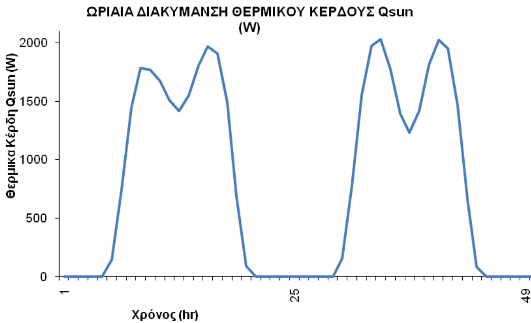
Διάγραμμα 2.5.43: Ωριαία διακύμανση των θερμικών κερδών λόγω της ηλιακής ακτινοβολίας Q_{sun} εντός της κατοικίας για τυχαίες 48 συνεχόμενες ώρες κατά το μήνα Ιούλιο.
