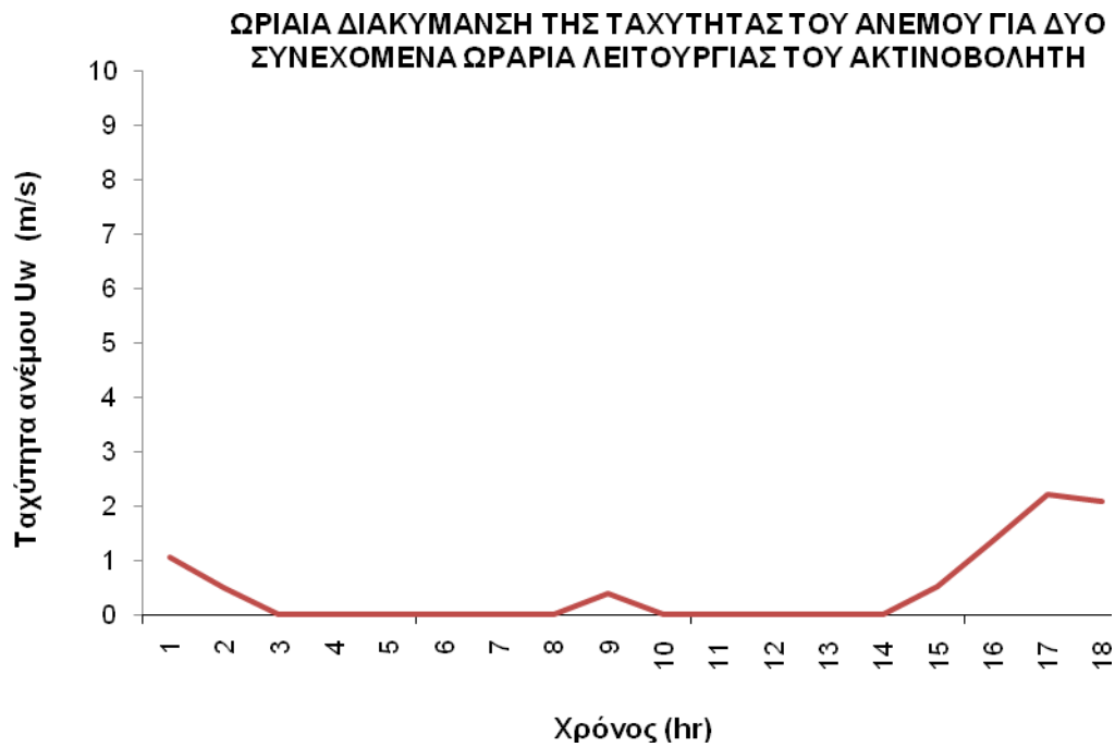
Διάγραμμα 2.5.30: Ωριαία διακύμανση της ταχύτητας του ανέμου για τις ίδιες τυχαίες 18 συνεχόμενες ώρες λειτουργίας του ακτινοβολητή κατά το μήνα Αύγουστο.
