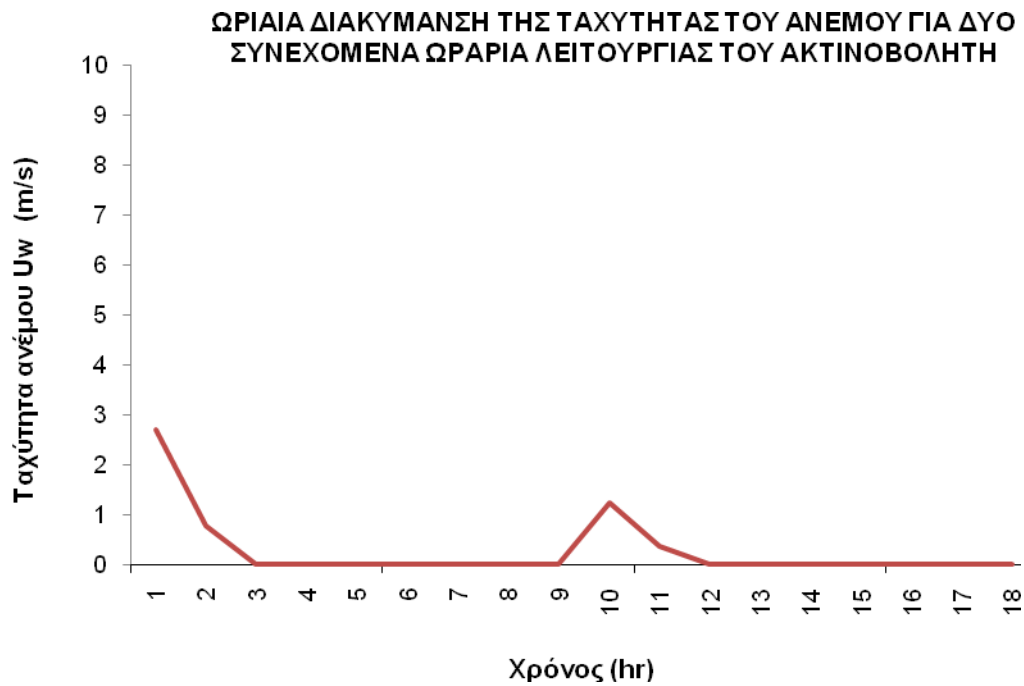
Διάγραμμα 2.5.32: Ωριαία διακύμανση της ταχύτητας του ανέμου για τις ίδιες τυχαιές 18 συνεχόμενες ώρες λειτουργίας του ακτινοβολητή κατά το μήνα Σεπτέμβριο.
