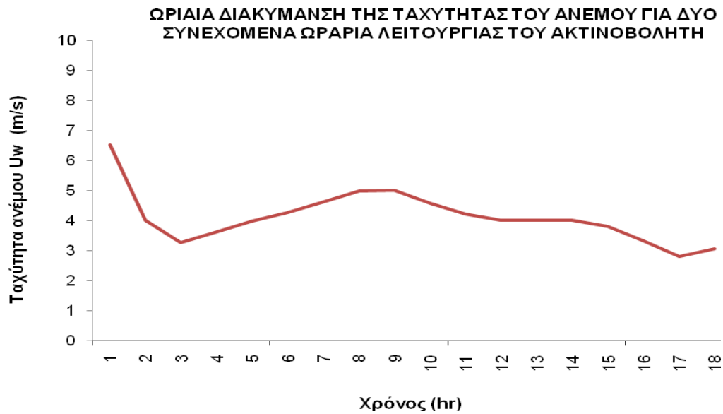
Διάγραμμα 2.5.26: Ωριαία διακύμανση της ταχύτητας του ανέμου για τις ίδιες τυχαίες 18 συνεχόμενες ώρες λειτουργίας του ακτινοβολητή κατά το μήνα Ιούνιο.
