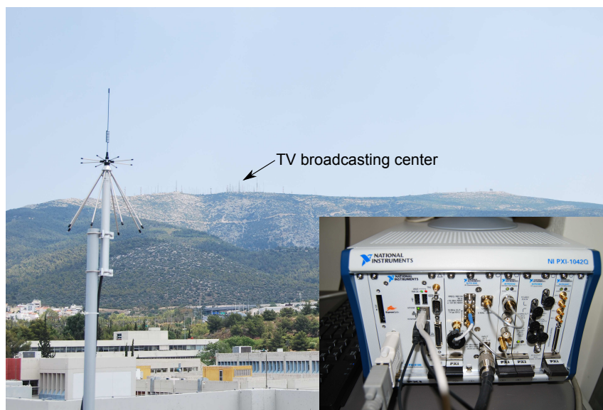
Σχήμα 2.3: Εξοπλισμός φασματικής ανίχνευσης και τοποθεσία μετρήσεων.
