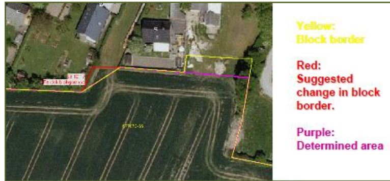
Σχήμα 1.10: Διορθώσεις κατά τον έλεγχο των ορίων του RP Πηγή: Friis H., GeoCAP,2009
