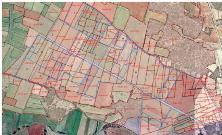
Σχήμα 2.1: Επίθεση διαγραμμάτων περιοχής αναδιασμού Παύλου Ν. Βοιωτίας με αρχικά γεωτεμαχία Κτηματολογίου (κόκκινο χρώμα) και τελικά τεμάχια αναδιασμού (μπλε χρώμα) Πηγή: ΚΤΗΜΑΤΟΛΟΓΙΟ ΑΕ, 2012
