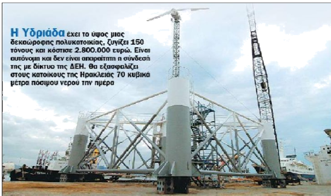
Εικόνα 12. Η "Υδριάδα", η πρώτη παγκοσμίως πλωτή μονάδα αφαλάτωσης (Μουταάφης,2008)
