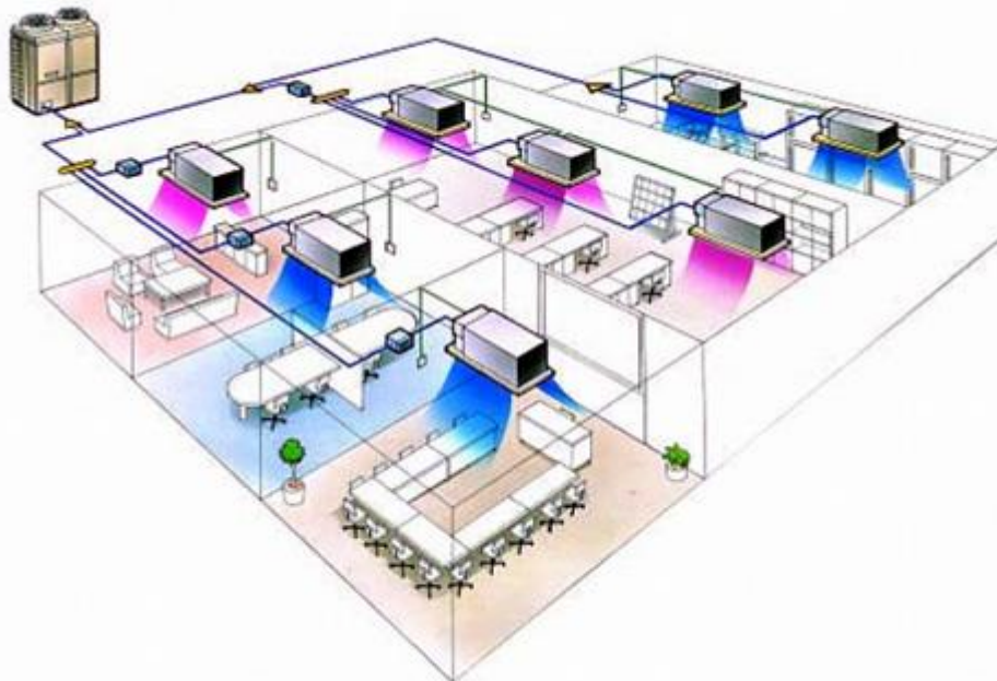
Εικ. 12: Εγκατάσταση συστήματος VRV σε κτίριο
