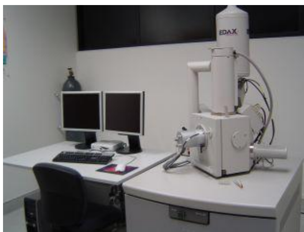
Εικόνα 2.8 Ηλεκτρονικό μικροσκόπιο σάρωσης (Quanta 200 FEI (2004),OR, USA).
