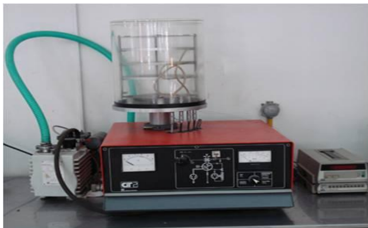
Εικόνα 6.1 Συσκευή ξήρανσης υπό κατάψυξη (Leybold-Heraeus GT 2A).
