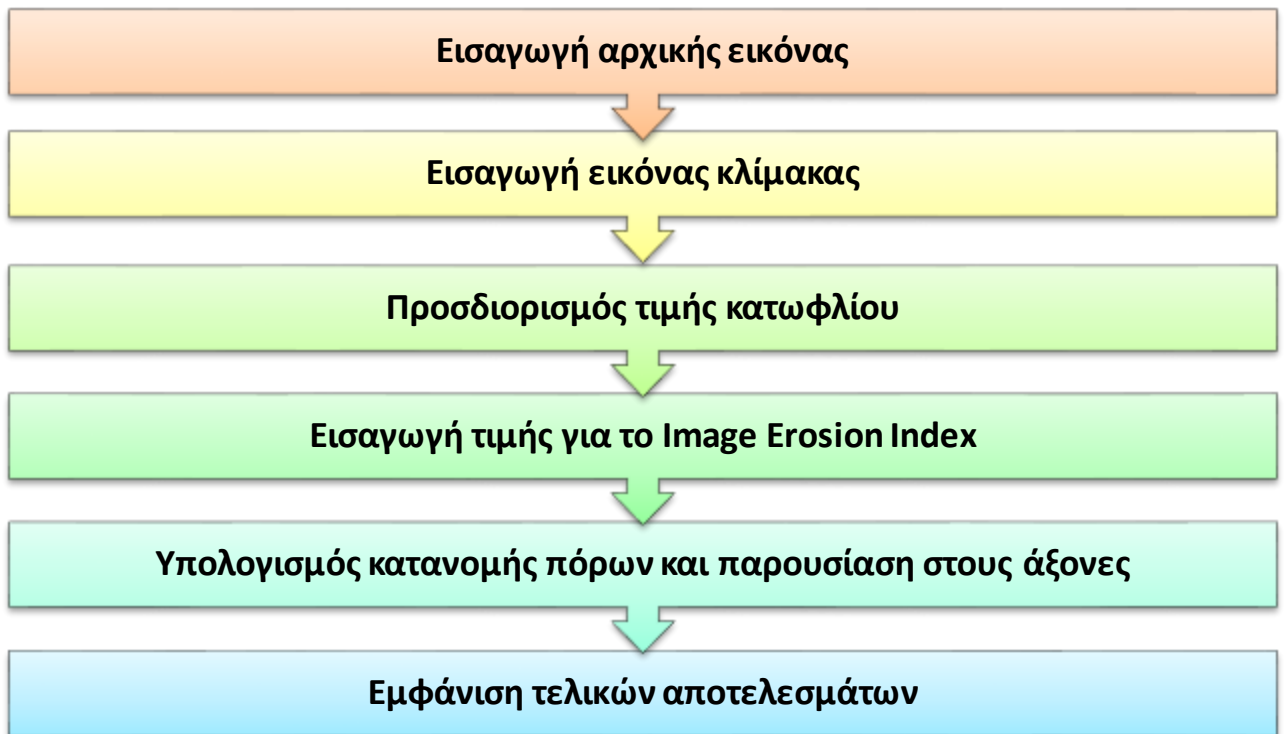
Εικόνα 5.15 Διάγραμμα που εμφανίζει τη σειρά των απαραίτητων βημάτων/ διαδικασιών του εργαλείου λογισμικού που αναπτύχθηκε για την εμφάνιση του αποτελέσματος του πρώτου σταδίου.
