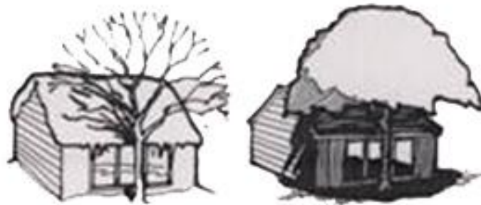
Σχήμα 3.12 : Σκίαση από βλάστηση [16]
