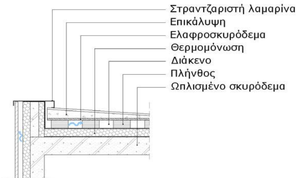
Σχήμα 3.37 : Τομή σε αεριζόμενο δώμα [16]
