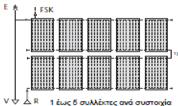
Σχήμα 4.11 : Σύνδεση σε σειρά 2 συστοιχιών συλλεκτών [28]
