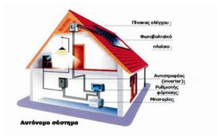
Σχήμα 2.7: Αυτόνομο φωτοβολταϊκό σύστημα [11]
