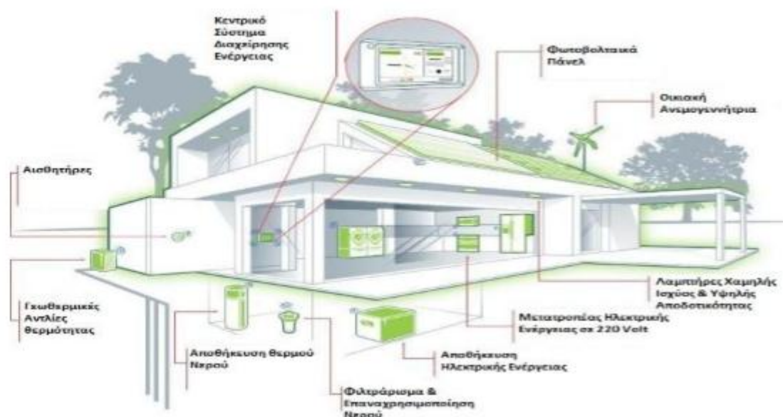
Εικόνα 2.1: Αναπαράσταση Κτιρίου Μηδενικής Ενέργειας [4]
