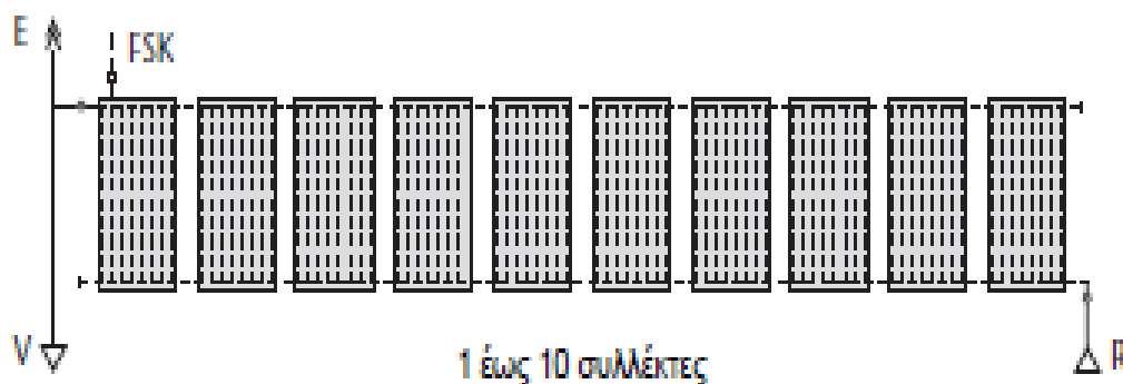
Σχήμα 4.10: Σύνδεση συλλεκτών σε σειρά [28]
