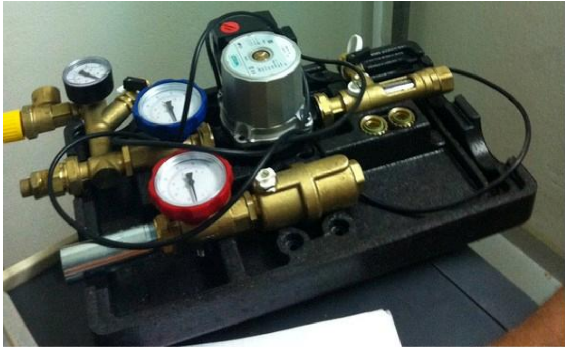
Σχήμα 5.14 : Κυκλοφορητής πριν την εγκατάσταση.
