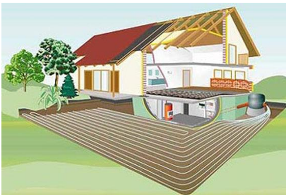
Σχήμα 2.10:Γεωθερμικό σύστημα οριζόντιας διάταξης [11]
