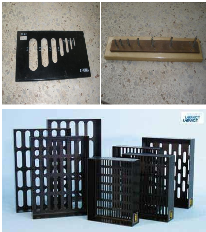
Εικόνα 4: Εξοπλισμός προσδιορισμού χαρακτηριστικών σχήματος τεμαχίων αδρανών Εργαστηρίου Εμπλουτισμού Μεταλλευμάτων Ε.Μ. Πολυτεχνείου.
