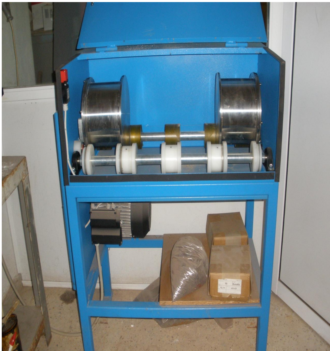
Εικόνα 2 Διάταξη διεξαγωγής της δοκιμής micro-deval (Εργαστήριο Εμπλουτισμού Μετ/των Ε.Μ.Π)
