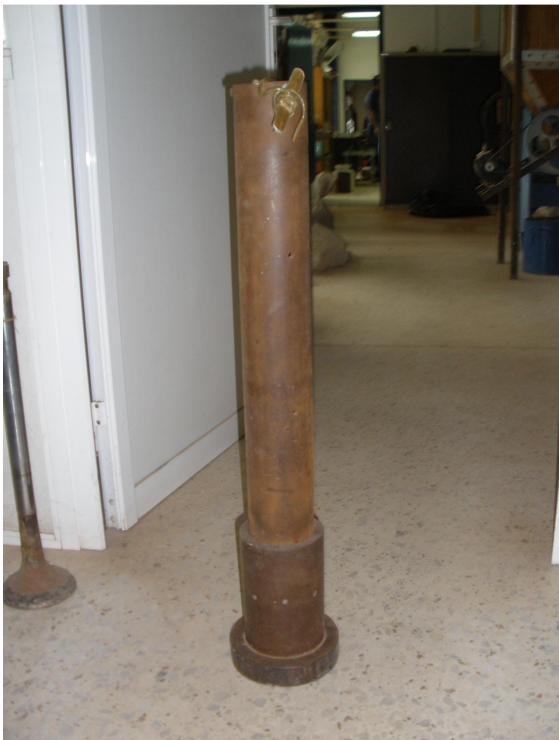
Εικόνα 3: Διάταξη διεξαγωγής της δοκιμής Protodyaconov (Εργαστήριο Εμπλουτισμού Μετ/των Ε.Μ.Π.).
