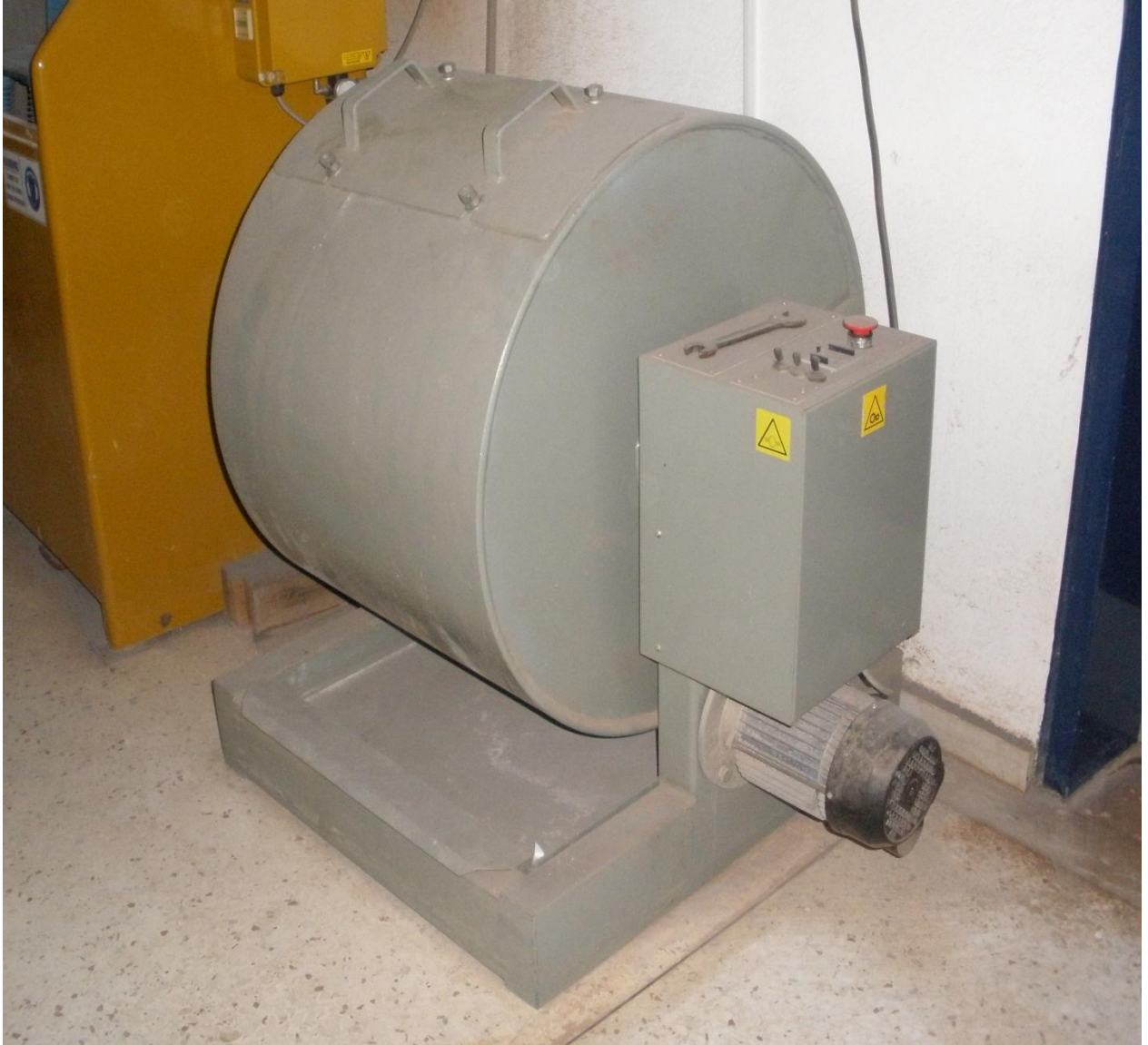
Εικόνα 1.1.1: Μηχανή Los Angeles – Εργαστήριο ΕΜΓ
