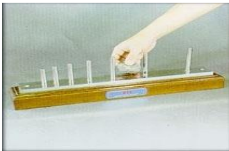
Εικόνα 4.3.3: Μετρητική συσκευή μήκους για έλεγχο μήκους τεμαχίων.
