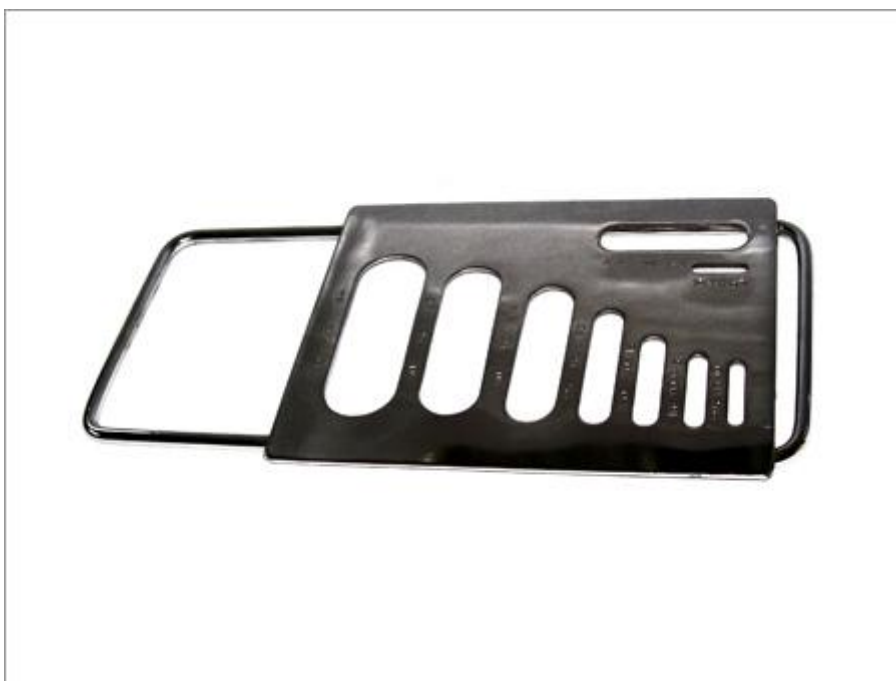
Εικόνα 4.3 1: Μετρητική συσκευή για έλεγχο πάχους τεμαχίων.
