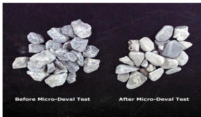
Εικόνα 2.5 1: Υλικό πριν και μετά τη δοκιμή Micro – Deval.
