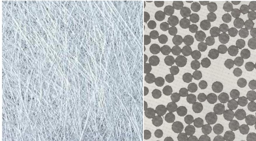
Σχήμα 2.5: Ίνες γυαλιού σε εποξειδική μήτρα. Αριστερά: Διαμήκης τομή - Δεξιά: Εγκάρσια τομή ( http://www.sterlitech.com )
