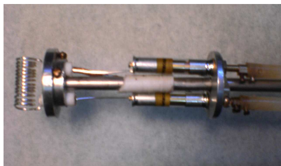
Σχήμα 60. Διατάξεις συντονισμού – δειγματοφορείς που κατασκευάστηκαν στο εργαστήριο NMR για τη μελέτη των υλικών σε χαμηλές θερμοκρασίες. Διακρίνονται το πηνίο και οι μικρομετρικοί – μεταβλητοί πυκνωτές για τον συντονισμό της διάταξης.
