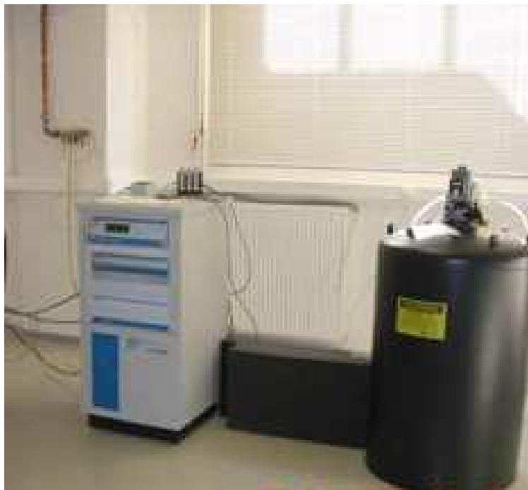
Σχήμα 72. Η διάταξη PPMS που χρησιμοποιήθηκε για τις μετρήσεις ειδικής θερμότητας των υλικών \text{La}_{1-x}\text{Ca}_x\text{MnO}_3 .
