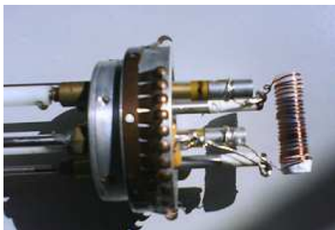
Σχήμα 60. Διατάξεις συντονισμού – δειγματοφορείς που κατασκευάστηκαν στο εργαστήριο NMR για τη μελέτη των υλικών σε χαμηλές θερμοκρασίες. Διακρίνονται το πηνίο και οι μικρομετρικοί – μεταβλητοί πυκνωτές για τον συντονισμό της διάταξης.
