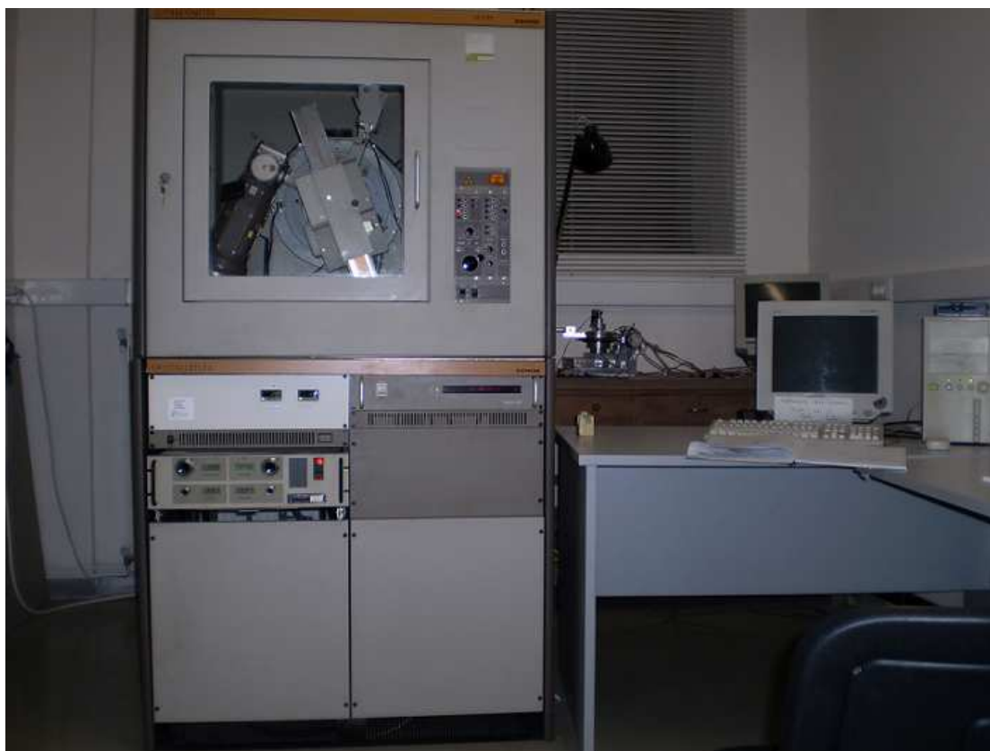
Σχήμα 69. Η διάταξη Περίθλασης Ακτίνων X, που χρησιμοποιήθηκε για τον δομικό χαρακτηρισμό.
