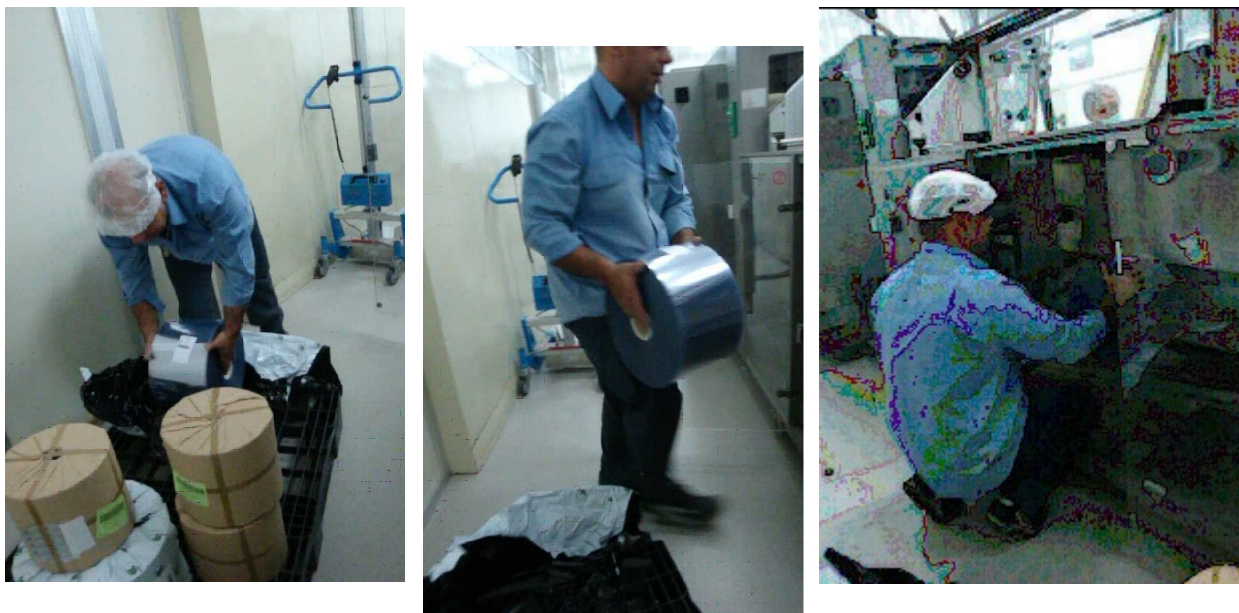
Εικόνα 4.9: Χειρωνακτική ανύψωση ρολού Ρvc
