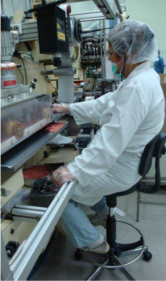
Εικόνα 4.2: Συσκευάστρια κατά τον έλεγχο πληρότητας του blister
