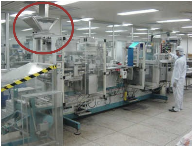
Εικόνα 7.15: Γραμμή συσκευασίας με ενσωματωμένο αναρροφητήρα
