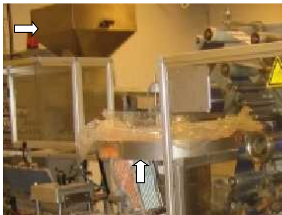
Εικόνα 4.3: Τροφοδοτικό δοχείο και ταψί γραμμής συσκευασίας
