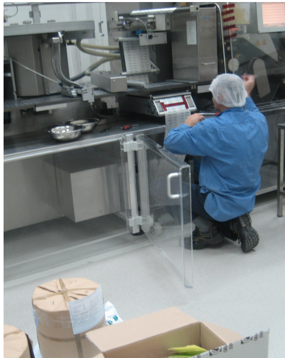
Εικόνα 5.5: Μηχανικός της γραμμής I κατά την τοποθέτηση του ρολού foil
