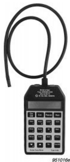
Εικόνα 2.11: Ηχοδοσίμετρο Brüel & Kjær 4436
