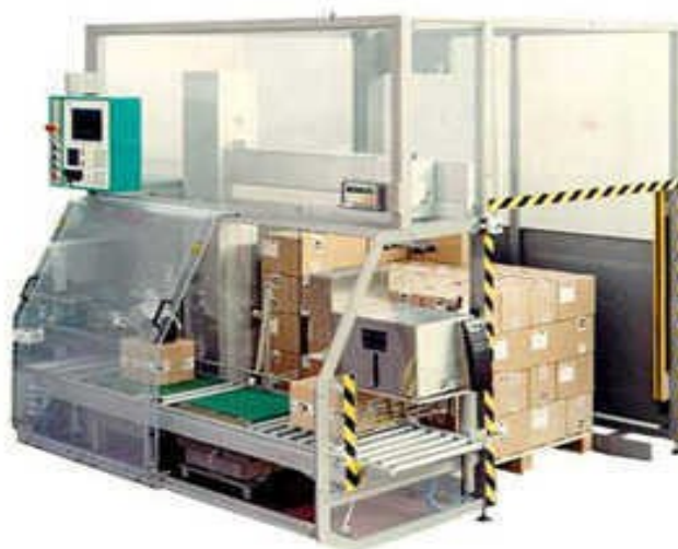
Εικόνα 7.12: Μηχανή παλετοποίησης έτοιμων χάρτινων κιβωτίων
