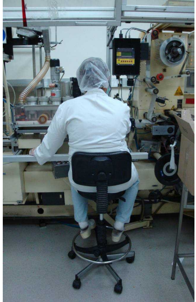
Εικόνα 4.2: Συσκευάστρια κατά τον έλεγχο πληρότητας του blister
