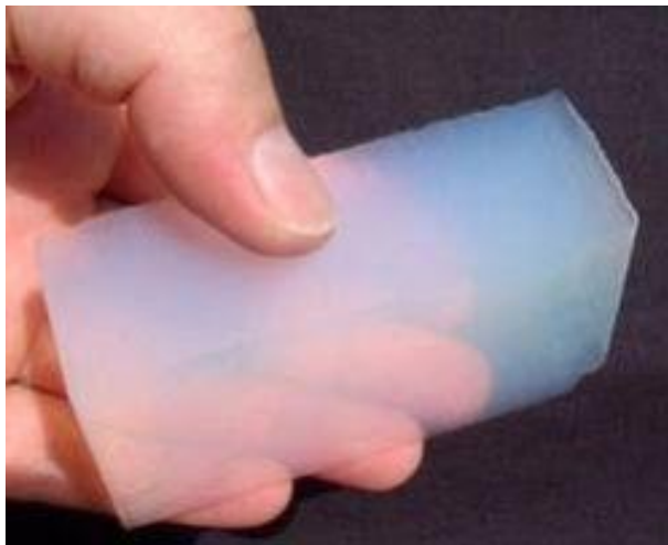
Εικόνα 1.11 Πλάκα μονωτικού υλικού aerogel [37]
