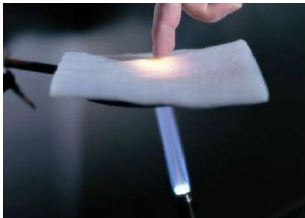
Εικόνα 1.12 Λόγω των πολύ καλών θερμομονωτικών ιδιοτήτων του aerogel το ανθρώπινο χέρι δεν καίγεται [38]
