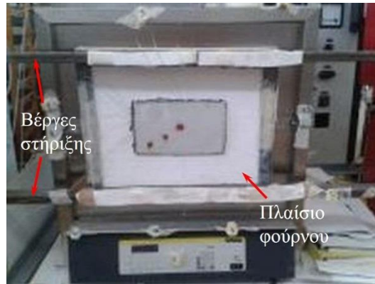
Εικόνα 3-14 Τοποθέτηση πλαισίου στο φούρνο
