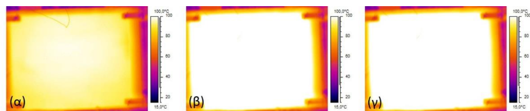
Εικόνα 4-44: (α) Στιγμιότυπο θερμοκάμερας σε θερμοκρασία φούρνου 850^\circ\text{C} , (β) Στιγμιότυπο θερμοκάμερας στη μόνιμη κατάσταση, (γ) Στιγμιότυπο θερμοκάμερας στη μόνιμη κατάσταση
