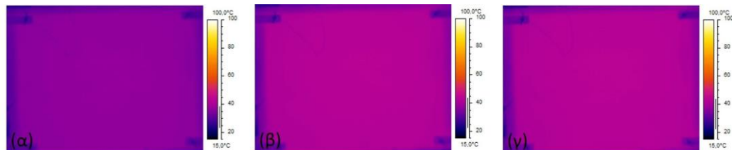
Εικόνα 4-38: (α) Στιγμιότυπο θερμοκάμερας σε θερμοκρασία φούρνου 250^\circ C , (β) Στιγμιότυπο θερμοκάμερας στη μόνιμη κατάσταση, (γ) Στιγμιότυπο θερμοκάμερας στη μόνιμη κατάσταση
