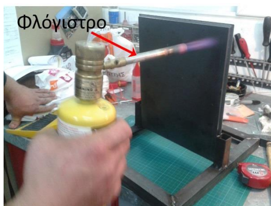
Εικόνα 3-26 Καθαρισμός πλάκας με φλόγιστρο
