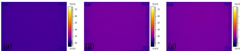
Εικόνα 4-60: (α) Στιγμιότυπο θερμοκάμερας σε θερμοκρασία φούρνου 150^\circ C , (β) Στιγμιότυπο θερμοκάμερας στη μόνιμη κατάσταση, (γ) Στιγμιότυπο θερμοκάμερας στη μόνιμη κατάσταση
