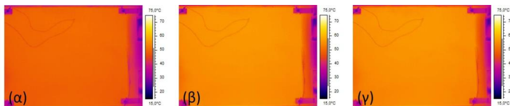
Εικόνα 4-65: (α) Στιγμιότυπο θερμοκάμερας σε θερμοκρασία φούρνου 650^\circ\text{C} , (β) Στιγμιότυπο θερμοκάμερας στη μόνιμη κατάσταση, (γ) Στιγμιότυπο θερμοκάμερας στη μόνιμη κατάσταση
