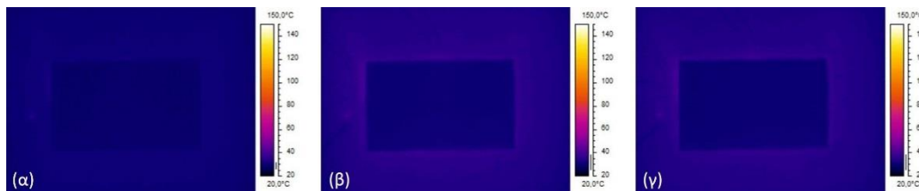
Εικόνα 4-15: (α) Στιγμιότυπο θερμοκάμερας σε θερμοκρασία φούρνου 75^{\circ}C , (β) Στιγμιότυπο θερμοκάμερας στη μόνιμη κατάσταση, (γ) Στιγμιότυπο θερμοκάμερας στη μόνιμη κατάσταση
