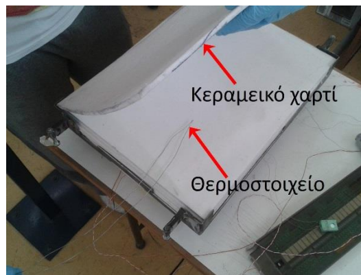
Εικόνα 3-23 Τοποθέτηση κεραμεικού χαρτιού και θερμοστοιχείων στο πλαίσιο
