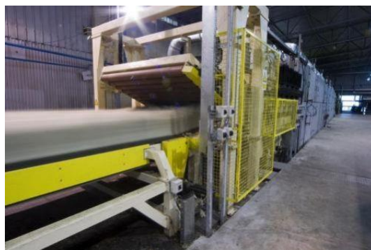
Εικόνα 2-6 Έξοδος πετροβάμβακα από θάλαμο ξήρανσης [36]
