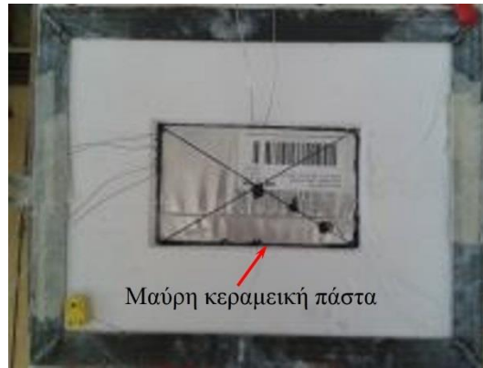
Εικόνα 3-11 Τοποθέτηση πρώτου δοκιμίου-ενδιάμεση επιφάνεια
