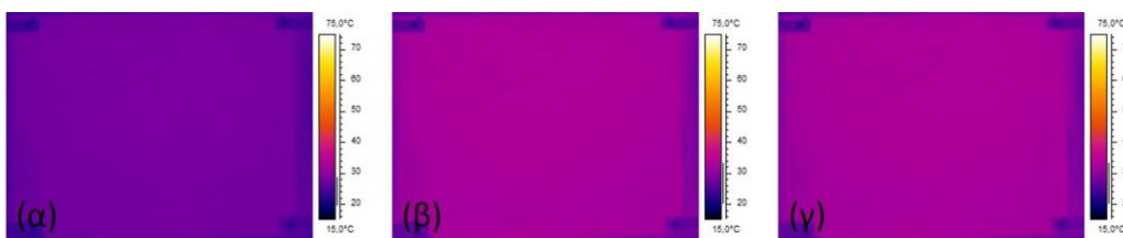
Εικόνα 4-61: (α) Στιγμιότυπο θερμοκάμερας σε θερμοκρασία φούρνου 250^\circ C , (β) Στιγμιότυπο θερμοκάμερας στη μόνιμη κατάσταση, (γ) Στιγμιότυπο θερμοκάμερας στη μόνιμη κατάσταση
