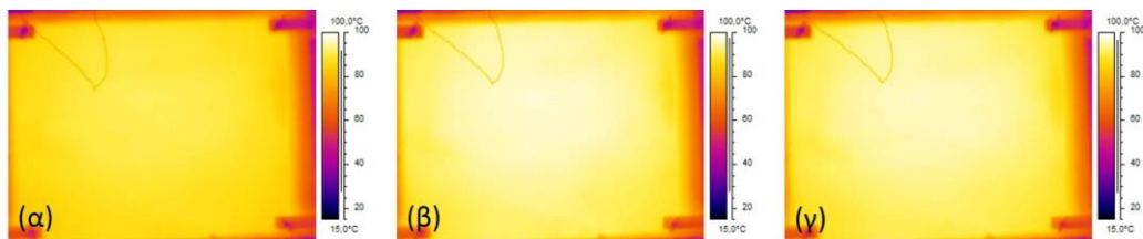
Εικόνα 4-43: (α) Στιγμιότυπο θερμοκάμερας σε θερμοκρασία φούρνου 750^\circ\text{C} , (β) Στιγμιότυπο θερμοκάμερας στη μόνιμη κατάσταση, (γ) Στιγμιότυπο θερμοκάμερας στη μόνιμη κατάσταση
