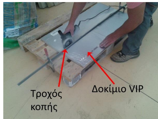
Εικόνα 3-28 Κοπή VIP με βοήθεια τροχού σε προβλεπόμενες διαστάσεις
