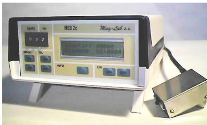
Εικόνα 2-2: Πειραματική διάταξη για τη μέτρηση του μαγνητικού θορύβου Barkhausen.
