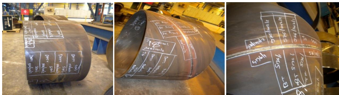
Εικόνα 1-21: Μαρκάρισμα στην επιφάνεια των χαλυβδοσωλήνων των σημείων από τα οποία θα κοπούν δείγματα για να μελετηθούν οι μηχανικές τους ιδιότητες.
