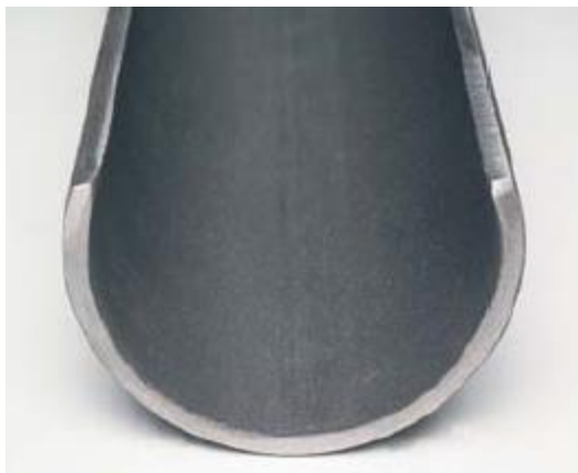
Εικόνα 1-18: Χαλυβδοσωλήνες θερμής έλασης με ολική εξομάλυνση και με αφαίρεση της εσωτερικής κρέμασης της συγκόλλησης.
