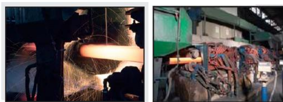
Εικόνα 1-7: Θερμή έλαση σωλήνα με ολική εξομάλυνση στους 850 °C – 1100 °C.
