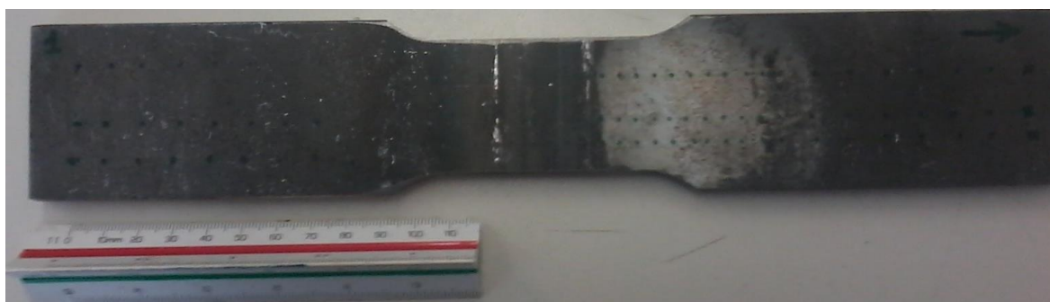
Εικόνα 2-6: Σημεία γραμμικών μετρήσεων του μαγνητικού θορύβου Barkhausen στην επιφάνεια του συγκολλημένου δείγματος #1.
