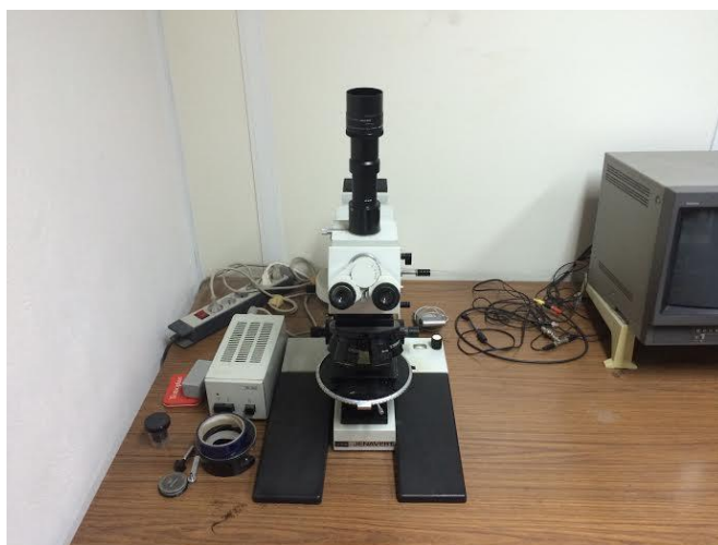
Εικόνα 2-15: Οπτικό μικροσκόπιο τύπου OLYMPUS BX41-M.
