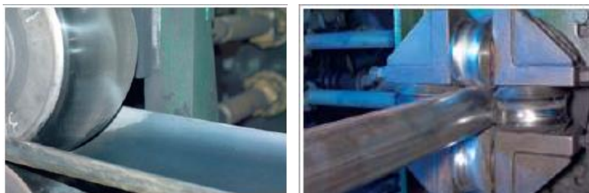
Εικόνα 1-10: Ψυχρή σωληνοποίηση χωρίς εξομάλυνση.
