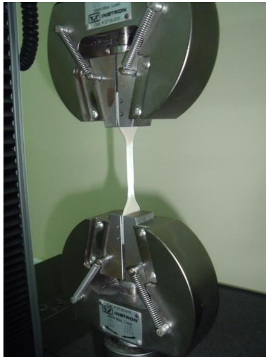
Εικόνα 2.9: Πραγματοποίηση πειραμάτων εφελκυσμού με τη συγκεκριμένη συσκευή Instron
