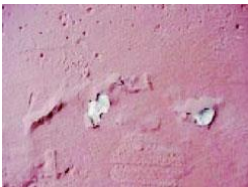
Σχήμα 8: Εμφάνιση κρατήρων στην εφαρμογή του χρώματος [ http://www.vechro.gr/el/solutions/problems-and-solutions ]
