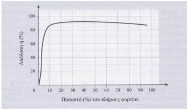
Εικόνα 2.17: Μεταβολή της απόδοσης του inverter συναρτήσει του ποσοστού πλήρους φορτίου που τροφοδοτεί
