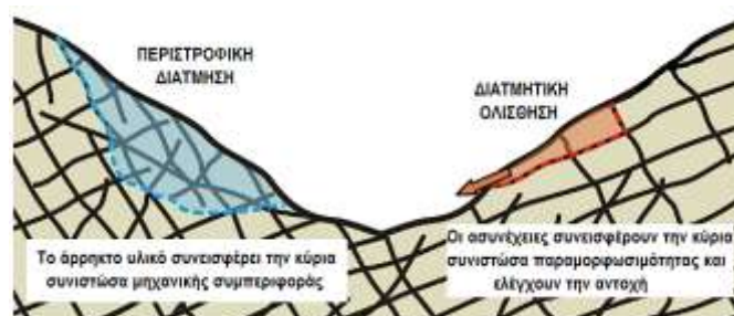
Σχήμα 1.11 : Επίδραση του βαθμού κερματισμού και του προσανατολισμού των ασυνεχειών στην αντοχή βραχώμαζας
