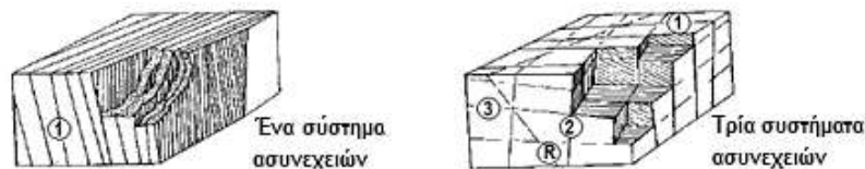
Σχήμα 1.6 : Ογκοδιαγράμματα στα οποία φαίνονται ο αριθμός συστημάτων ασυνεχειών και η επίδρασή τους στη μηχανική συμπεριφορά και στην εμφάνιση των βραχωδών μαζών
