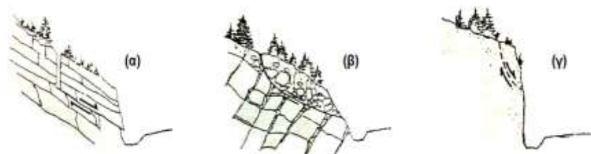
Σχήμα 1.10 : Παραδείγματα διατμητικής αστοχίας βραχωδών πρηνών
