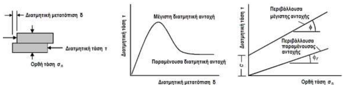
Σχήμα 2.11 : Διάτμηση λείας ασυνέχειας, αντοχή και περιβάλλουσες αστοχίας
