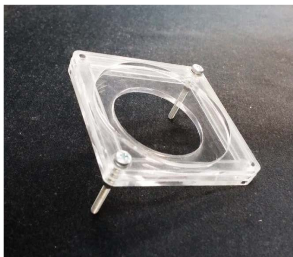
Εικόνα 5. Κατασκευή για την προσαρμογή φίλτρου υπέρυθρων στην κάμερα.
