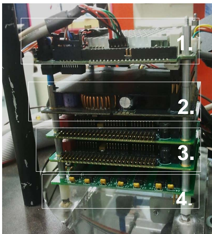
Εικόνα 17. Πύργος PC/104 εγκατεστημένος στο ρομπότ.
