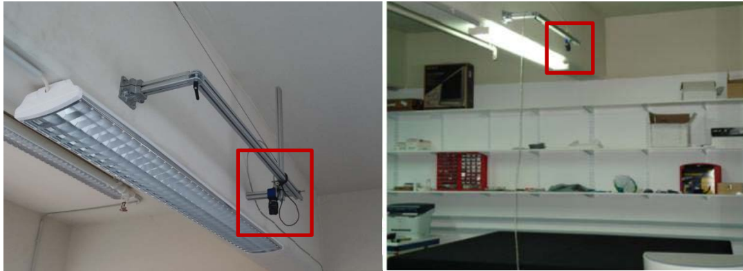
Εικόνα 3. Η ανάρτηση και η θέση της κάμερας στον εξομοιωτή.
