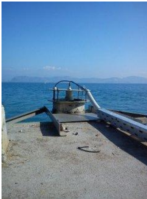
Εικόνα 9.13: Ηλεκτρονικός μετρητής χλωριών και κυματισμών της θάλασσας (μέτρηση υψομετρικής διαφοράς νερού θάλασσας και πηγής)
