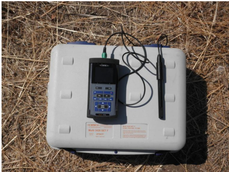
Σχήμα 8.1: Πολυπαραμετρικό όργανο μέτρησης pH, ειδικής ηλεκτρικής αγωγιμότητας και θερμοκρασία
