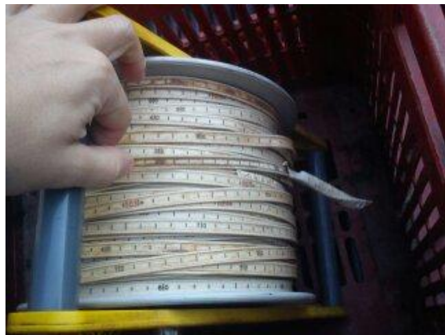
Εικόνα 2: Σταθμήμετρο (με πατέντα στην άκρη ώστε να μην κολλάει στο στόμιο της γεωτρησης)
