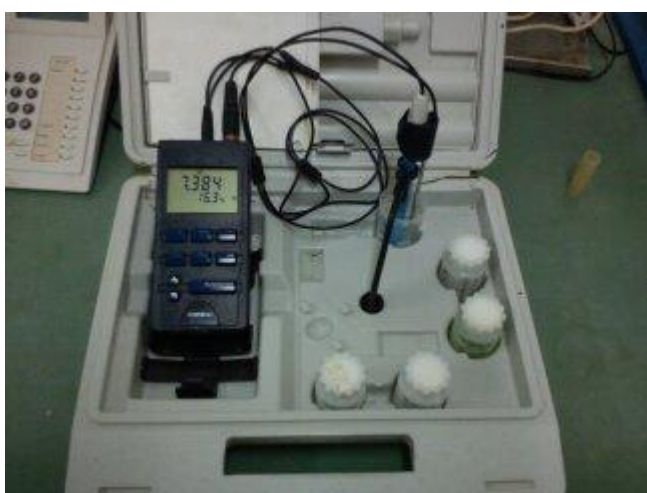
Εικόνα 12.1: Πολυπαραμετρικό όργανο μέτρησης ειδικής ηλεκτρικής αγωγιμότητας, θερμοκρασίας και pH
