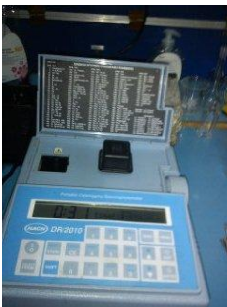
Εικόνα 12.2: Φασματογράφος (υπολογισμός με κατάλληλα αντιδραστήρια θειικών και νιτρικών ιόντων)
