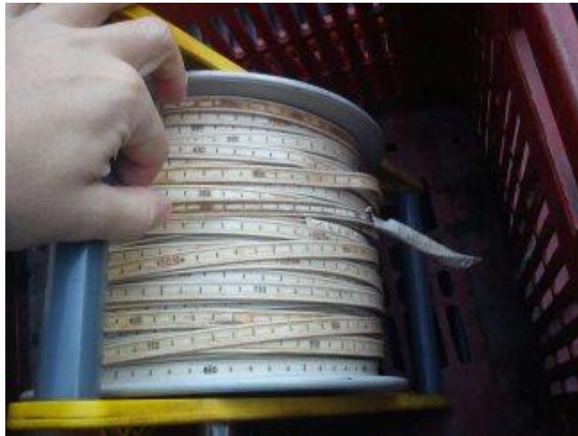
Σχήμα 4.6: Σταθμήμετρο (με πατέντα στην άκρη ώστε να μην κολλάει στο στόμιο της γεώτρησης)
