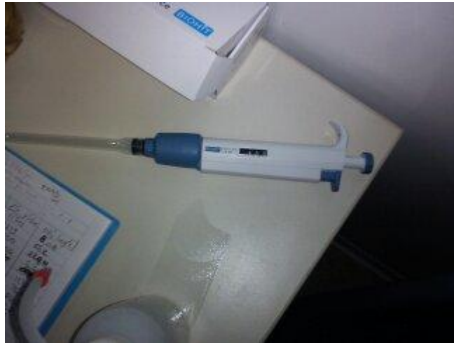
Εικόνα 12.3: Πιπέτα (ακριβή δειγματοληψία και διανομή υγρών όγκων)
