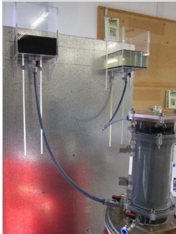
Σχήμα 2.49. Πειραματική διάταξη που χρησιμοποιήθηκε για τις δοκιμές εισπίεσης υγρολύματος κολλοειδούς πυριτίας σε εδαφικά δοκίμια άμμου M31 και ιλυώδους άμμου M31 - D6. Στο σχήμα φαίνεται ένα δοκίμιο άμμου M31 ύψους 20 cm, καθώς το χρωματισμένο υγρόλυμα εισρέει από τη βάση της στήλης και εκρέει από την κορυφή. Η εισπίεση έγινε υπό χαμηλή υδραυλική κλίση 0.05 και διαπιστώθηκε ότι το πυκνότερο υγρόλυμα αντικαθιστά το ελαφρύτερο νερό των πόρων. Το Σχήμα είναι από το παραδοτέο του ερευνητικού Θαλής – Π.Θ.( MIS 375618).
