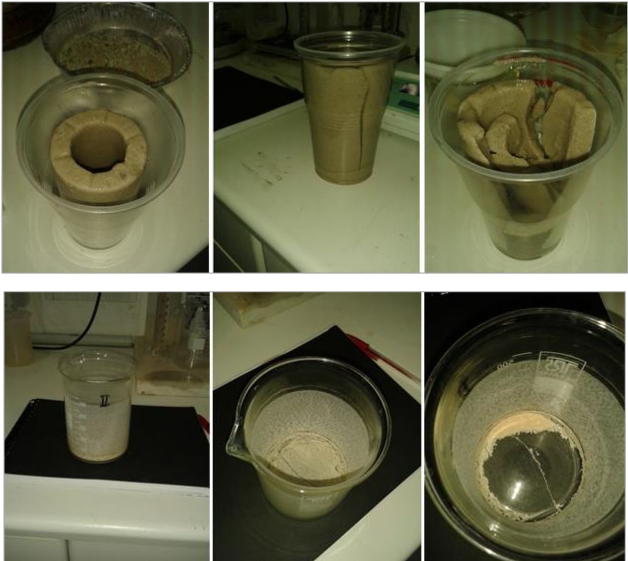
Σχήμα 2.55. Η εξέλιξη της αποσύνθεσης του σταθεροποιημένου δοκιμίου άμμου M31 κατά την πρώτη δοκιμή εμφάπτισης. Η αναχαίτιση της ωρίμανσης οφείλεται στη διάχυση της πυριτίας και του αλατιού, ενώ η αποσύνθεση πιθανώς να προκύπτει από την οσμωτική πίεση. Επάνω αριστερά: εξαλλοίωση της εξωτερικής επιφάνειας και απώλεια σιβαρότητας μετά το πέρας της πέμπτης εμφάπτισης. Επάνω στη μέση: εμφάνιση ρωγμής στο δοκίμιο κατά την αφαίρεση του νερού στο τέλος της έβδομης εμφάπτισης. Επάνω δεξιά: ολοκληρωτική διάλυση δοκιμίου στο πέρας της ένατης εμφάπτισης. Κάτω: Η διαχεόμενη πυριτία και το αλάτι που αποκαλύπτεται μετά την απομάκρυνση του νερού.
