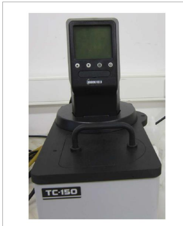
Σχήμα 2.14. Περιστροφικό ιξωδόμετρο Brookfield LVDV-II+PX. Σχήμα από παραδοτέο του ερευνητικού Θαλής – Π.Θ.( MIS 375618).
