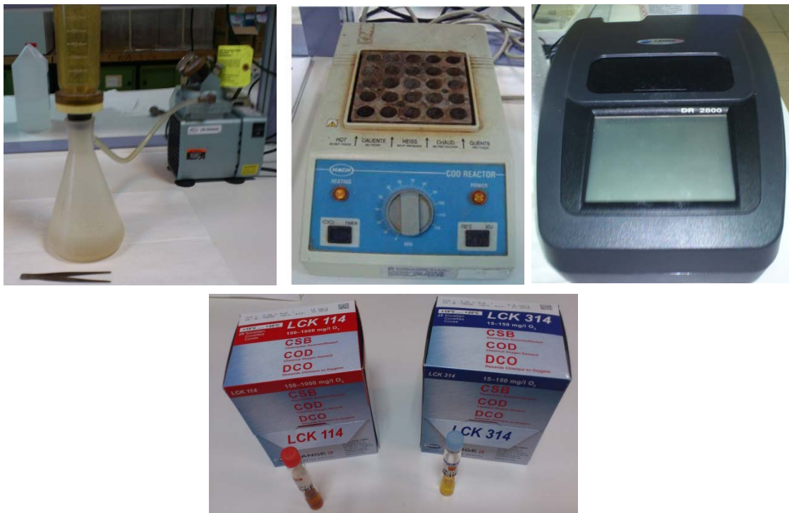
Σχήμα 3.5 Προσδιορισμός COD : συσκευή αντλίας κενού, χωνευτής, φασματοφωτόμετρο, αντιδραστήρια (από αριστερά προς τα δεξιά και από πάνω προς τα κάτω)
