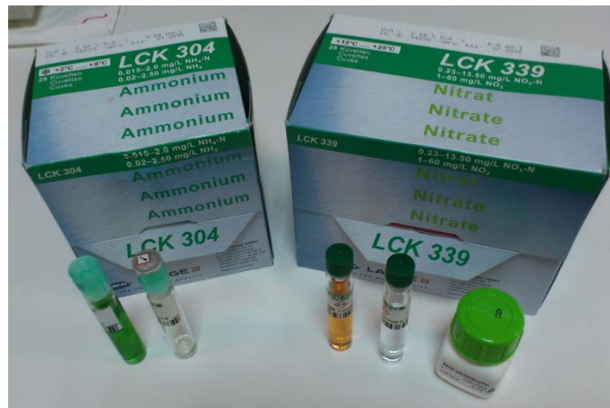
Σχήμα 3.10 Αντιδραστήρια της Hach για τη μέτρηση του αμμωνιακού αζώτου (αριστερά) και του νιτρικού αζώτου (δεξιά)
