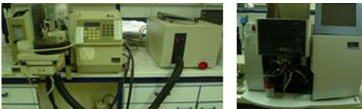
Σχήμα 3.9 Φούρνος γραφίτη AAS Perkin Elmer 3110/HGA600 και AAS φλόγας Perkin Elmer Analyst 200 (από αριστερά προς τα δεξιά)
