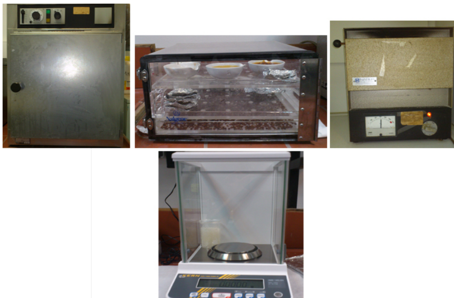
Σχήμα 3.4 Προσδιορισμός στερεών : φούρνος 103 °C, ξηραντήρας, φούρνος 550 °C και ζυγός ακριβείας (από αριστερά προς τα δεξιά και από πάνω προς τα κάτω)
