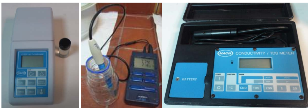
Σχήμα 3.7 Θολόμετρο, pH-μετρο και αγωγιμόμετρο
