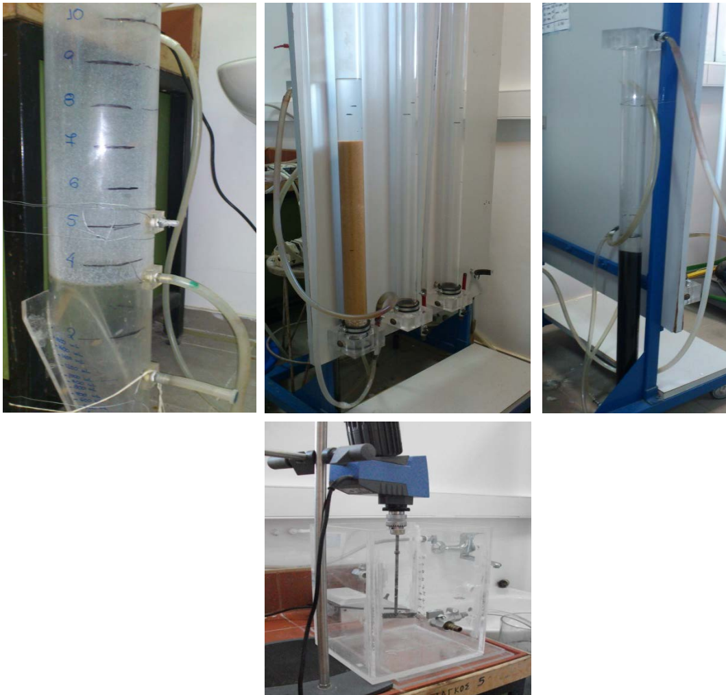
Σχήμα 3.1 Εγκατάσταση επεξεργασίας γκρίζου νερού (Πάνω αριστερά : δεξαμενή καθίζησης· Πάνω κέντρο : φίλτρο άμμου· Πάνω δεξιά : φίλτρο ενεργού άνθρακα· Κάτω κέντρο : δεξαμενή κροκίδωσης)
