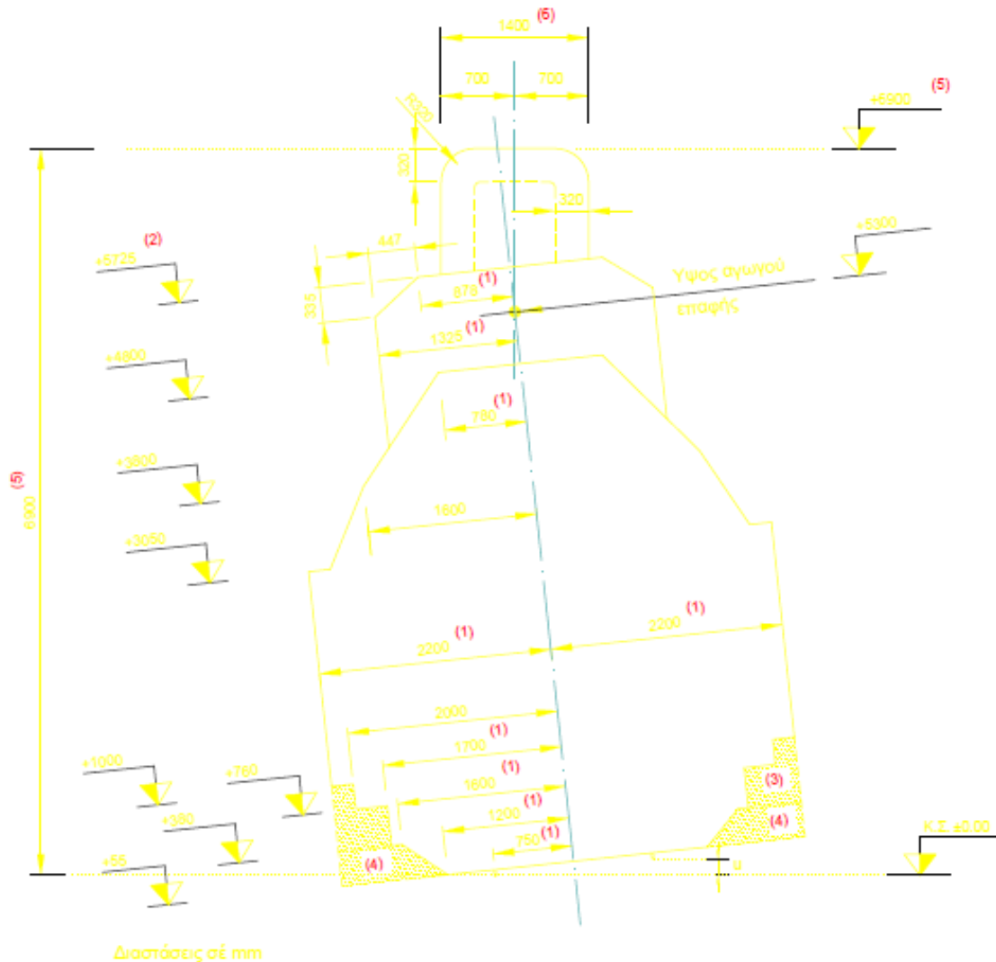
Σχήμα 7.2.1. Περιτύπωμα σε καμπύλη εντός σηράγγων
