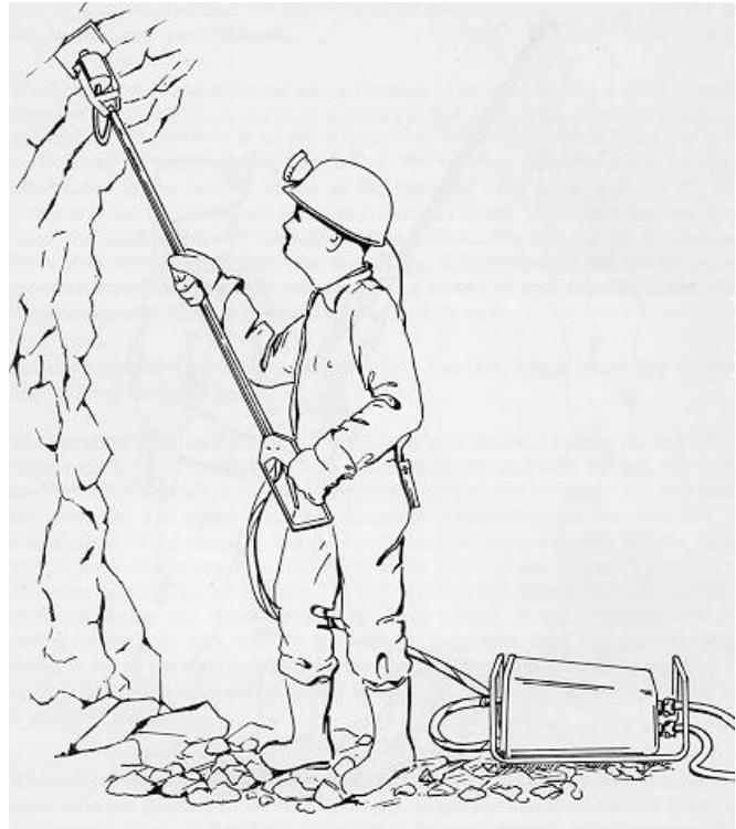
Σχήμα 6.1.13. Τοποθέτηση ήλου Swellex®
