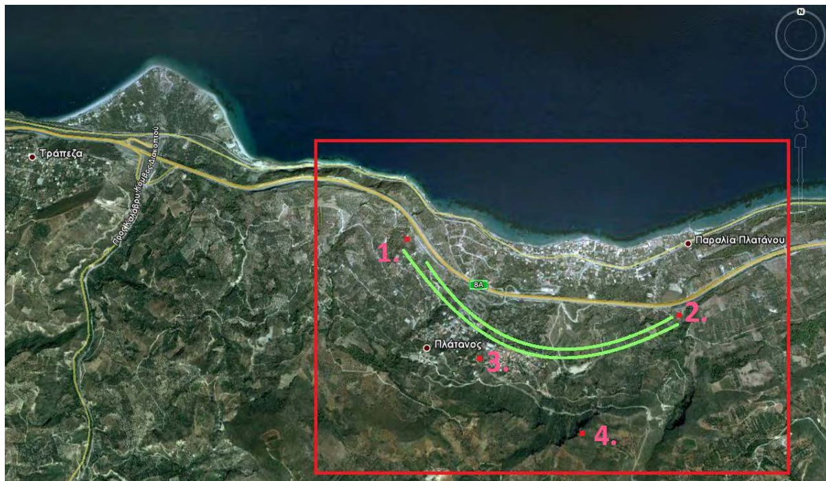
Σχήμα 7.1.3. Δορυφορική εικόνα όπου σε κόκκινο πλαίσιο περικλείεται η περιοχή μελέτης. Υποδεικνύονται (1) η δυτική και (2) η ανατολική είσοδος της σήραγγας, (3) το χωριό «Πλάτανος» και (4) το υψηλότερο σημείο της περιοχής μελέτης (426m). Οι πράσινες γραμμές παρουσιάζουν την υπό κατασκευή σήραγγα.
