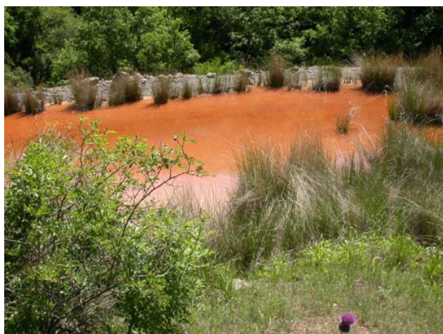
Εικόνα 3.6 Όξινη απορροή στην έξοδο της στοάς 4. Διακρίνονται οι αποθέσεις κολλοειδών συσσωματωμάτων κυρίως από υδροξειδία του σιδήρου (Λιακόπουλος, 2009)
