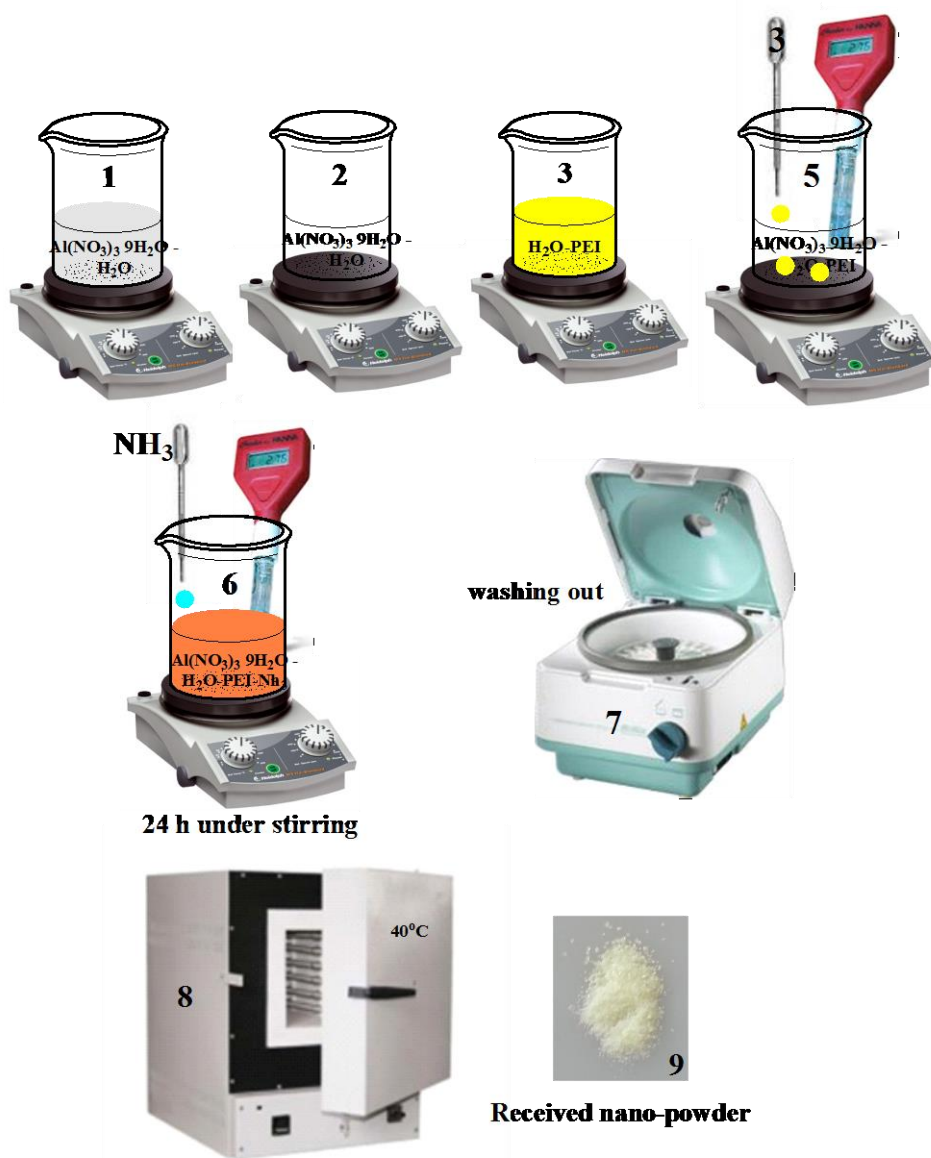
Εικόνα 3.2: Σχηματική απεικόνιση πειραματικής διαδικασίας.
