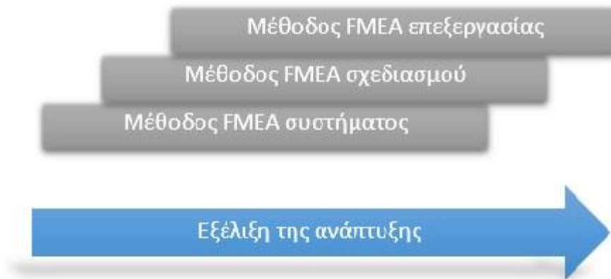
Σχήμα 7.1 Η μέθοδος FMEA χωρισμένη σε υποδιαδικασίες
