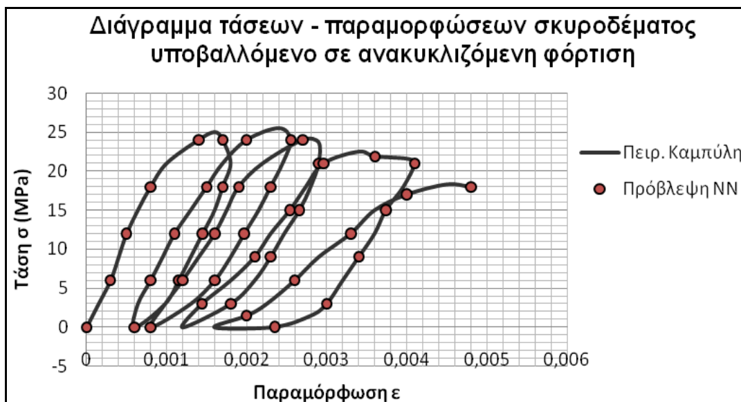
Διάγραμμα 4.12: Πρόβλεψη NN για την καμπύλη \sigma - \varepsilon σκυροδέματος σε μονοαξονική συμπίεση
