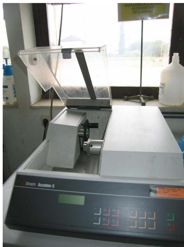
Εικόνα 3.2: Λεπτοτόμος Accutom – 5 (Εργαστήριο Μεταλλογραφίας - Κ.Δ.Ε.Π.)
