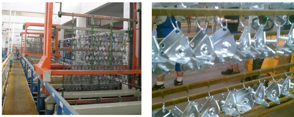
Εικόνα 1.12: Γαλβανισμός ηλεκτροαπόθεσης με χρήση κινητών βάσεων (rack plating)
