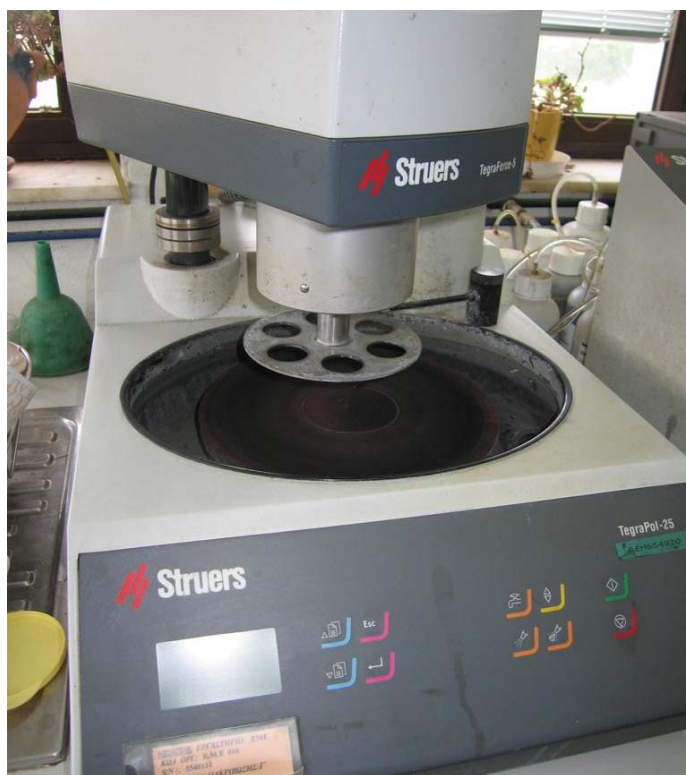
Εικόνα 3.4: Συσκευή αυτόματης λείανσης – στίλβωσης TegraPol – 25 της Struers (Εργαστήρια Τομέα Μηχανικών, Μεταλλουργικών Δοκιμών και Ελέγχων – Κ.Δ.Ε.Π.)
