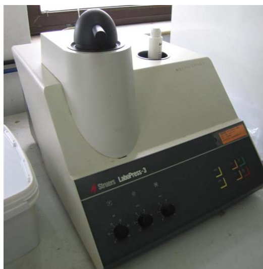
Εικόνα 3.12: Συσκευή εγκιβωτισμού LaboPress – 3 της Struers
