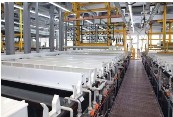
Εικόνα 1.13: Βιομηχανικές εγκαταστάσεις για Γαλβανισμό ηλεκτροαπόθεσης με χρήση κινητών βάσεων (rack plating)
