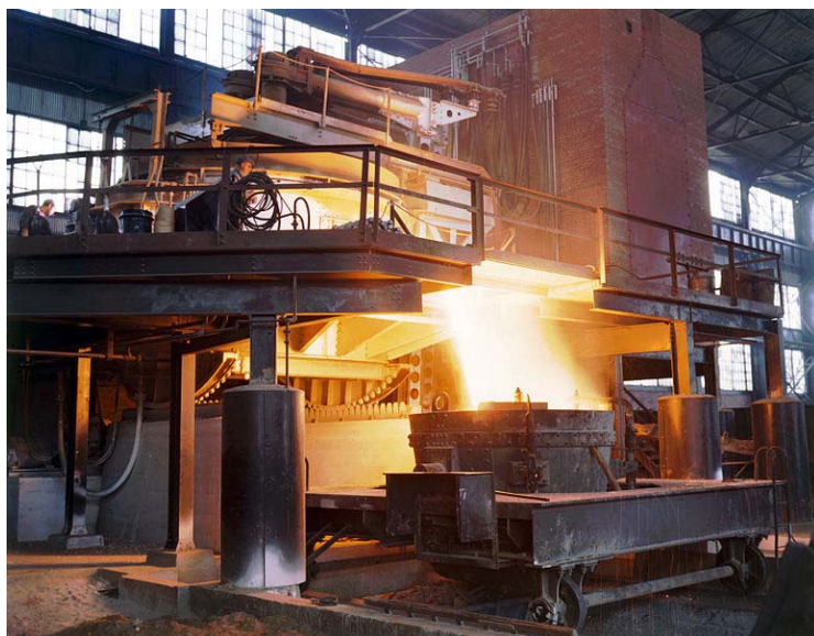
Εικόνα 1.2. Απόχυση τηγμένου χάλυβα από κάμινο ηλεκτρικού τόξου σε αμερικανικό χαλυβουργείο (περί το 1941).
