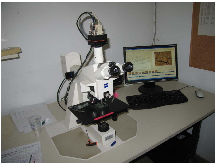
Εικόνα 3.14: Μεταλλογραφικό Μικροσκόπιο Zeiss Axiotech HAL 100 (Εργαστήριο Μεταλλογραφίας Δ.Ε.Η. – Κ.Δ.Ε.Π.)
