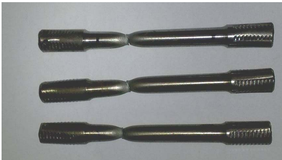
Εικόνα 4.12: Δοκίμια χωρίς επιψευδαργύρωση μετά τη θραύση (χαρακτηριστική μορφή «κώνου – κρατήρα»)
