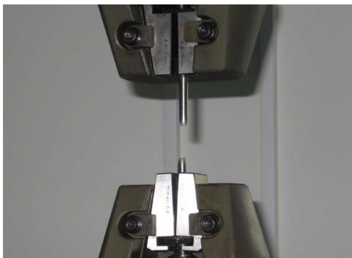
Εικόνα 4.11: Δοκίμιο Νο6 (χωρίς επιψευδαργύρωση) μετά τη θραύση του
