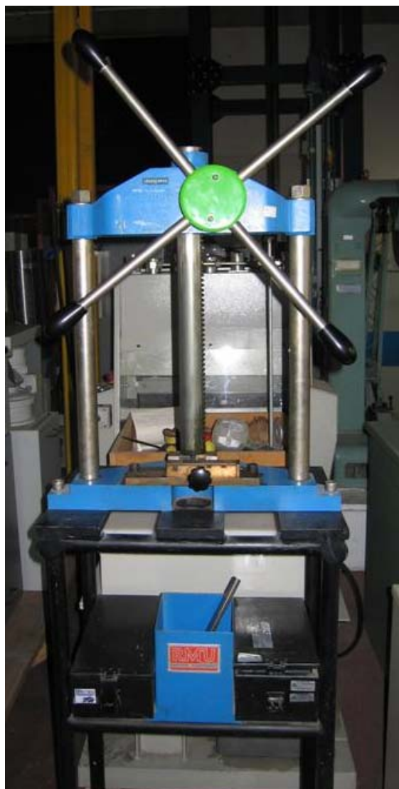
Εικόνα 3.16: Συσκευή RMU για την διαμόρφωση εγκοπής «V» σε δοκίμια κρούσης (Εργαστήριο Αντοχής Υλικών Δ.Ε.Η. – Κ.Δ.Ε.Π.)
