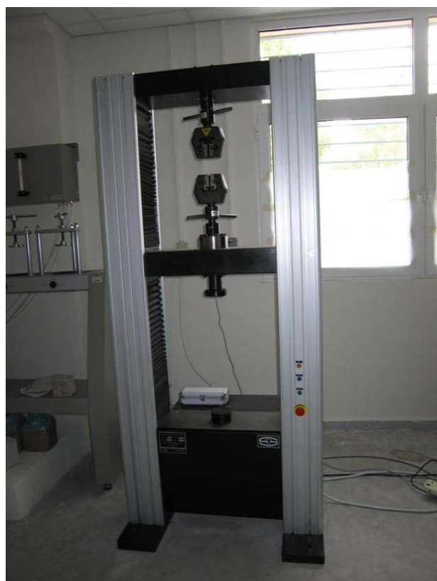
Εικόνα 3.15: Μηχανή Εφελκυσμού WDW – 50E (Εργαστήριο Τεχνολογίας Κονιαμάτων της Σχολής Χημικών Μηχανικών Ε.Μ.Π.)
