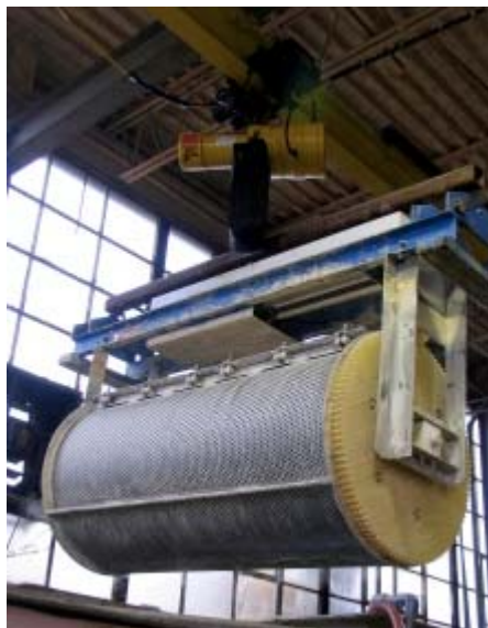
Εικόνα 1.14: Γαλβανισμός ηλεκτροαποθεσης με χρήση περιστρεφόμενου τυμπάνου (barrel plating)
