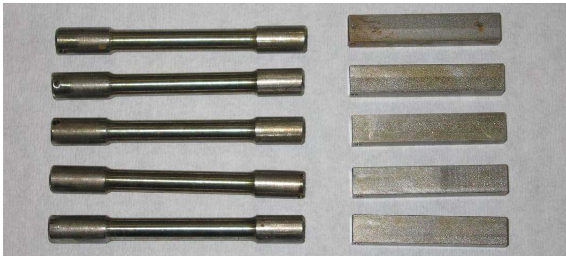
Εικόνα 3.3: Δοκίμια εφελκυσμού και κρούσης (Υλικό St37)
