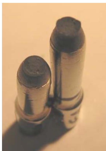
Εικόνα 4.17: Επιφάνεια θραύσης δοκιμίου ΕΑ (πάχος επιψευδαργύρωσης 51 \mu\text{m} ) (χαρακτηριστική μορφή «κώνου – κρατήρα»)
