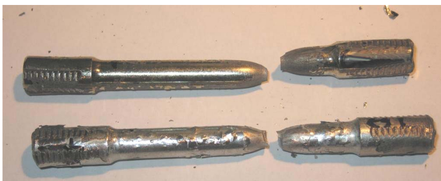
Εικόνα 4.15: Επιψευδαργγρωμένα δοκίμια μετά τη δοκιμή εφελκυσμού
