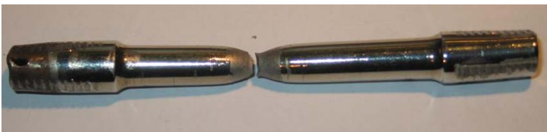
Εικόνα 4.16: Δοκίμιο EA μετά τη δοκιμή εφελκυσμού
