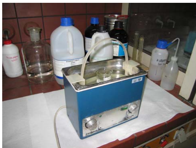
Εικόνα 3.6: Συσκευή καθαρισμού υπερήχων (Εργαστήριο Χημικών Μηχανικών Ε.Μ.Π.)
