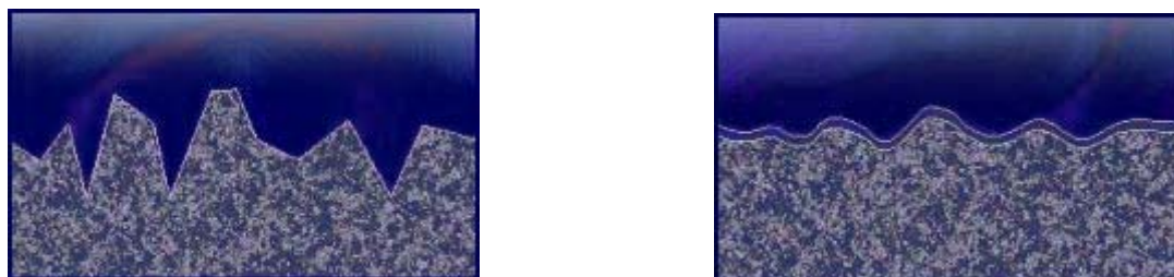
Σχήμα 1.10: Επιφάνεια πριν και μετά την ηλεκτροσίλβωση
