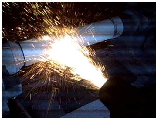
Εικόνα 1.15: Γαλβανισμός με ψεκασμό ψευδαργύρου
