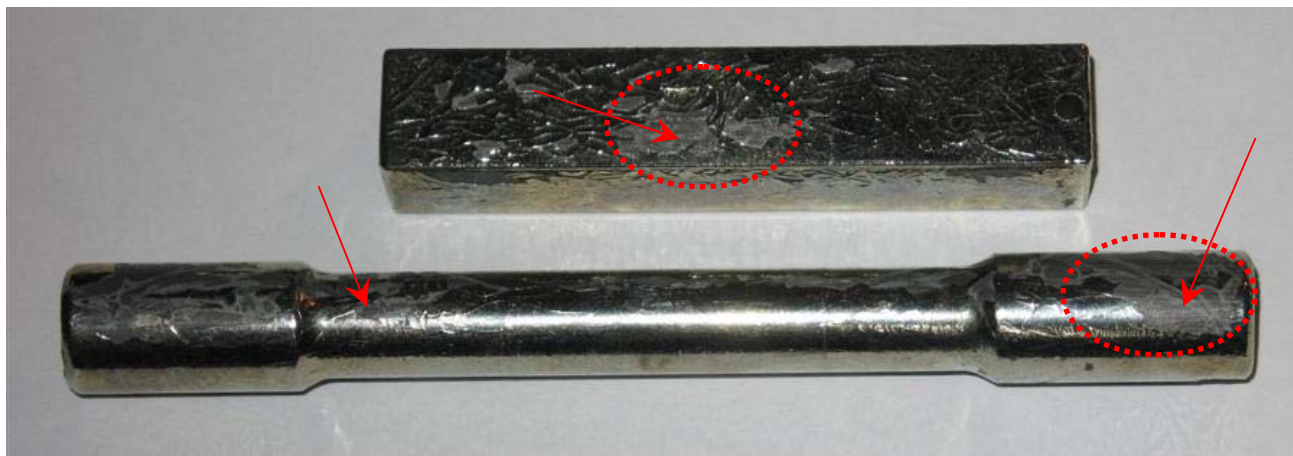
Εικόνα 4.2: Επιψευδαργυρωμένα δοκίμια εφελκυσμού και κρούσης (χρόνος απόθεσης 45min, μέθοδος επιψευδαργύρωσης – βιομηχανική «barrel plating»)
