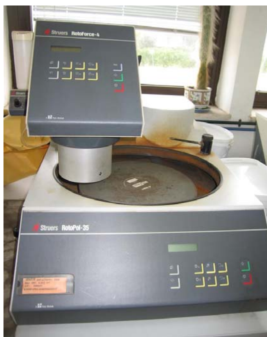
Εικόνα 3.5: Συσκευή αυτόματης λείανσης – στίλβωσης RotoPol – 35 της Struers (Εργαστήρια Τομέα Μηχανικών, Μεταλλουργικών Δοκιμών και Ελέγχων – Κ.Δ.Ε.Π.)
