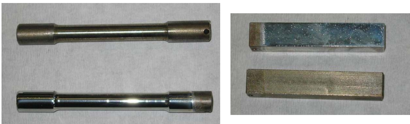
Εικόνα 3.11: Φωτογραφία δοκιμίων πριν και μετά την επιμεταλλώση
