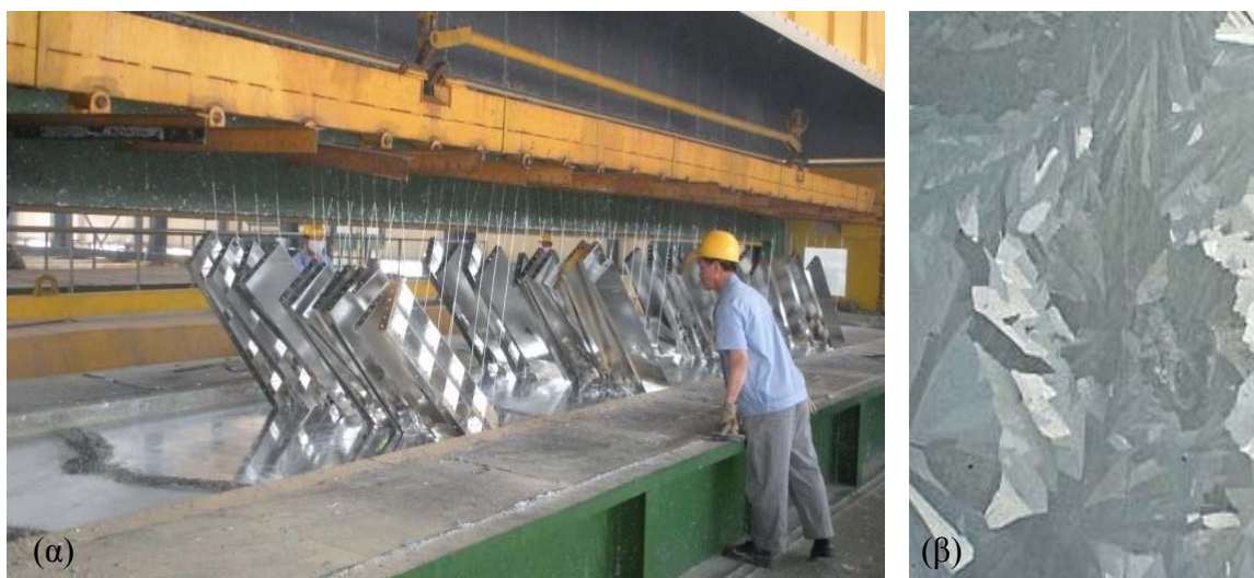
Εικόνα 1.11: (α) Γαλβανισμός εν θερμώ, (β) Επιφάνεια γαλβανισμένου αντικειμένου εν θερμώ
