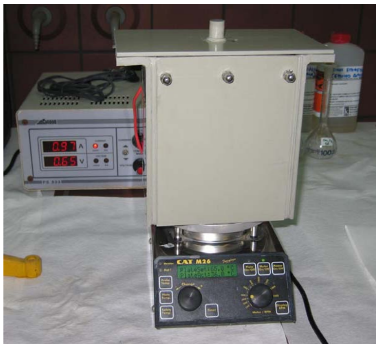
Εικόνα 3.7: Ηλεκτρολυτικό κελί επιψευδαργύρωσης (Εργαστήριο Χημικών Μηχανικών Ε.Μ.Π.)
