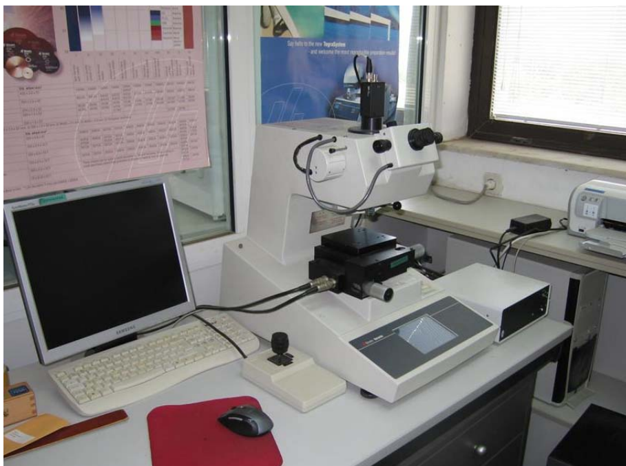
Εικόνα 3.18: Μικροσκληρόμετρο Struers, μοντέλο Duramin – 10/20 (Εργαστήριο Μεταλλογραφίας Δ.Ε.Η. – Κ.Δ.Ε.Π.)
