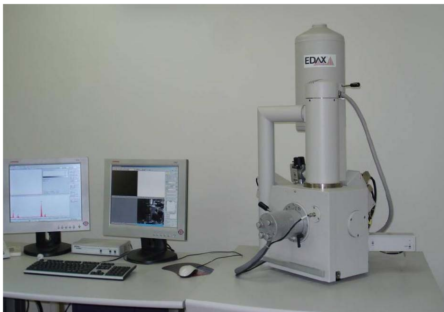
Εικόνα 3.13: S.E.M. FEI – QUANTA 200 Με σύστημα μικροανάλυσης EDAX (Σχολή Χημικών Μηχανικών Ε.Μ.Π.)
