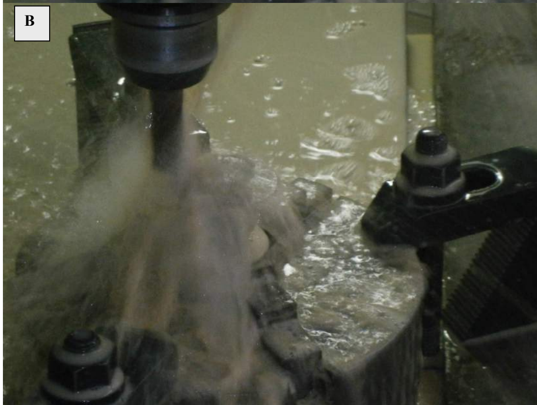
Σχήμα 7.35: Εκχόνδριση με εργαλείο διαμέτρου 16 mm επίπεδης απόληξης: (A) Αρχικό και (B) Προχωρημένο Στάδιο της Εργασίας.
