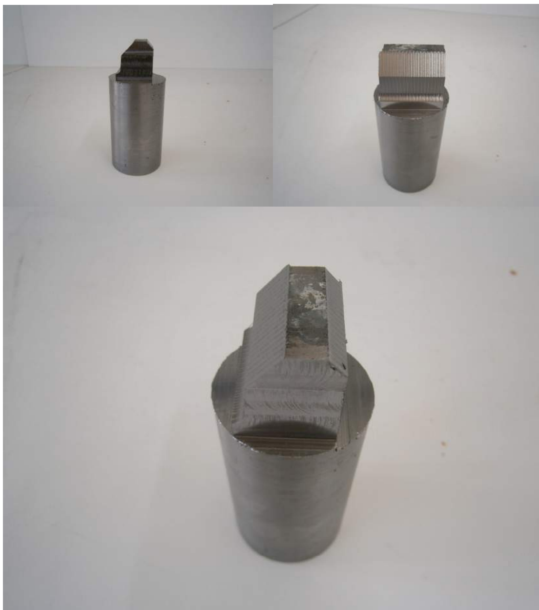
Σχήμα 7.33: Βάση για τη Στερέωση του Τεμαχίου στη Δεύτερη Φάση της Κατεργασίας.
