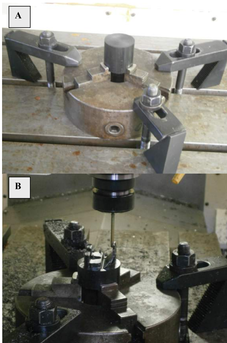
Σχήμα 7.22: Δοκιμαστικό Τεμάχιο: (Α) Στερέωση, (Β) Κατεργασία.
