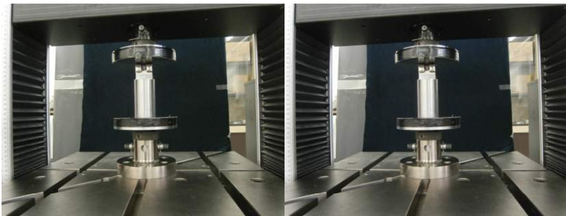
Σχήμα 9.7: Στατική Θλίψη Τεμαχίου με Μέγιστο Φορτίο τα 5 kN (έναρξη & λήξη).
