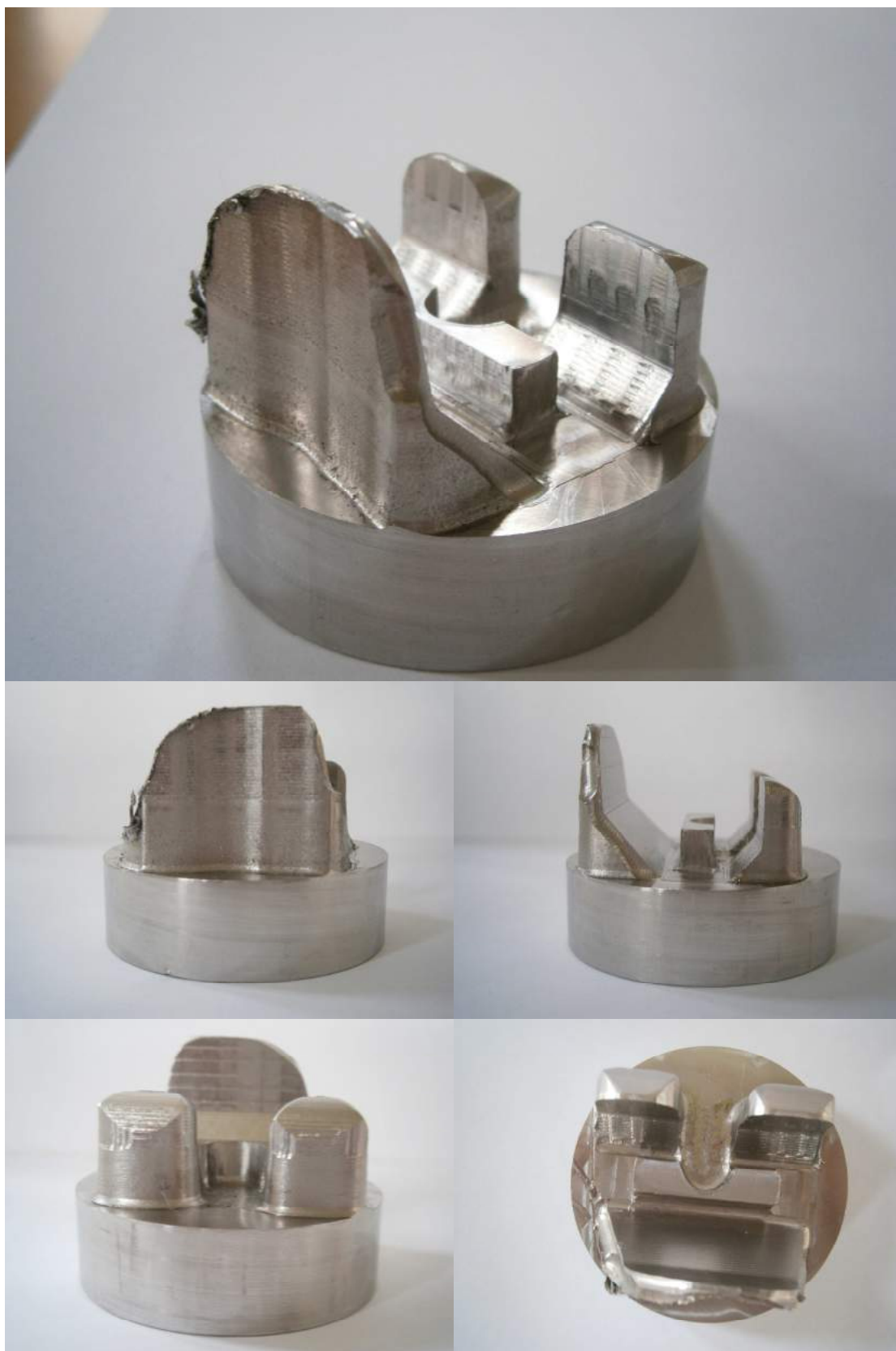
Σχήμα 7.32: Τεμάχιο μετά την Πρώτη Φάση της Κατεργασίας.
