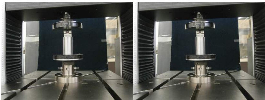
Σχήμα 9.8: Στατική Θλίψη Τεμαχίου με Μέγιστο Φορτίο τα 10 kN (έναρξη & λήξη).
