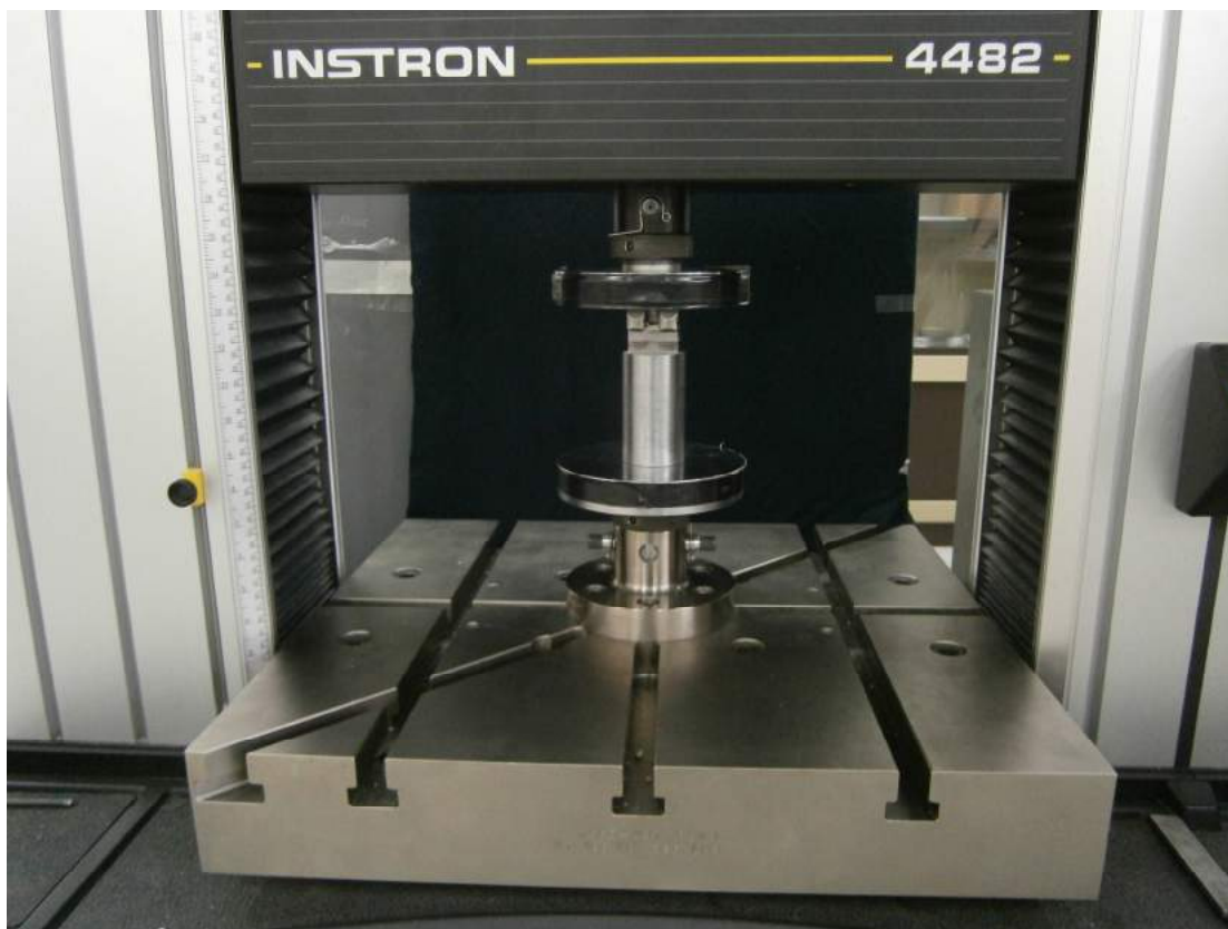
Σχήμα 9.5: Τοποθέτηση Τεμαχίου στην Πρέσα.
