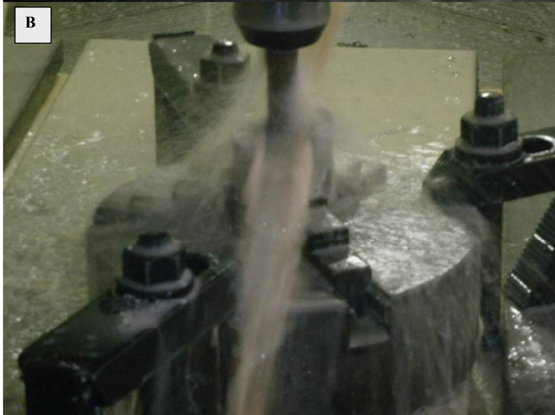
Σχήμα 7.24: Εκχόνδριση με τη Δημιουργία Θύλακα στο Αρχικό Τεμάχιο, με εργαλείο διαμέτρου 16 mm επίπεδης απόληξης: (A) Αρχικό και (B) Προχωρημένο Στάδιο της Εργασίας.
