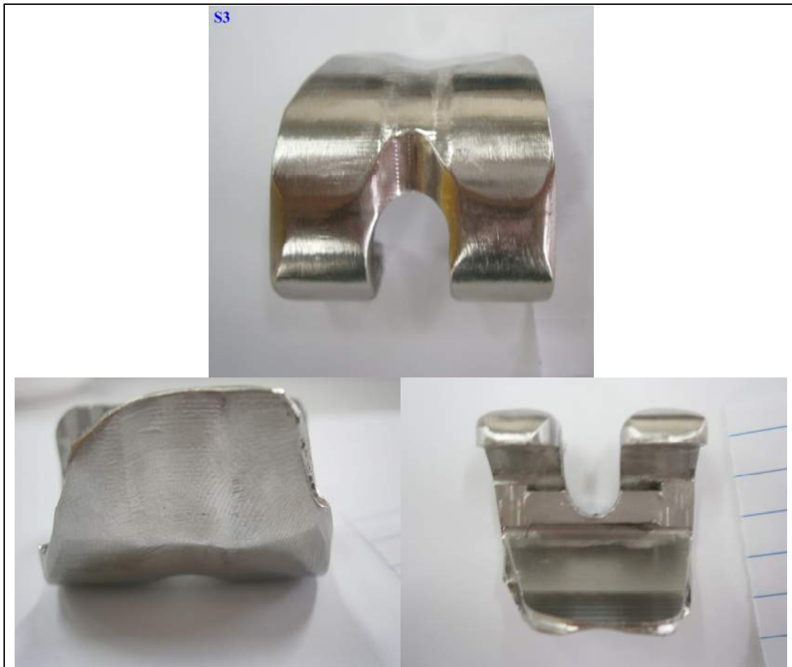
Σχήμα 9.4: Το Τεμάχιο S3 μετά τη Λείανση.
