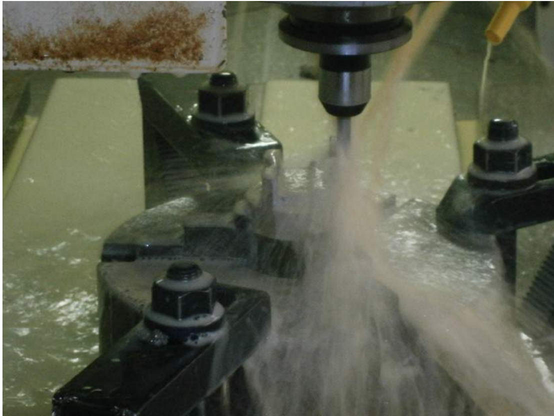
Σχήμα 7.27: Κοπή της Πρόσθιας Επιφάνειας του Εμφυτεύματος, με εργαλείο διαμέτρου 6 mm επίπεδης απόληξης.
