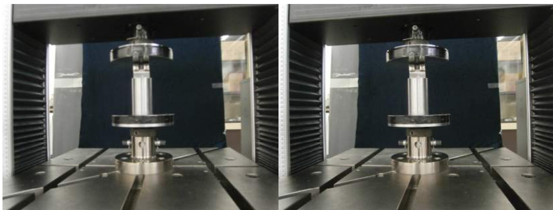
Σχήμα 9.10: Στατική Θλίψη Τεμαχίου με Μέγιστο Φορτίο τα 30 kN (έναρξη & λήξη).
