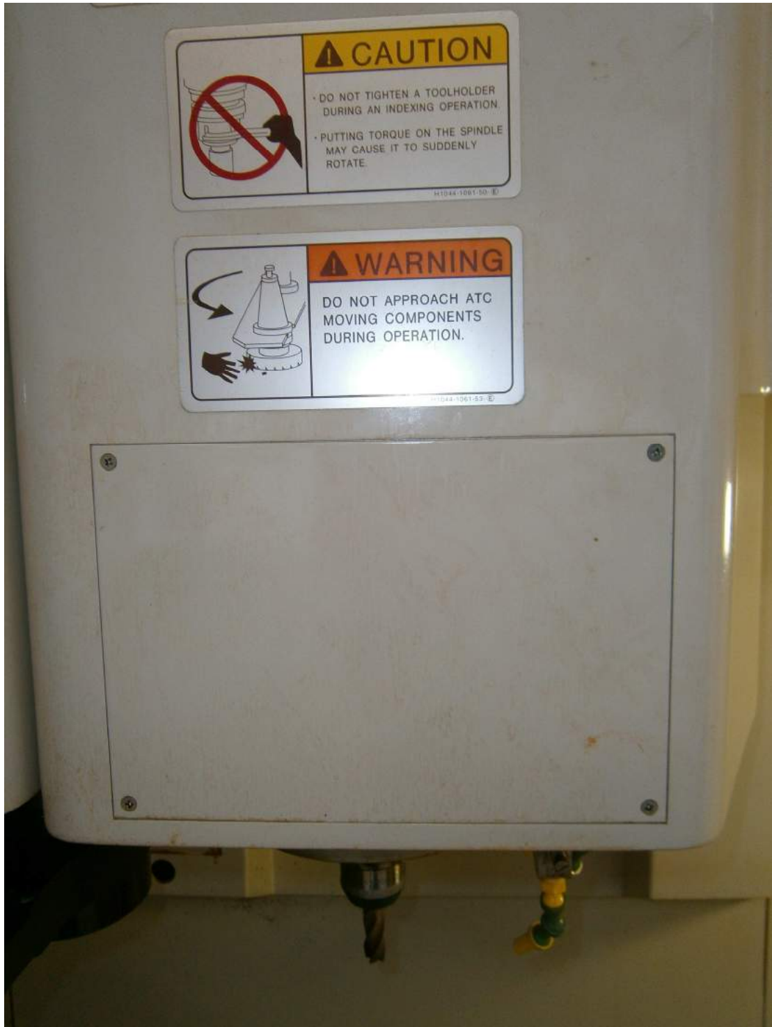
Σχήμα Π.2: Άτρακτος Εργαλειομηχανής OKUMA. Στο Άκρο της φέρει Κοπτικό Εργαλείο.
