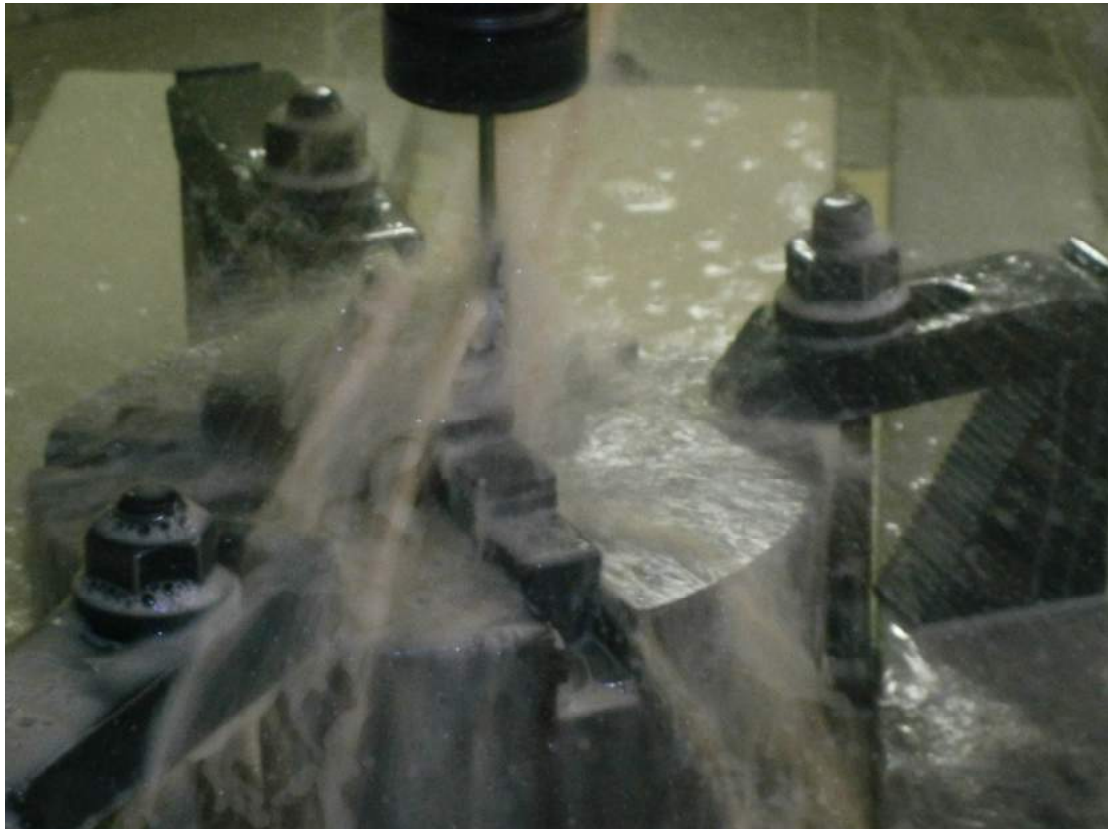
Σχήμα 7.30: Κοπή των Εσωτερικών Επιφανειών του Εμφυτεύματος, με εργαλείο διαμέτρου 4 mm σφαιρικής απόληξης.
