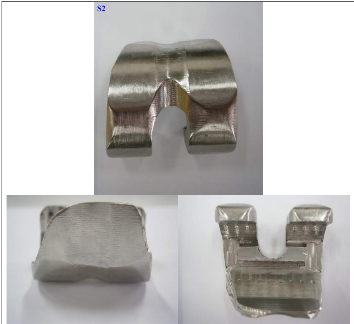
Σχήμα 9.3: Το Τεμάχιο S2 μετά τη Λείανση.
