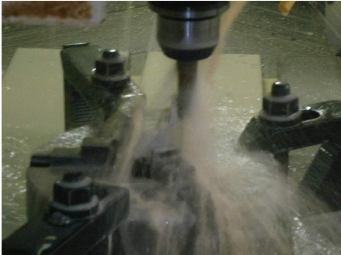
Σχήμα 7.25: Κοπή της Πρόσθιας Επιφάνειας του Εμφυτεύματος, με εργαλείο διαμέτρου 16 mm επίπεδης απόληξης.
