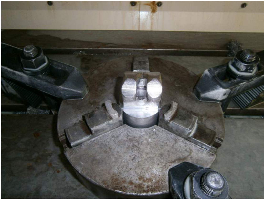
Σχήμα 7.38: Το Τεμάχιο μετά το Πέρασ της Κατεργασίας.
