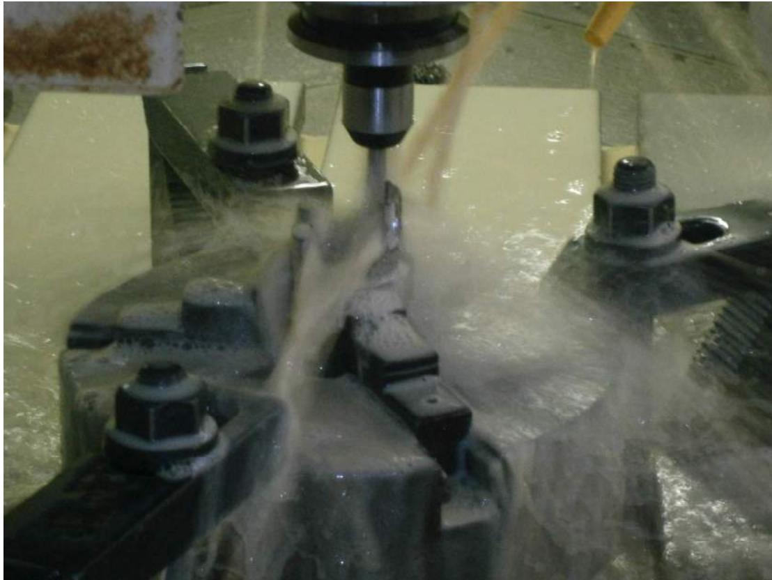
Σχήμα 7.29: Κοπή για την Απόδοση του Τελικού Σχήματος της Πρόσθιας Επιφάνειας του Εμφυτεύματος, με εργαλείο διαμέτρου 6 mm σφαιρικής απόληξης.
