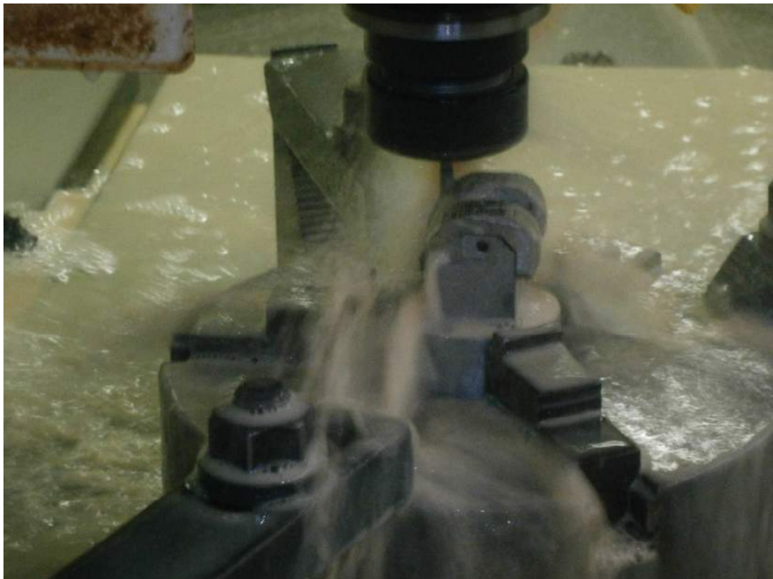
Σχήμα 7.37: Αποπεράτωση με εργαλείο διαμέτρου 4 mm σφαιρικής απόληξης.
