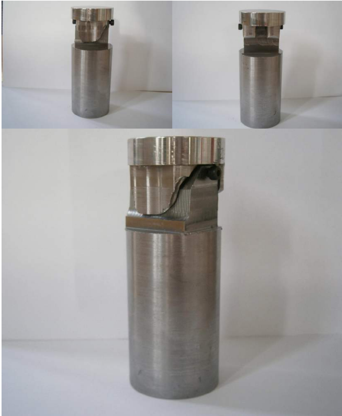
Σχήμα 7.34: Πρόσδεση του Τεμαχίου στη Βάση.
