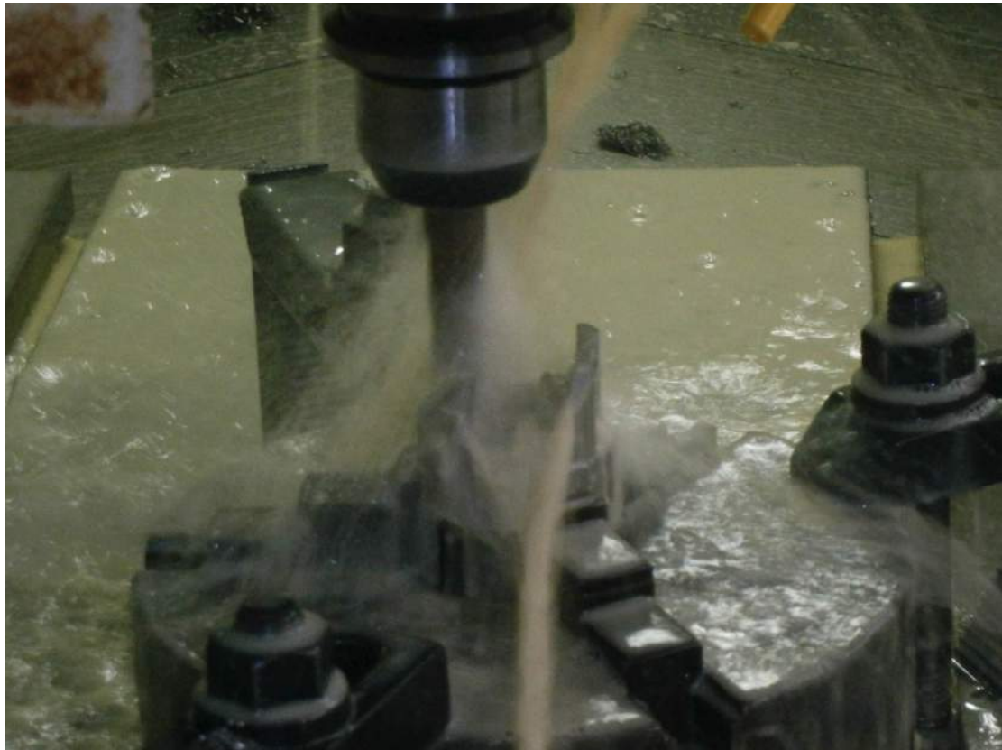
Σχήμα 7.26: Κοπή της Οπίσθιας Επιφάνειας του Εμφυτεύματος, με εργαλείο διαμέτρου 16 mm επίπεδης απόληξης.
