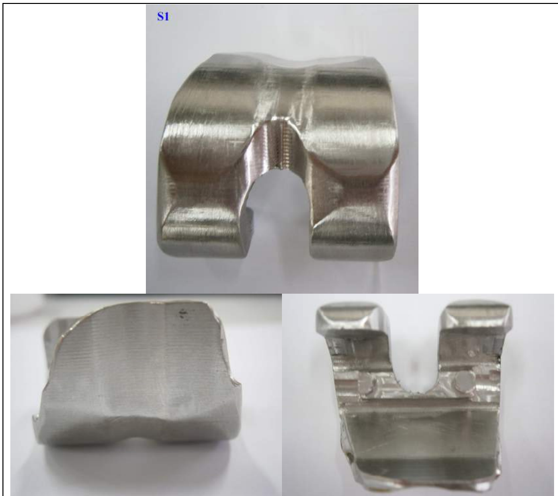
Σχήμα 9.2: Το Τεμάχιο S1 μετά τη Λείανση.
