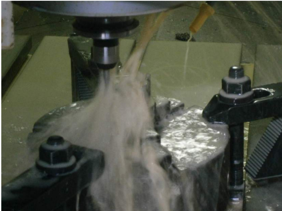
Σχήμα 7.28: Κοπή των Οπισθίων Επιφανειών του Εμφυτεύματος, με εργαλείο διαμέτρου 6 mm επίπεδης απόληξης.
