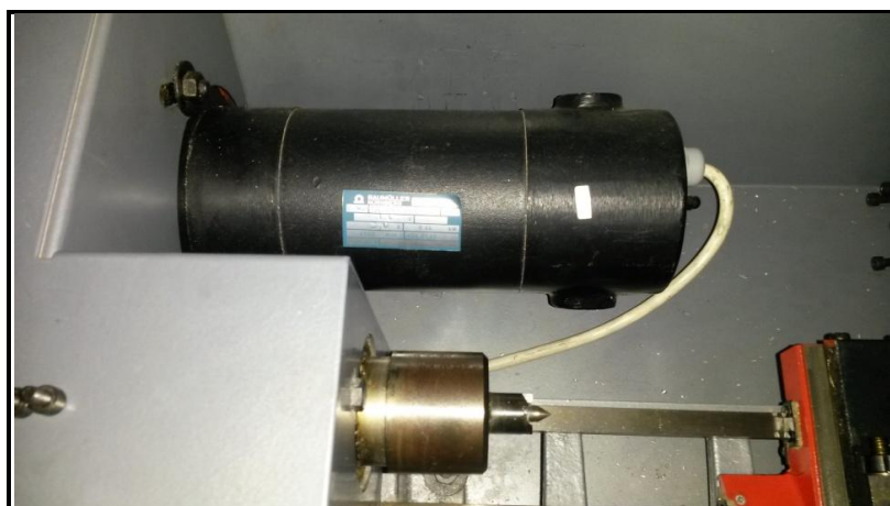
Εικόνα 10: Κύρια άτρακτος εργαλειομηχανής
