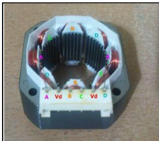
Εικόνα 55: Τυπική συνδεσμολογία πηνίων στάτη σε ένα unipolar κινητήρα
