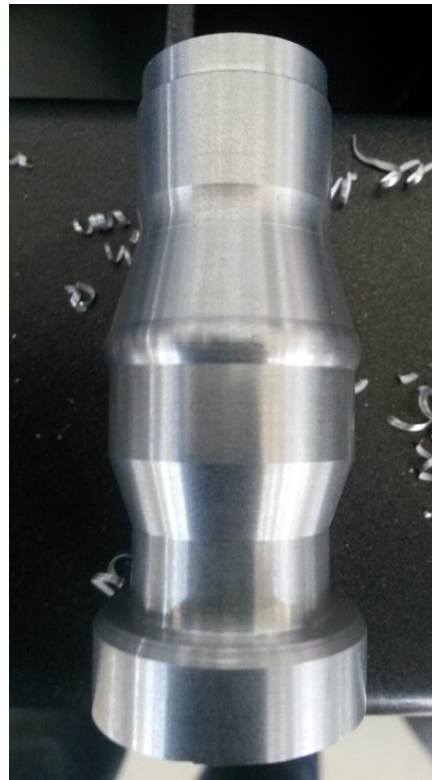
Εικόνα 71: Τελικό αποτέλεσμα τεμαχίου μετά την τόνρευση
