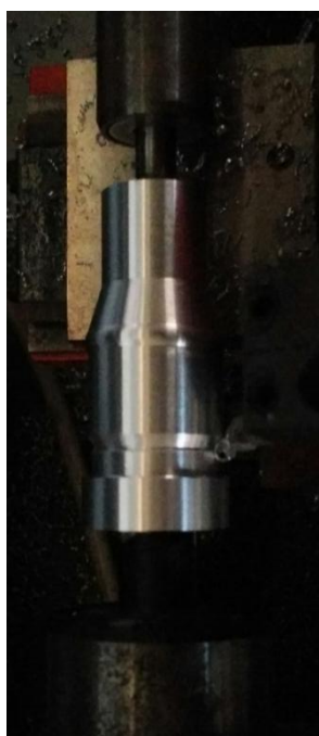
Εικόνα 68: Τοποθέτηση αρχικού τεμαχίου στην εργαλειομηχανή και συγκράτηση μέσω του κεντροφορέα
