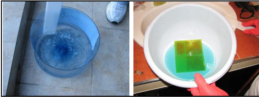
Εικόνα 40: Βασικό(αριστερά) και όξινο(δεξιά) διάλυμα που χρησιμοποιείται κατά την διαδικασία τύπωσης κατά το τρίτο και τέταρτο στάδιο
