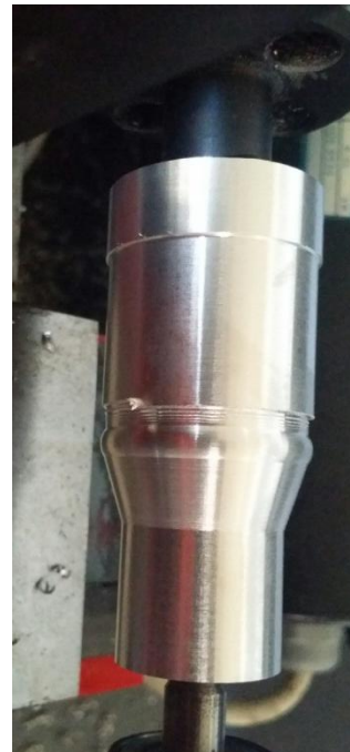
Εικόνα 68: Τοποθέτηση αρχικού τεμαχίου στην εργαλειομηχανή και συγκράτηση μέσω του κεντροφορέα
