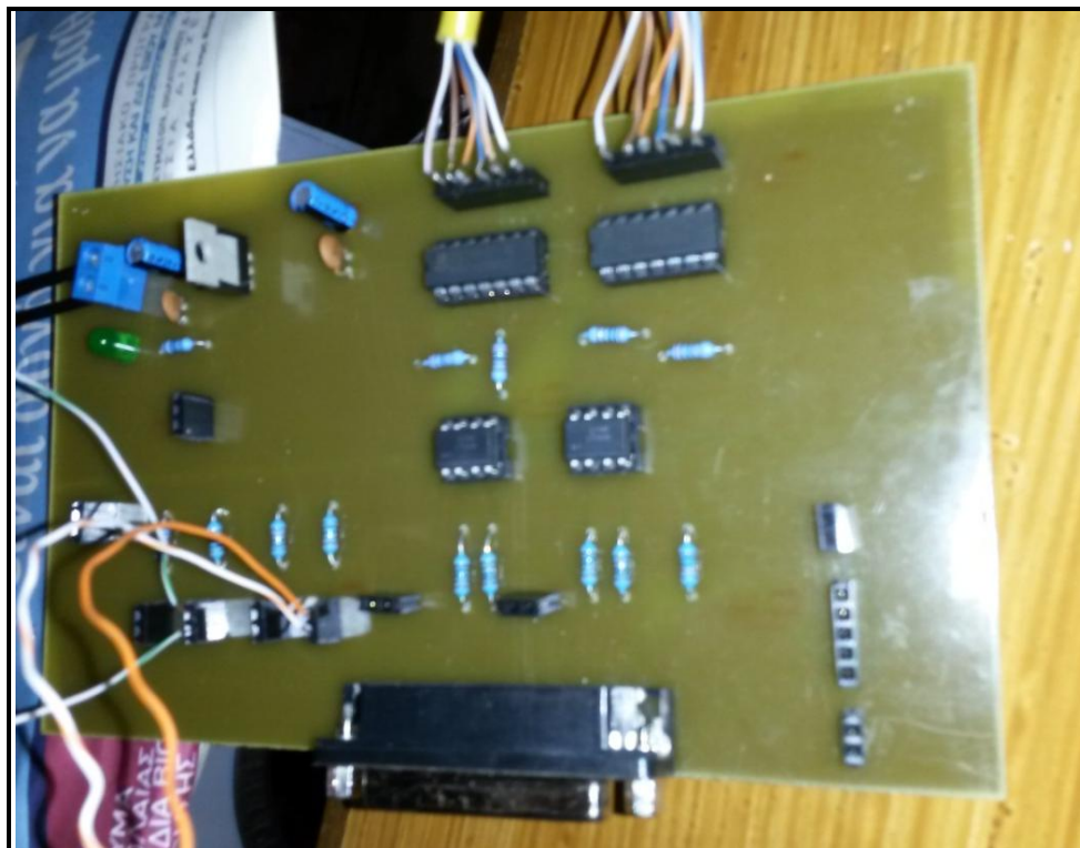
Εικόνα 58: Πλακέτα διαμόρφωσης σημάτων που δίνει η παράλληλη θύρα
