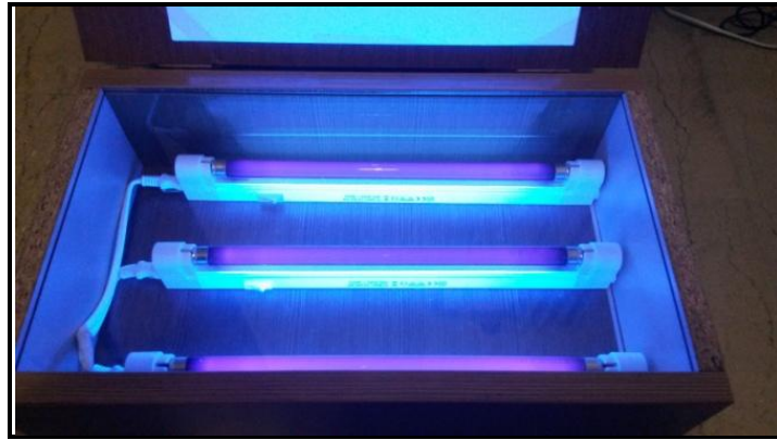
Εικόνα 39: Θάλαμος για ελεγχόμενη έκθεση σε υπέρυθρη ακτινοβολία
