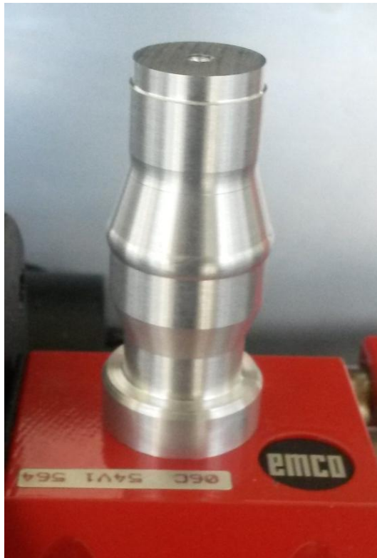
Εικόνα 71: Τελικό αποτέλεσμα τεμαχίου μετά την τόνρευση
