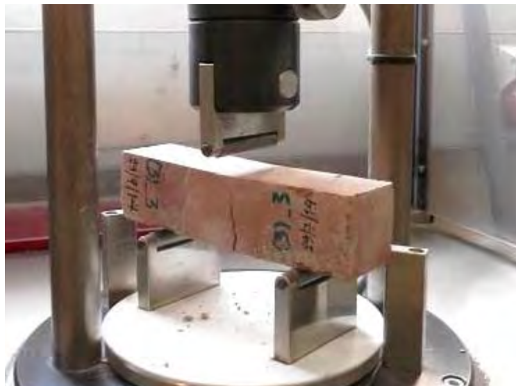
Εικόνα 4.37 Συσσκευή κάμψης ToniTechnik. Εικόνα 4.38 Δοκιμή κάμψης πηλοκονιαμάτων.
