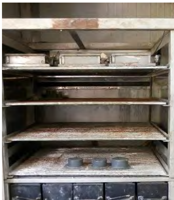
Εικόνα 4.25 Κάλυψη με γυάλινες πλάκες μετά τη διάστρωση. Εικόνα 4.26 Θάλαμος συντήρησης RH: 95%±5%.
