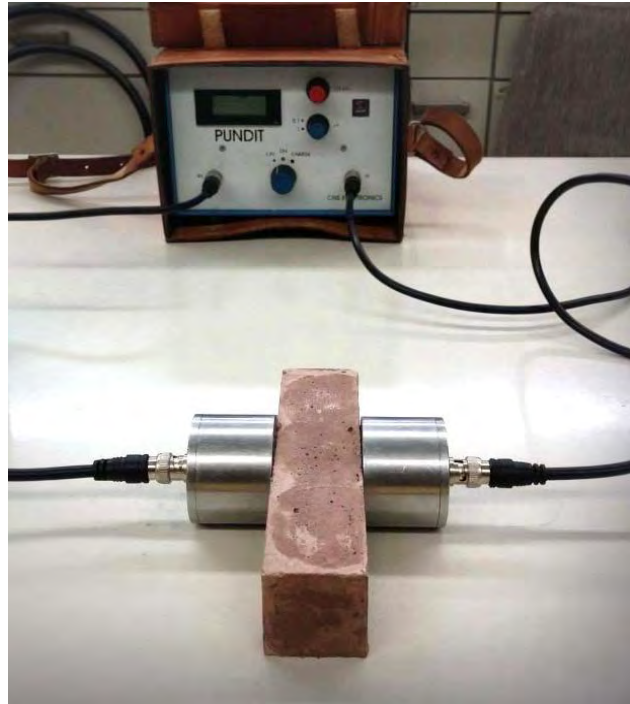
Εικόνα 4.35 Ράβδος βαθμονόμησης υπερηχοσκόπησης. Εικόνα 4.36 Μέτρηση ταχύτητας διάδοσης υπερήχων.
