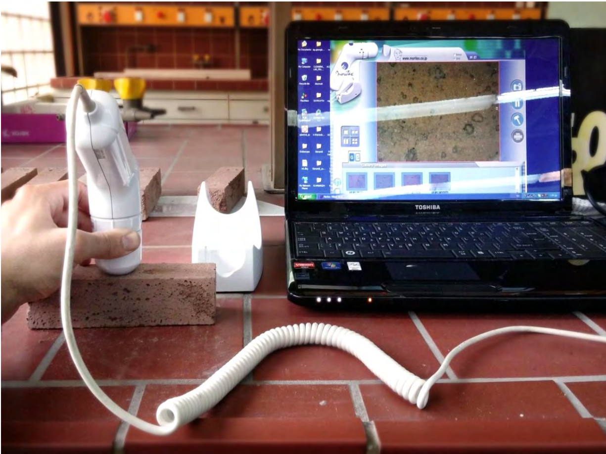
Εικόνα 4.27 Λήψη εικόνας με μικροσκόπιο οπτικών ινών και ταυτόχρονη καταγραφή σε Η/Υ.
