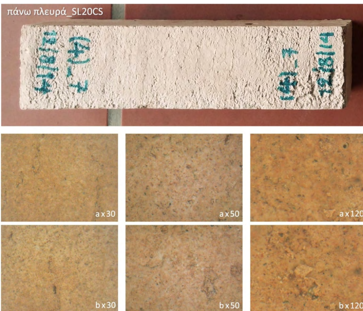
Εικόνα 5.10 Μορφολογία πάνω πλευράς σταθεροποιημένου δοκιμίου με 20% σκωρία κάδων χαλυβουργίας.
