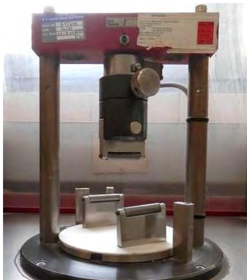
Εικόνα 4.37 Συσσκευή κάμψης ToniTechnik. Εικόνα 4.38 Δοκιμή κάμψης πηλοκονιαμάτων.
