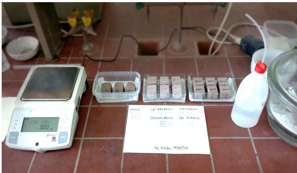
Εικόνα 4.42 Γενική διάταξη πειράματος ύγρυνσης-ξήρανσης μέσω τριχοειδούς αναρρίχησης.
