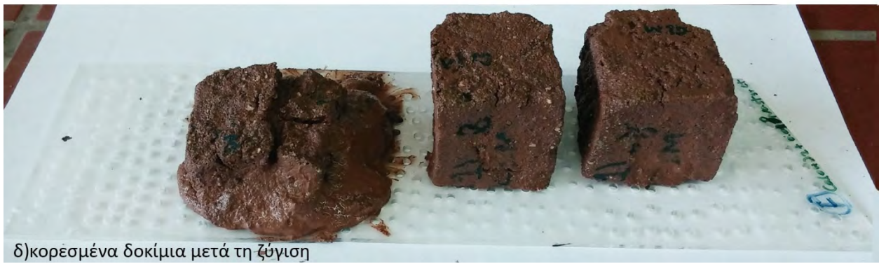
Εικόνα 5.19 Στάδια 1ου κύκλου ύγρυνσης-ξήρανσης μέσω τριχλωιδούς αναρρίχησης για το μη σταθεροποιημένο πηλοκονίαμα.
