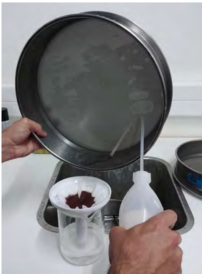
Εικόνα 4.10 Συγκράτηση υλικού από κόκκινο σε ειδικό φίλτρο με επίπλυση.
