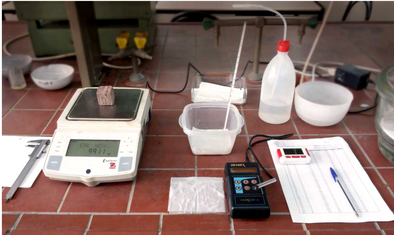
Εικόνα 4.41 Γενική διάταξη δοκιμής υδατοαπορρόφησης με τριχοειδή αναρρίχηση-ζύγιση δοκιμίου.
