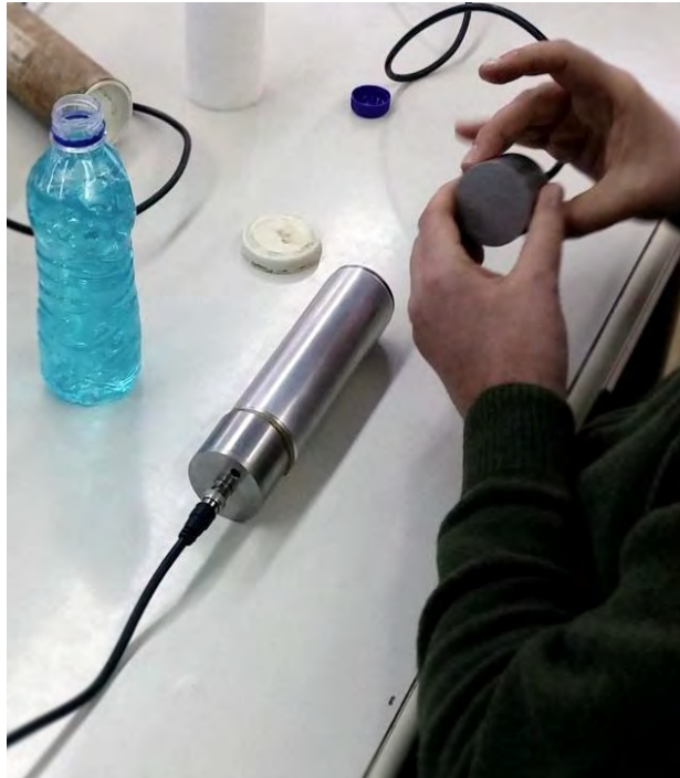
Εικόνα 4.35 Ράβδος βαθμονόμησης υπερηχοσκόπησης. Εικόνα 4.36 Μέτρηση ταχύτητας διάδοσης υπερήχων.
