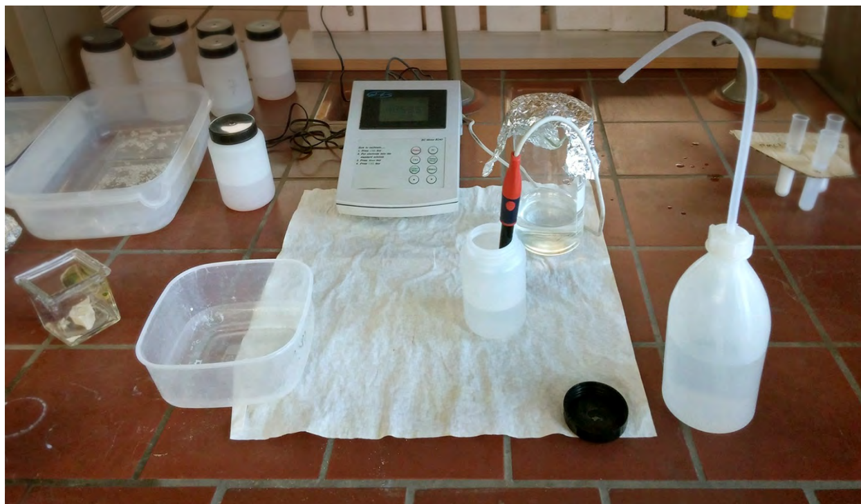
Εικόνα 4.11 Γενική διάταξη πειράματος αγωγιμομετρίας.
