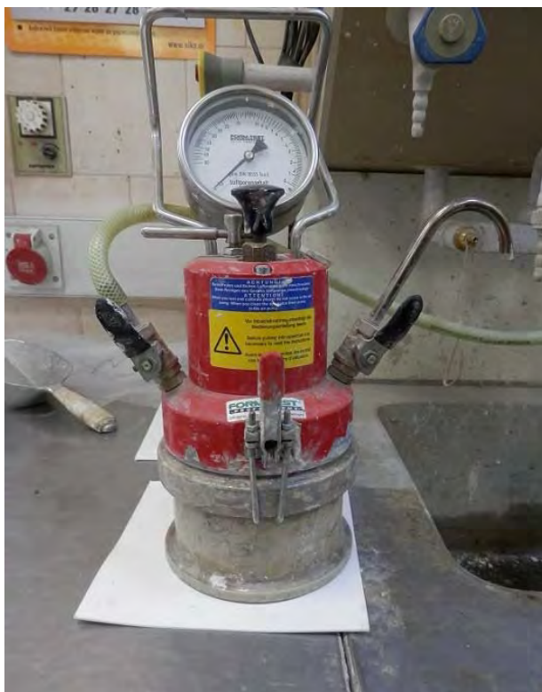
Εικόνα 4.20 Διάταξη με το δοχείο 1l κάτω και τον μετρητή πίεσης επάνω.
