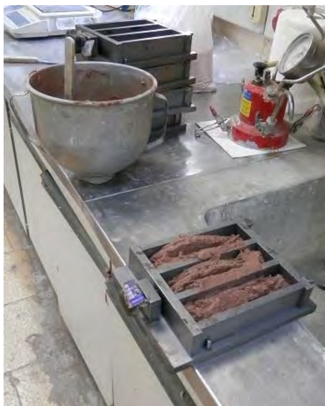
Εικόνα 4.24 Πρώτη στρώση πλήρωσης πριν τις κρούσεις.
