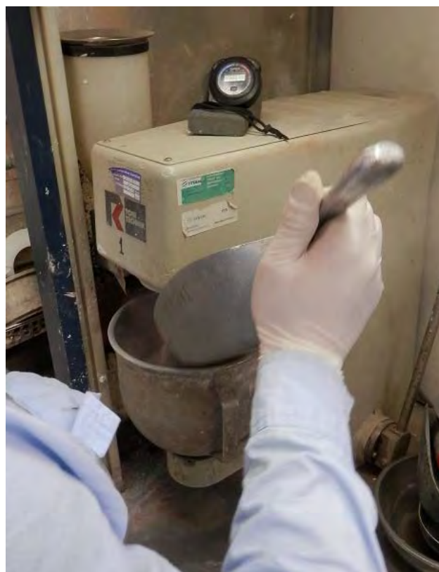
Εικόνα 4.16 Σταδιακή ρίψη μίγματος υλικών και ανάδευση σε ηλεκτρικό αναδευτήρα.
