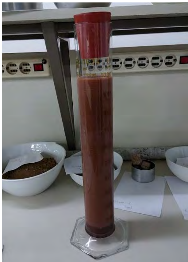
Εικόνα 4.8 Ογκομετρικός κύλινδρος με ειδικό πώμα πριν την ανατάραξη.
