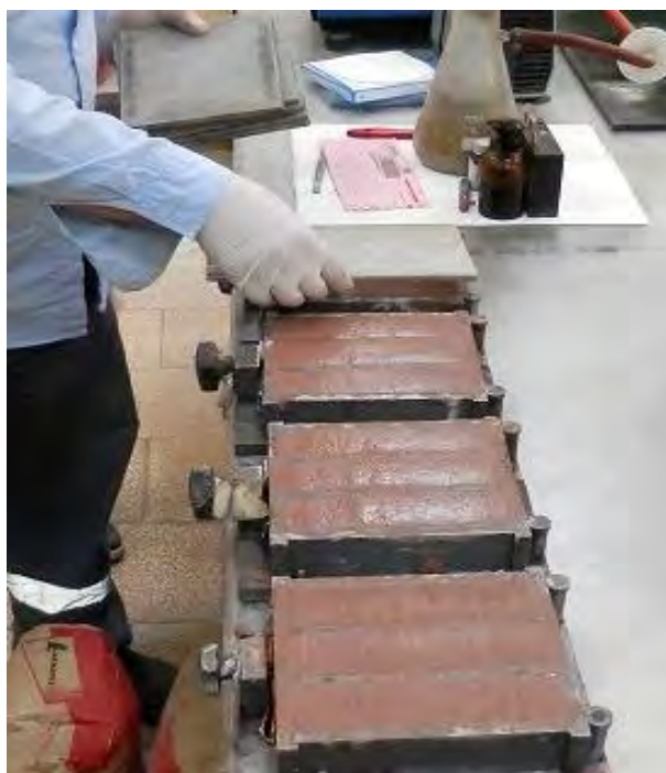
Εικόνα 4.25 Κάλυψη με γυάλινες πλάκες μετά τη διάστρωση. Εικόνα 4.26 Θάλαμος συντήρησης RH: 95%±5%.
