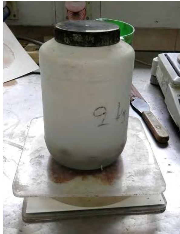
Εικόνα 4.22 Διάταξη με βάρος 2kg σε ηρεμία για 5 λεπτά.
