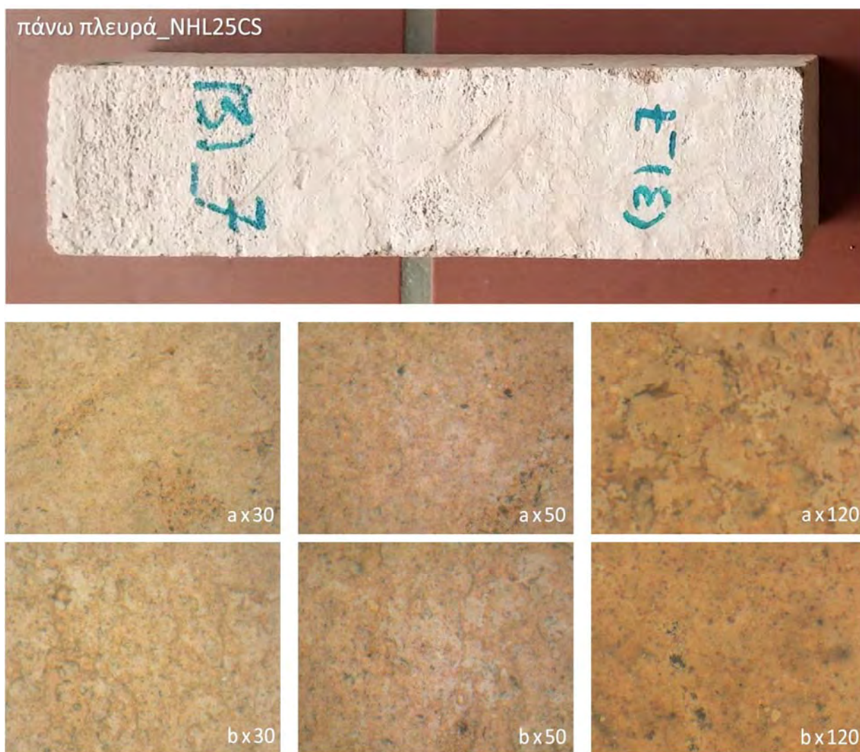
Εικόνα 5.7 Μορφολογία της πάνω πλευράς σταθεροποιημένου δοκιμίου με 25% φυσική υδραυλική άσβεστο.
