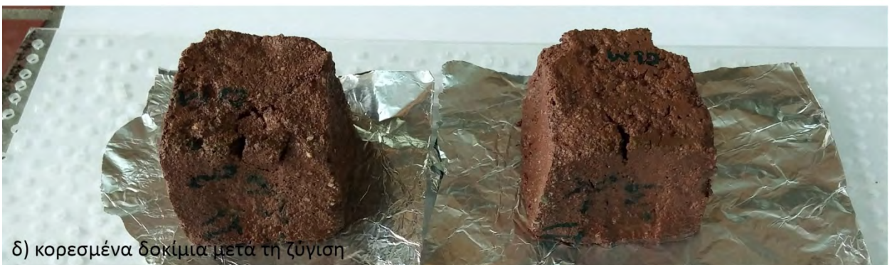
Εικόνα 5.20 Στάδια 2ου κύκλου ύγρυνσης-ξήρανσης μέσω τριχοειδούς αναρρίχησης για το μη σταθεροποιημένο πηλοκονίαμα.
