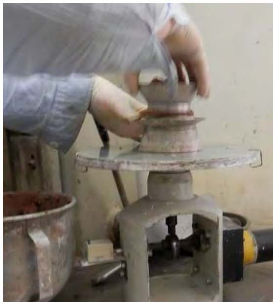
Εικόνα 4.17 Συσκευή και καλούπι εξάπλωσης.
