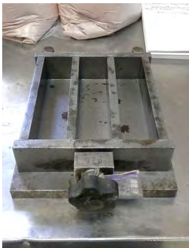
Εικόνα 4.23 Τρίδυμη μήτρα με κινητά τοιχώματα.
