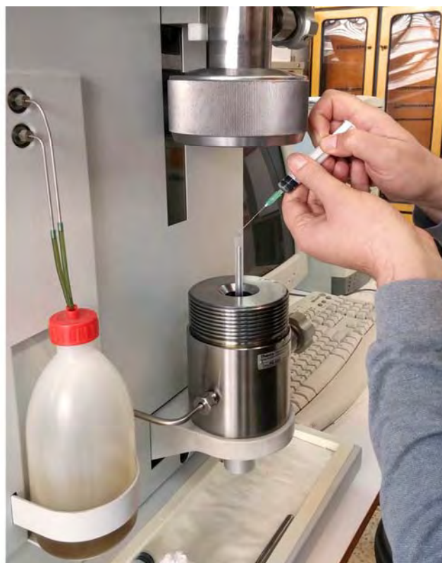
Εικόνα 4.31 Σφράγιση με λάδι του δειγματοφορέα.
