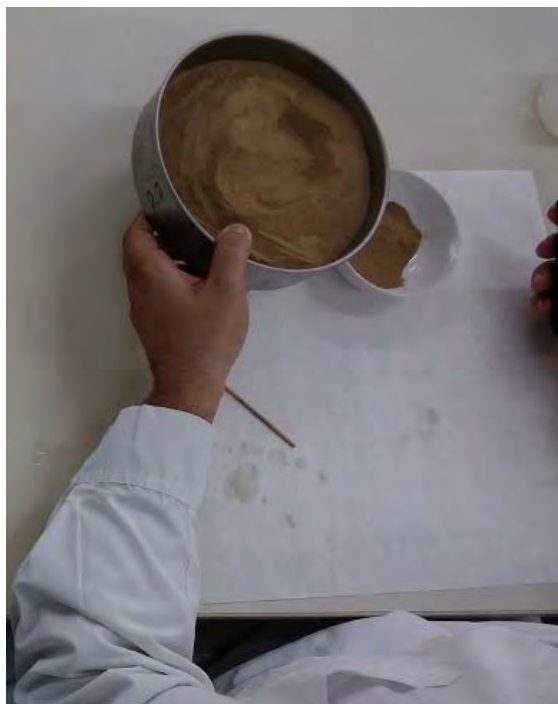
Εικόνα 4.5, Εικόνα 4.6 Προετοιμασία και κυλίνδρωση, η σύγκριση γίνεται με μεταλλική ράβδο διαμέτρου 3mm.
