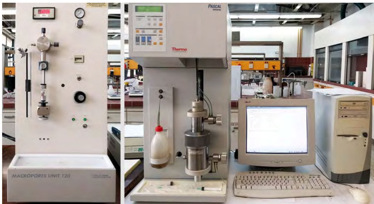
Εικόνα 4.29 Γενική διάταξη Πορομετρίας με δύο τμήματα για τη μέτρηση των μεγάλων και μικρών πόρων.
