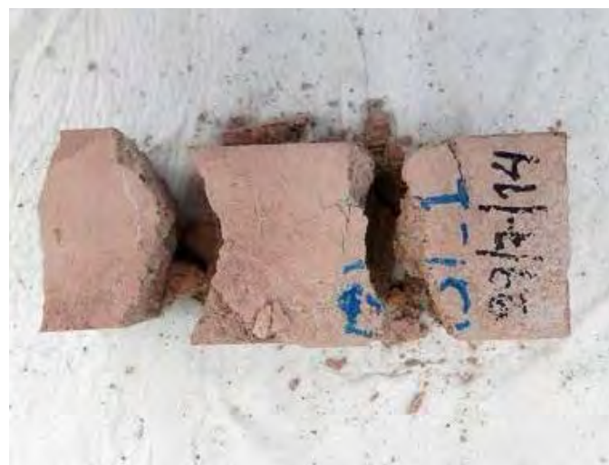
Εικόνα 4.40 Εικόνα δοκιμίου NHL25CS μετά τη θλίψη.
