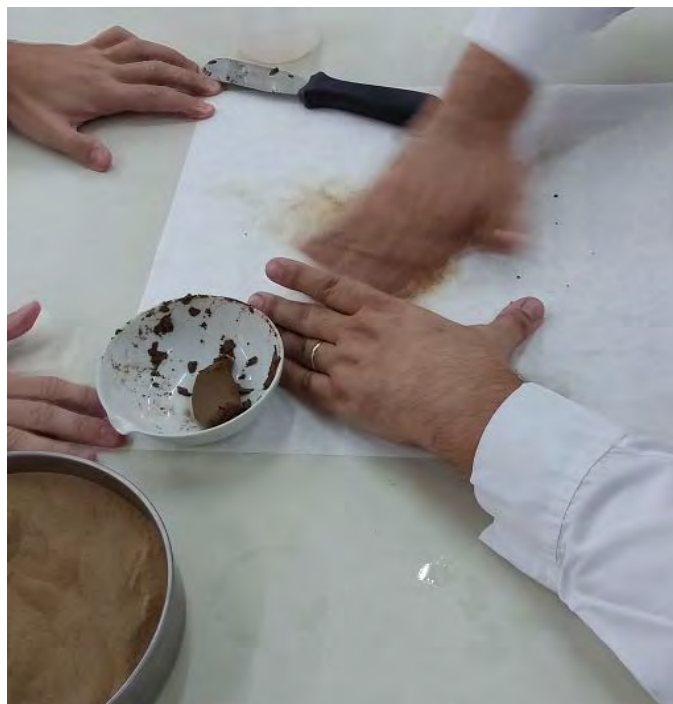
Εικόνα 4.5, Εικόνα 4.6 Προετοιμασία και κυλίνδρωση, η σύγκριση γίνεται με μεταλλική ράβδο διαμέτρου 3mm.
