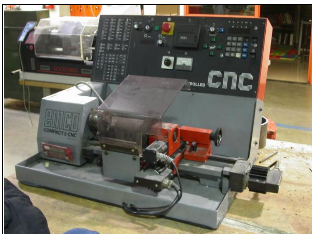
Εικόνα 3: Ο τόρνος Emco Compact 5 CNC του εργαστηρίου ο οποίος ανακατασκευάστηκε
