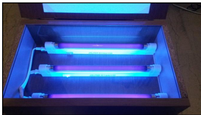
Εικόνα 39: Θάλαμος για ελεγχόμενη έκθεση σε υπέρυθη ακτινοβολία
