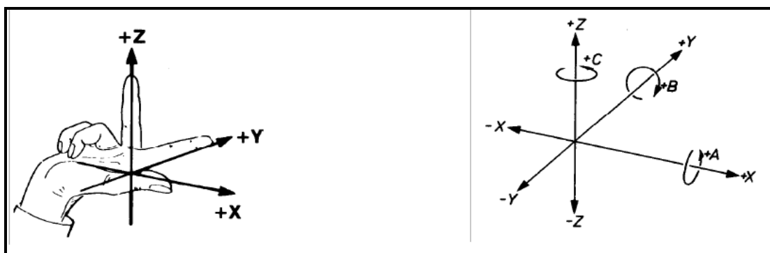
Εικόνα 1: Κανόνας του δεξιού χεριού και σύμβολα ονομασίας γραμμικών και περιστροφικών αξόνων
