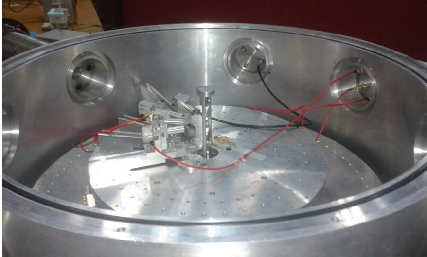
Εικόνα 3.3: Το εσωτερικό του γωνιομετρικού θαλάμου
