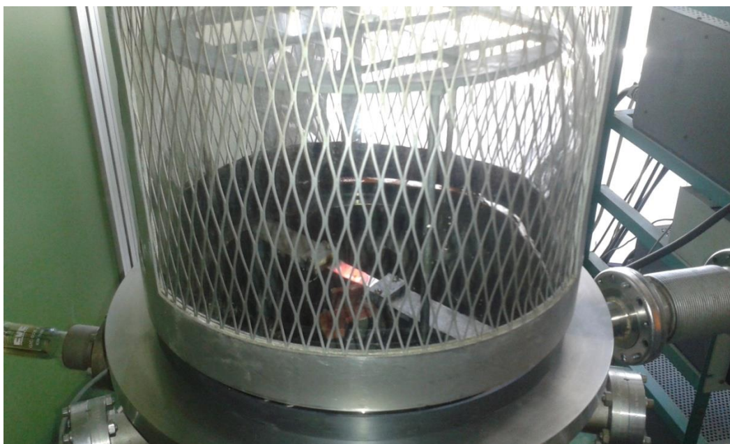
Εικόνα 3.5: Ο θάλαμος του εξαχνωτήρα του εργαστηρίου σε κενό. Επάνω στο πυρακτωμένο μέταλλο βρίσκεται ο χρυσός προς εξάχνωση.
