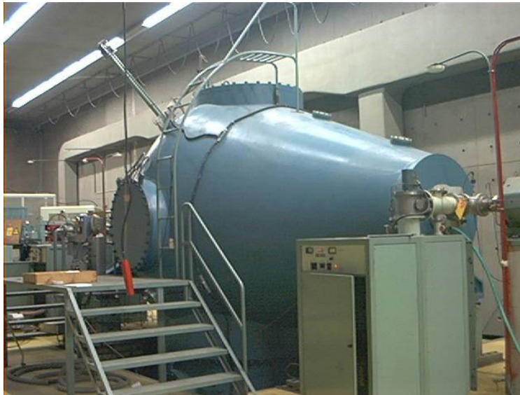
Εικόνα 3.1: Η κεντρική δεξαμενή του επιταχυντή
