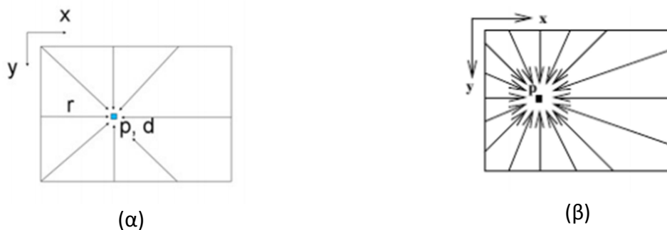
Εικόνα 1.8: (α) Οχτώ (β) δεκαέξι ελάχιστες σε κόστος διαδρομές κατά τη διαδικασία συσσωμάτωσης του κόστους συσχέτισης
