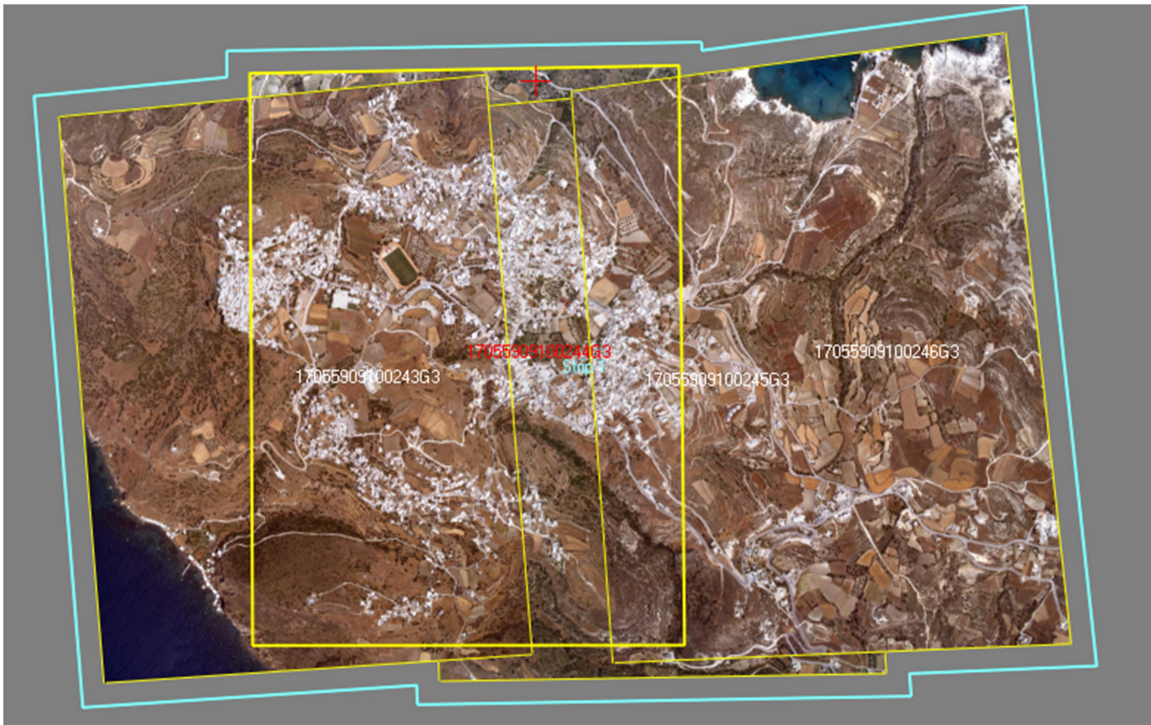
Εικόνα 2.4: Συνορθωμένο μπλοκ εικόνων στο περιβάλλον του λογισμικού Photomod
