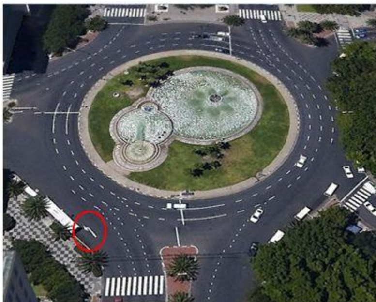
Εικόνα 3.13 Κυκλικός Κόμβος Τριών Λωρίδων (Multi-Lane Roundabout) ( http://k53.gavinhoole.ws ).
